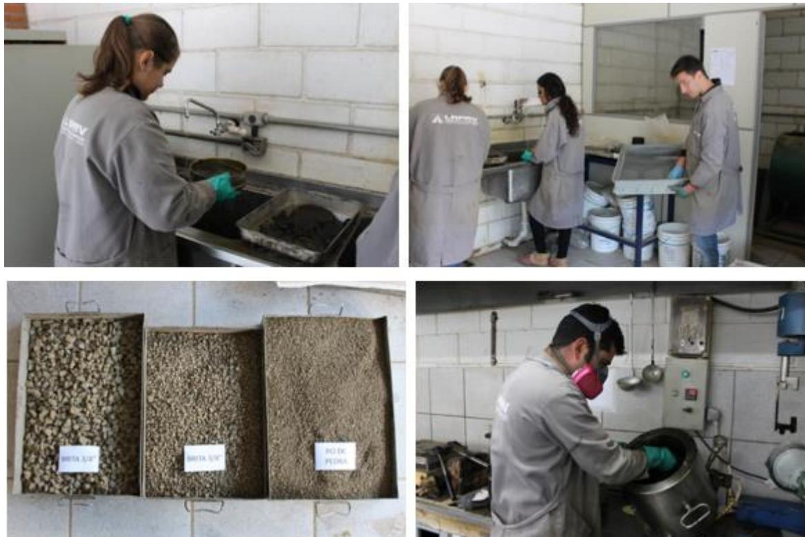
Figura 29 – Rotina do laboratório (lavagem e peneiramento de agregados)
