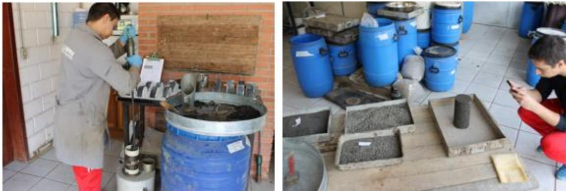
Figura 26 Moldagem de corpo de prova para ensaio triaxial
