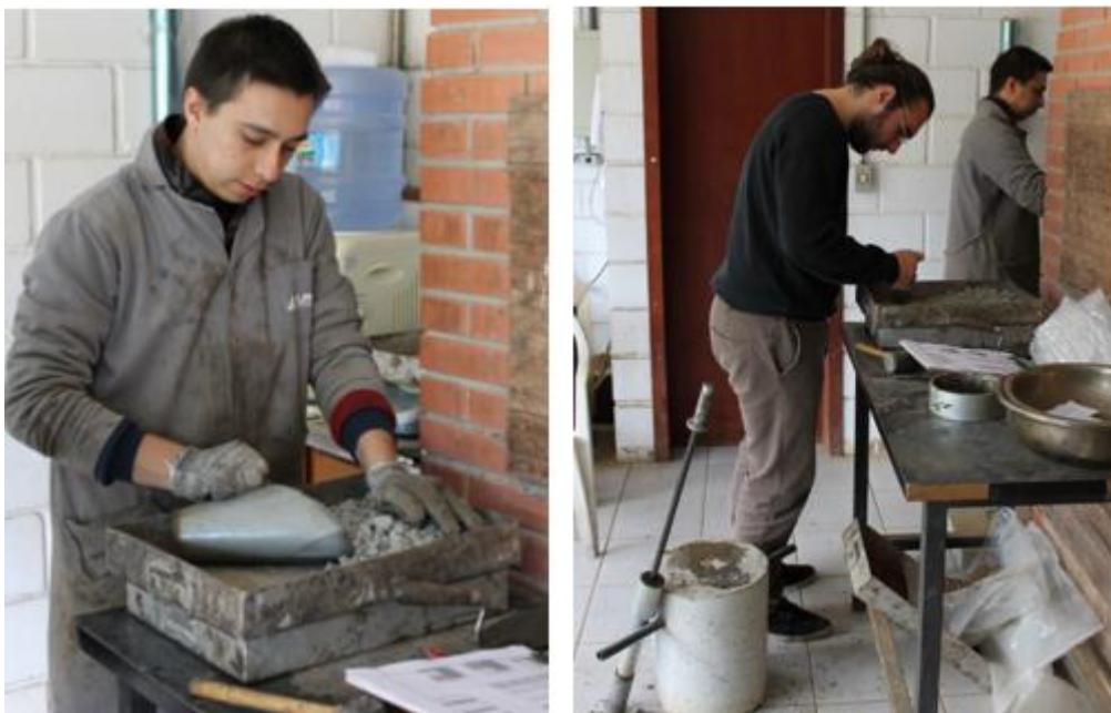
Figura 27 – Utilização de misturas com fresado asfáltico para verificar módulo resiliente
