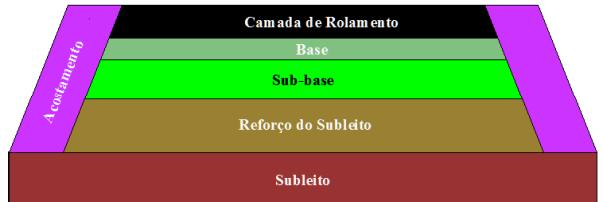
Figura: Esquema simplificado de um pavimento.
