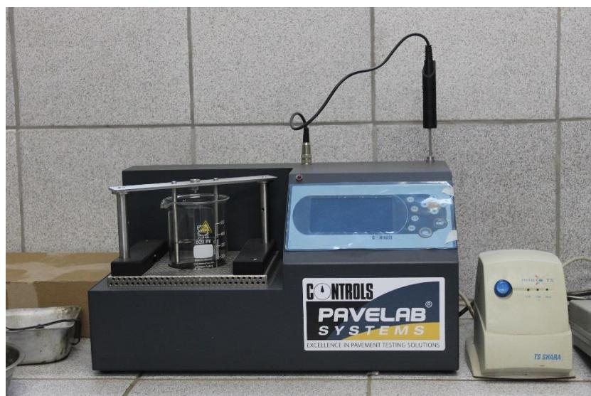
Figura 24 – Medidor de Ponto de amolecimento eletrônico
