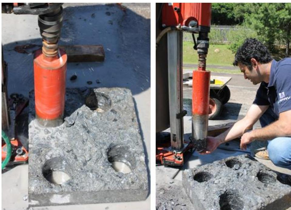
Figura 94 – Extração de corpos de prova em placas de concreto asfáltico
