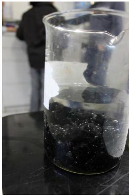
Figura 28 – Ensaio de adesividade em andamento
