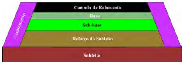
Figura: Esquema simplificado de um pavimento.
