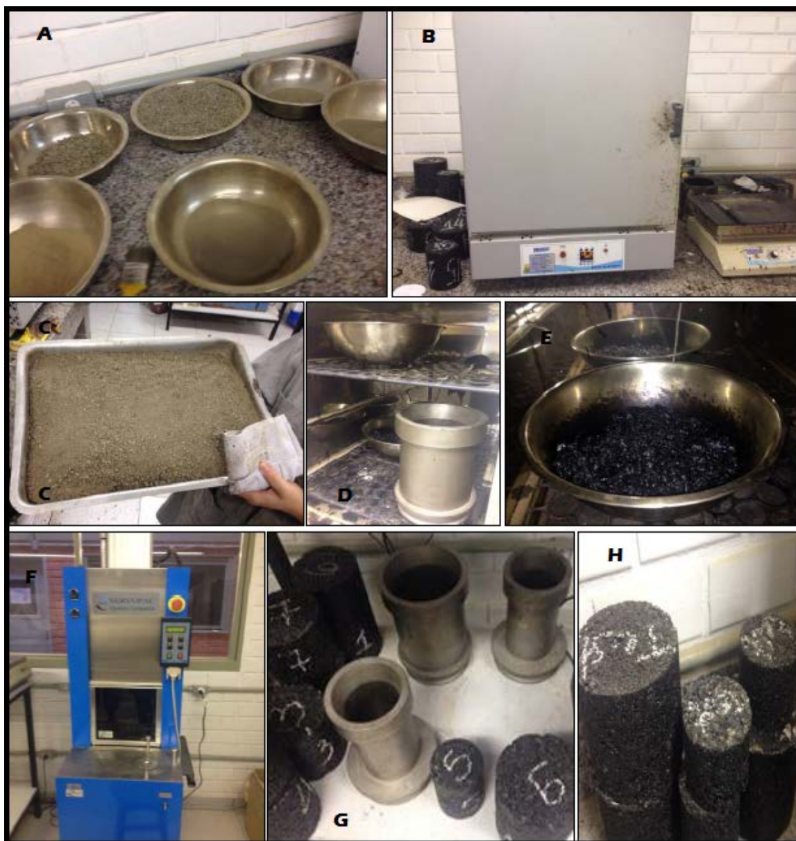
Figura 50: Etapas da preparação das misturas asfálticas. A: Separação granulométrica através do peneiramento. B: Estufa utilizada na secagem, aquecimento de moldes, envelhecimento da mistura e aquecimento do ligante. C: Material seco e aquecido para moldagem. D: Molde sendo aquecido e mistura asfáltica sendo envelhecida. E: Massa asfáltica em processo de envelhecimento na temperatura de compactação. F: Compactador Giratório – CGS. G: Moldes utilizados na compactação. H: CPs moldados no CGS.
