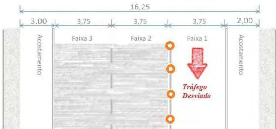
Figura 83 – Desvio do tráfego da rodovia para a realização dos testes de pesagem
