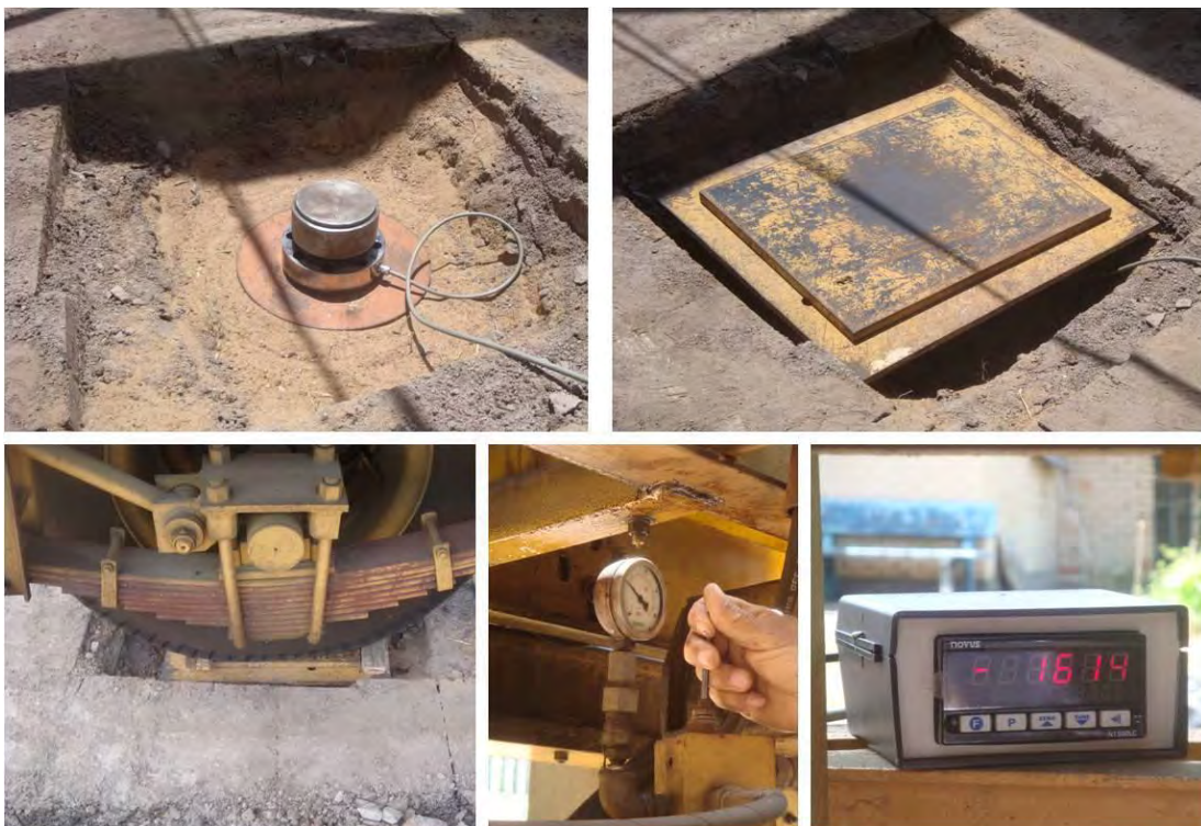
Figura 43 - Processo de calibração da unidade hidráulica do simulador de tráfego
