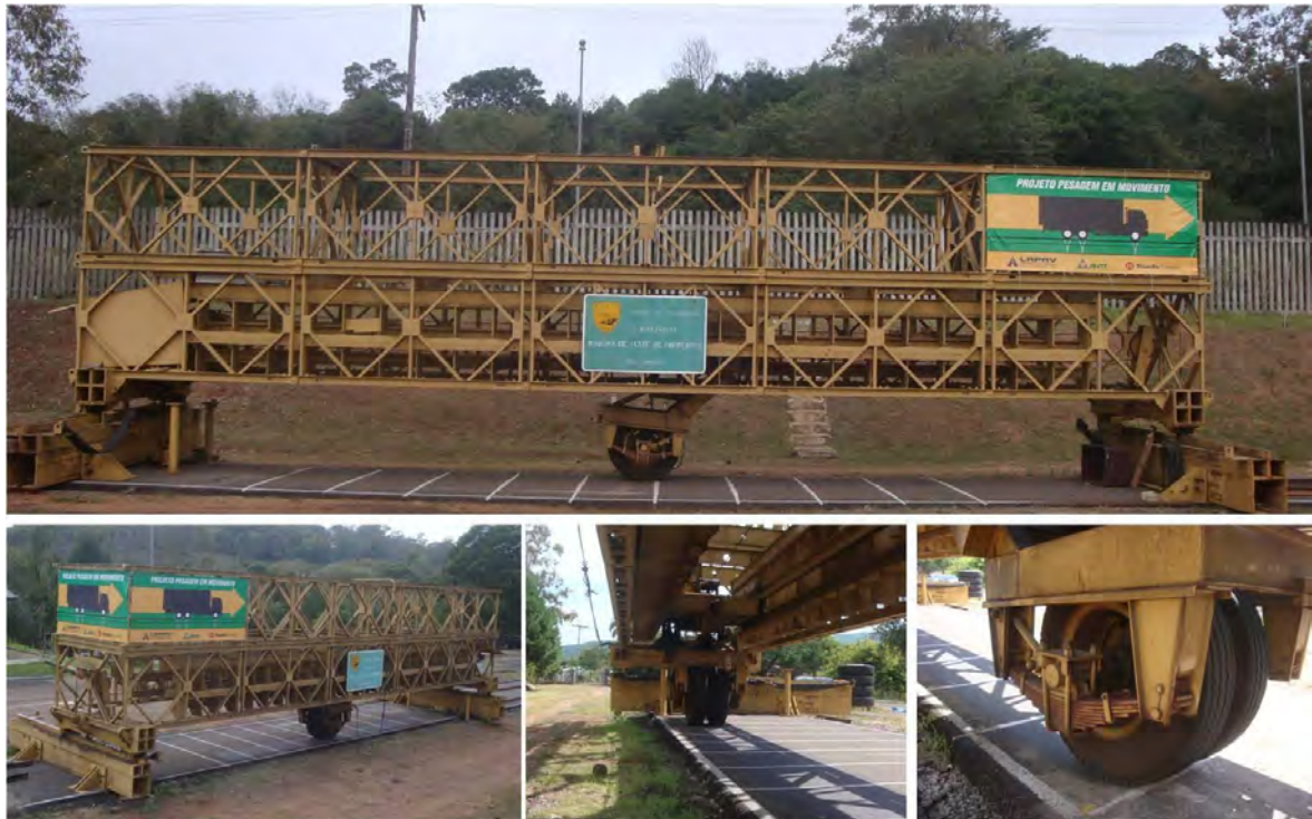
Figura 20 - Visão geral e detalhes do Simulador de Tráfego LAPAV/UFRGS
