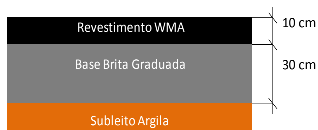
Figura 19 - Seção transversal da pista experimental
