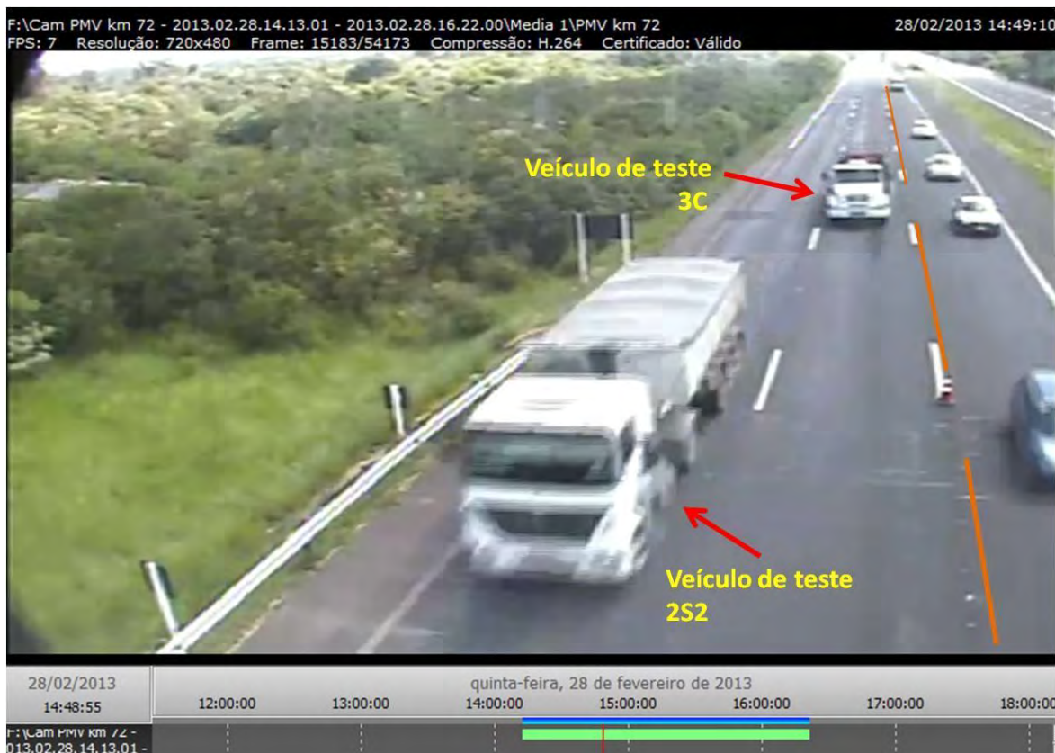
Figura 87 – Aproximação simultânea dos dois veículos de teste para pesagem em movimento na velocidade diretriz da rodovia
