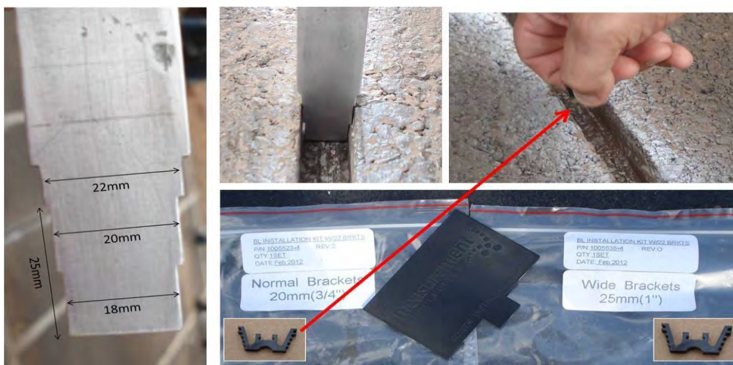
Figura 67 – Gabarito para conferência das medidas dos cortes executados e espaçadores com dois tamanhos distintos (20mm e 25mm)
