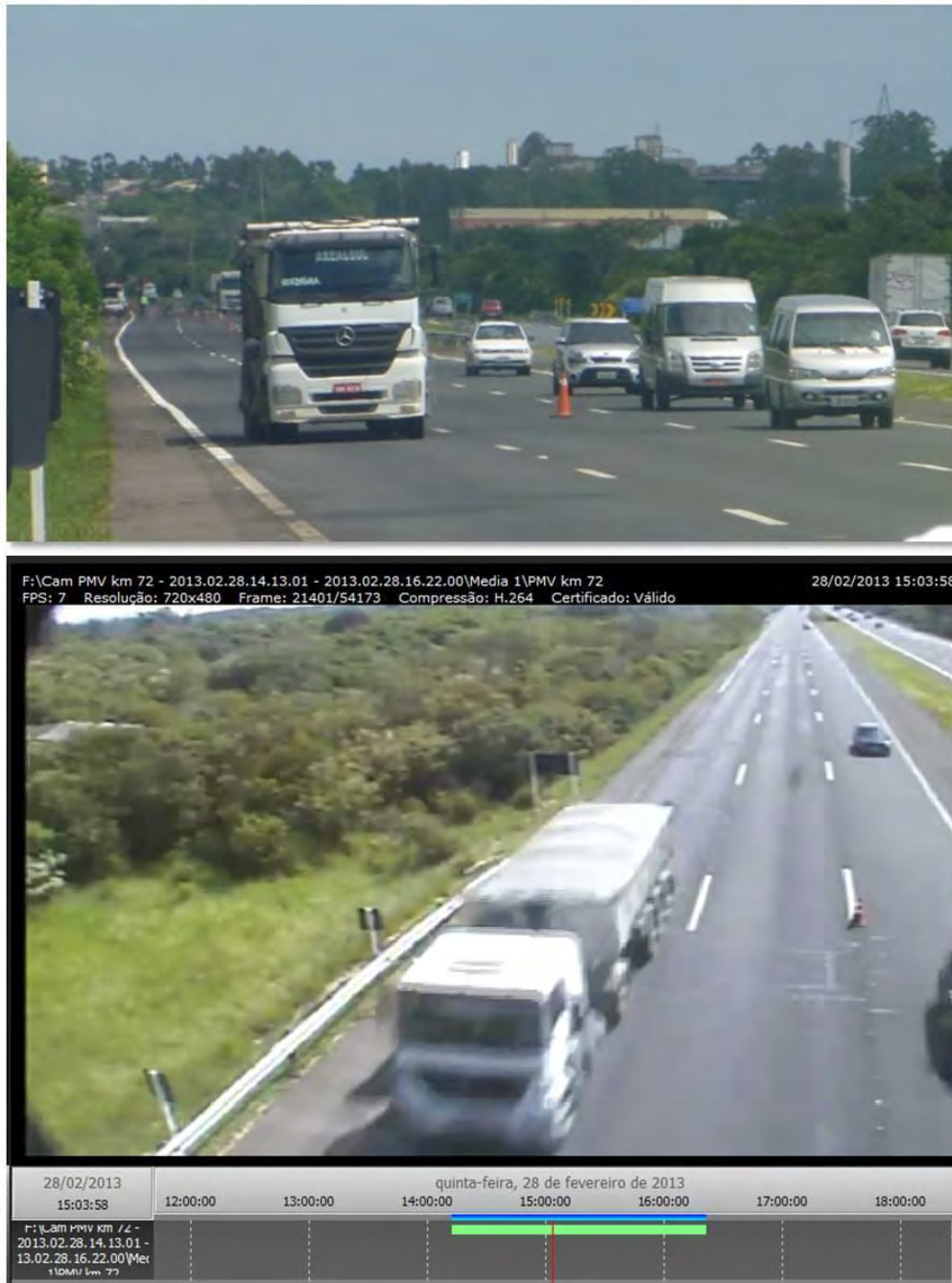
Figura 86 – Aproximação e pesagem do Veículo 2 (2S3) na seção de teste
