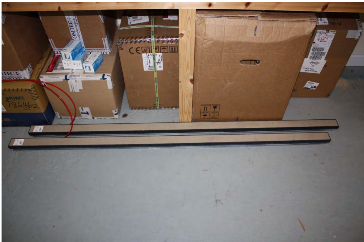
Figura 12 - Sensor Lineas da marca Kistler; sensores de quartzo piezoelétrico
