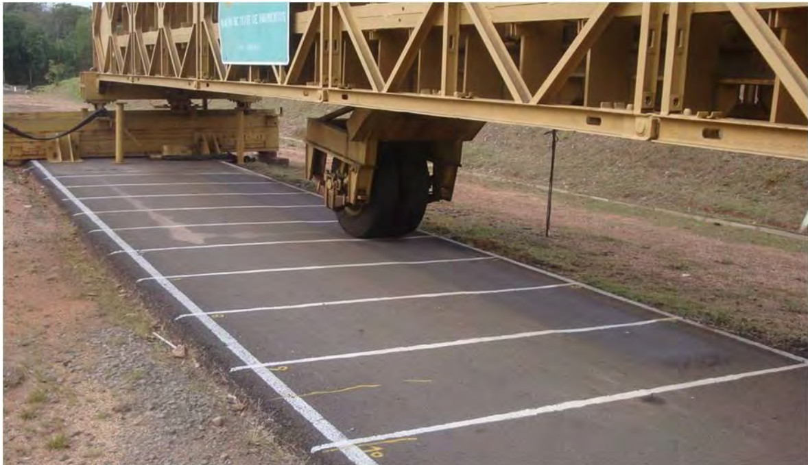
Figura 29 – Pavimento limpo para demarcação dos locais de corte
