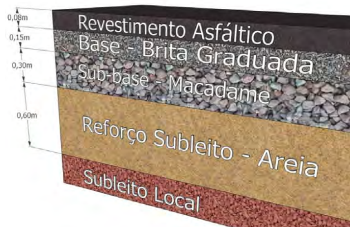
Figura 54 – Estrutura do pavimento dos trechos experimentais da BR 290/RS
