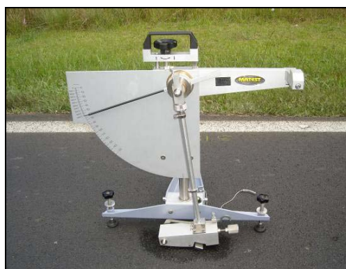
Figura 18: Execução do ensaio com o Pêndulo Britânico.
