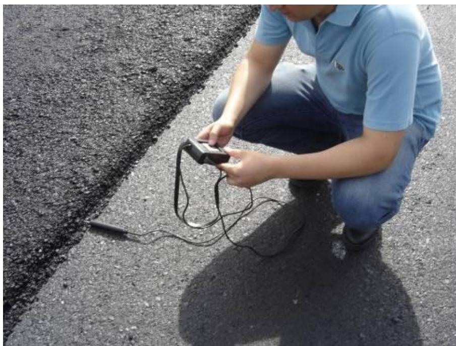
Figura 28. Controle da temperatura da massa antes da compactação
