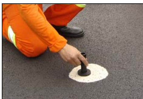
Figura 16: Exemplo de etapa do Ensaio de Mancha de Areia.
