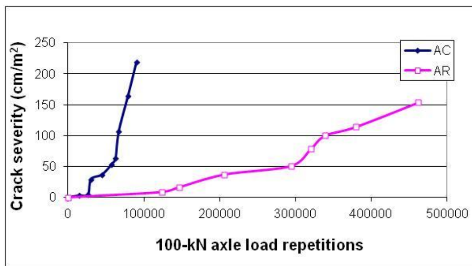
Figura 6. Exemplo de evolução do trincamento em pavimento experimental, adotando-se o critério de Densidade de Trincamento
