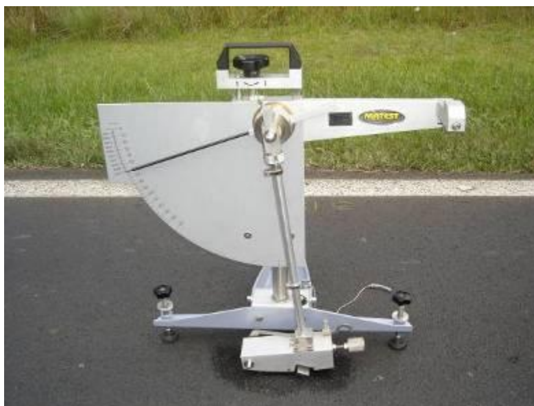
Figura 9. Execução do ensaio com o Pêndulo Britânico
