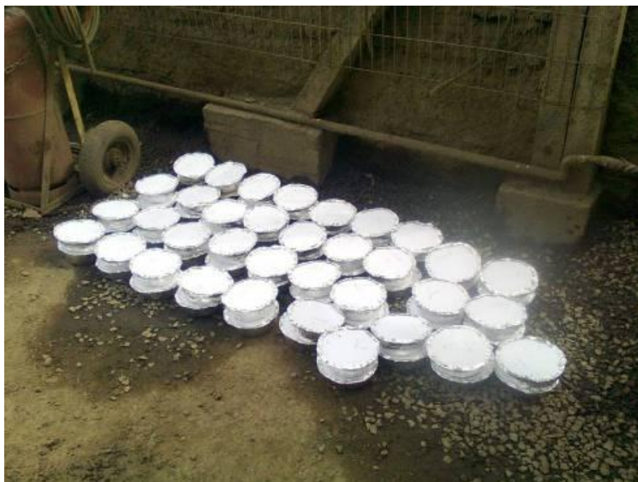
Figura 26. Coleta de massa asfáltica para ensaios em laboratório
