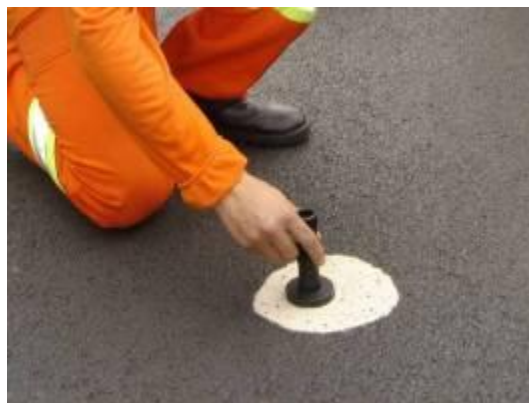
Figura 10. Ensaio de Mancha de Areia
