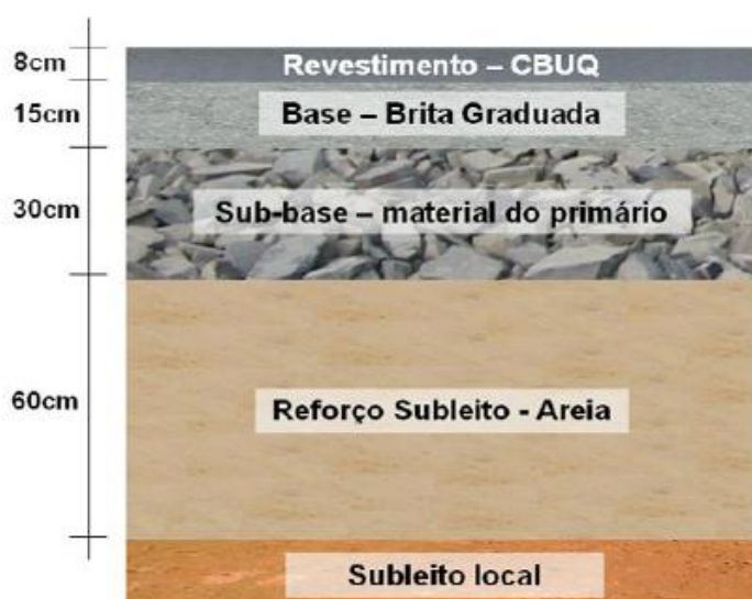
Figura 11. Estrutura do pavimento da BR 290/RS
