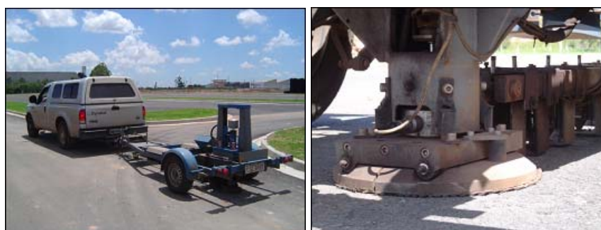
Figura 10: Aspectos de um Falling Weight Deflectometer (FWD).
