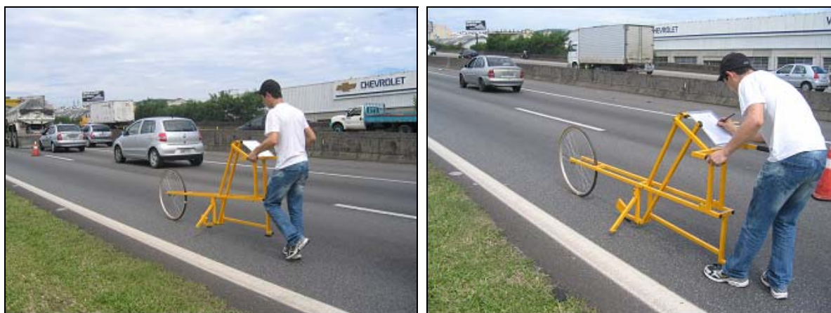
Figura 12: Equipamento para avaliação da irregularidade usando instrumentação de baixo custo (MERLIN)
