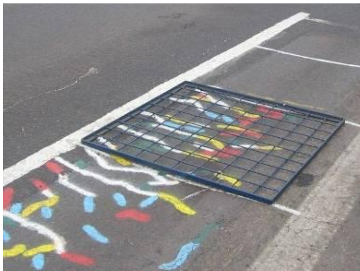
Figura 7. Mapeamento das trincas com auxílio de grade metálica. As cores indicam a ordem de surgimento das trincas.
