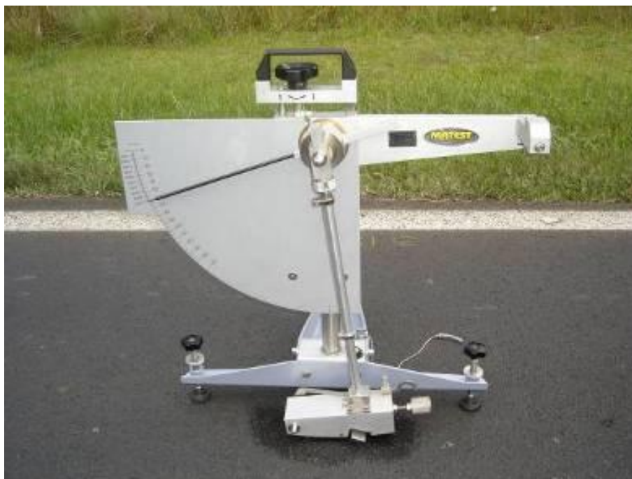
Figura 9. Execução do ensaio com o Pêndulo Britânico
