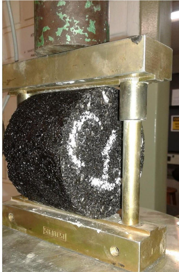
Figura 36 – Corpo-de-prova submetido ao ensaio de RT
