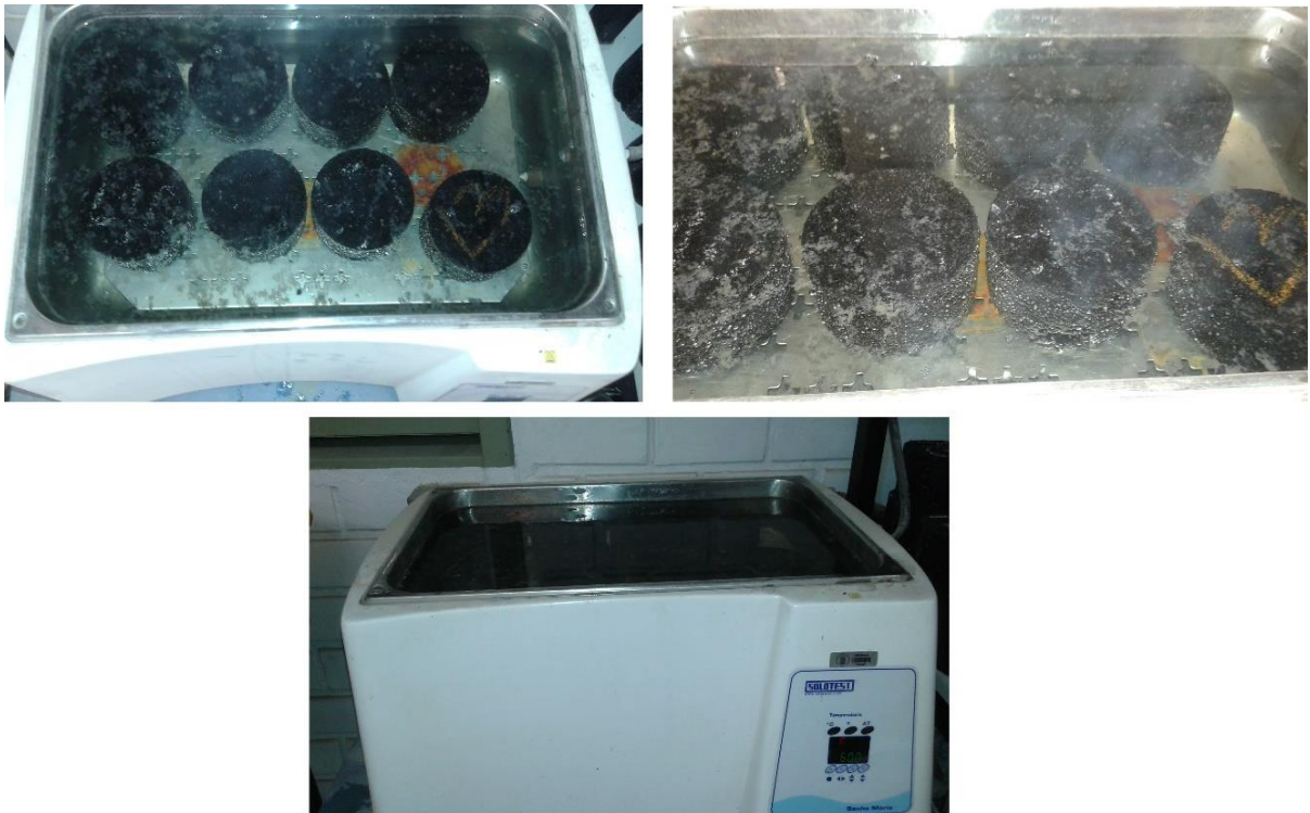
Figura 40 – Amostras imersas em banho de água destilada à temperatura de 60°C
