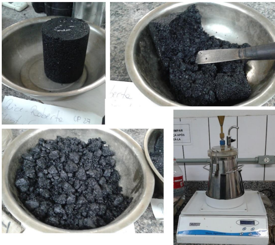
Figura 34 – Realização do ensaio de densidade da mistura através do método de Rice
