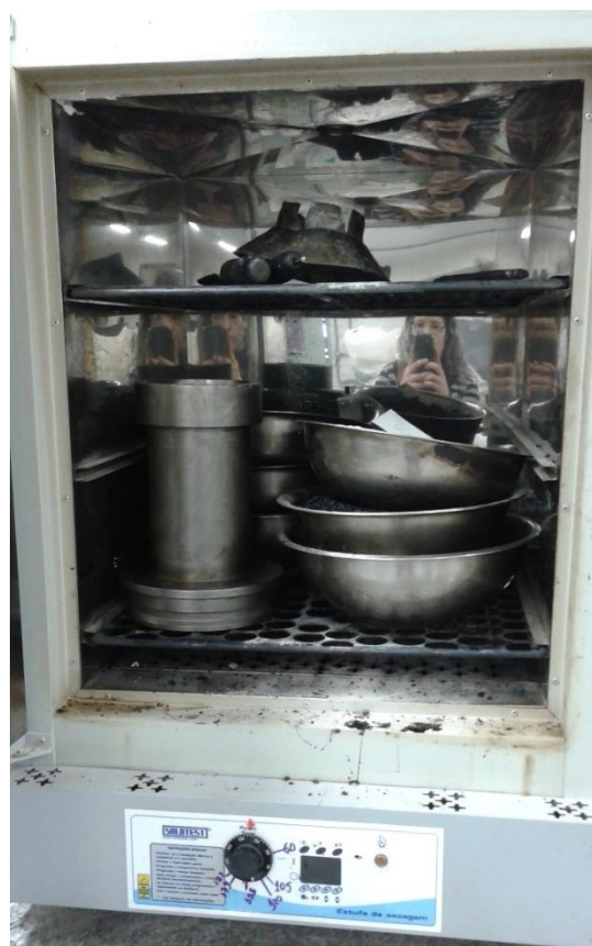
Figura 33 – Simulação de envelhecimento de curto prazo em estufa
