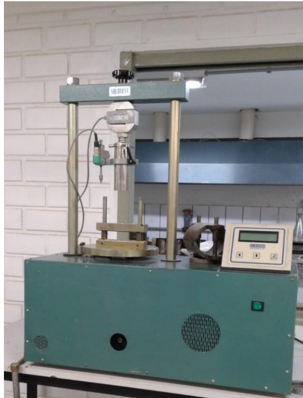
Figura 18 – Prensa utilizada para realização do ensaio de RT
