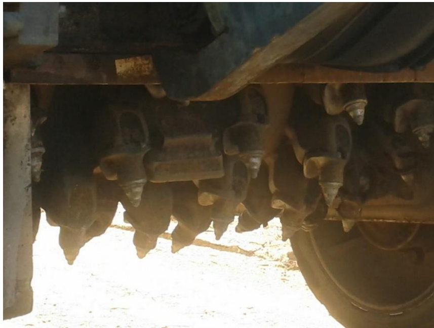
Figura 25 – Detalhe do cilindro de corte da fresadora Wirtgen W 100
