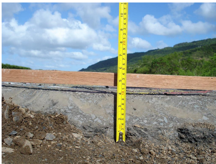
Figura 30 - Investigação da Estrutura Existente - determinação da espessura de capa
