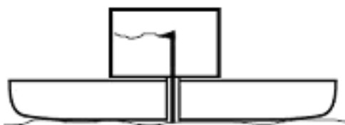
Figura 2.1 – Desenho esquemático do equipamento conhecido como “Viagraph”. Fonte: Gillespie (1992).
