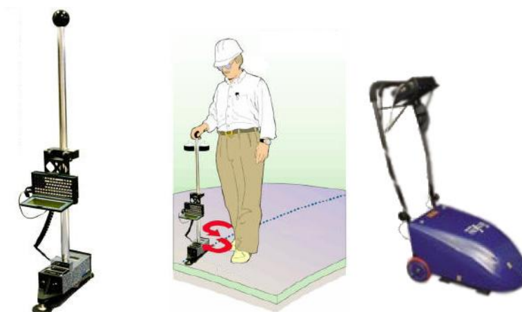
Figura 2.10 – Fotografia do Dipstick (esq.); desenho esquemático do Dipstick em operação (centro); e fotografia do perfilômetro Walking Profiler (dir.). Fontes: Face Companies (2005) e Arrb Group Ltd (2005).
