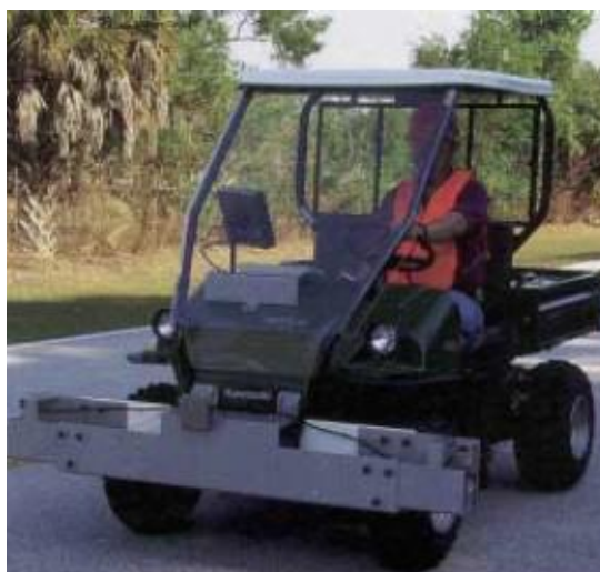
Figura 2.13 – Fotografia de um perfilômetro inercial laser portátil. Fonte: Perera e Kohn (2002a).
