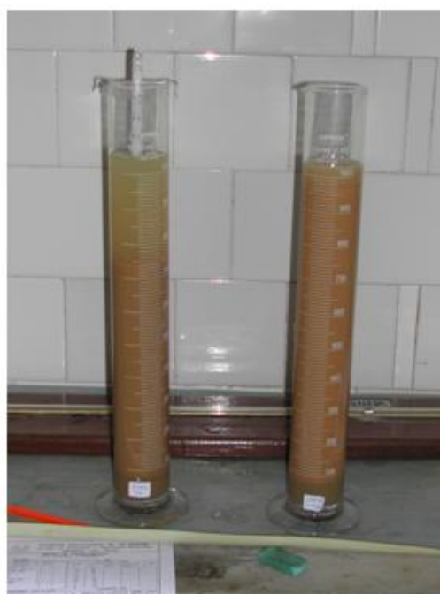
Figura 20 - Ensaio de peneiramento (esquerda) e ensaio de sedimentação (direita).
