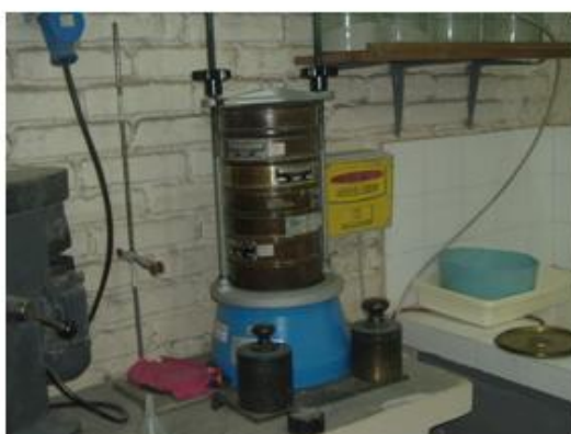
Figura 20 - Ensaio de peneiramento (esquerda) e ensaio de sedimentação (direita).
