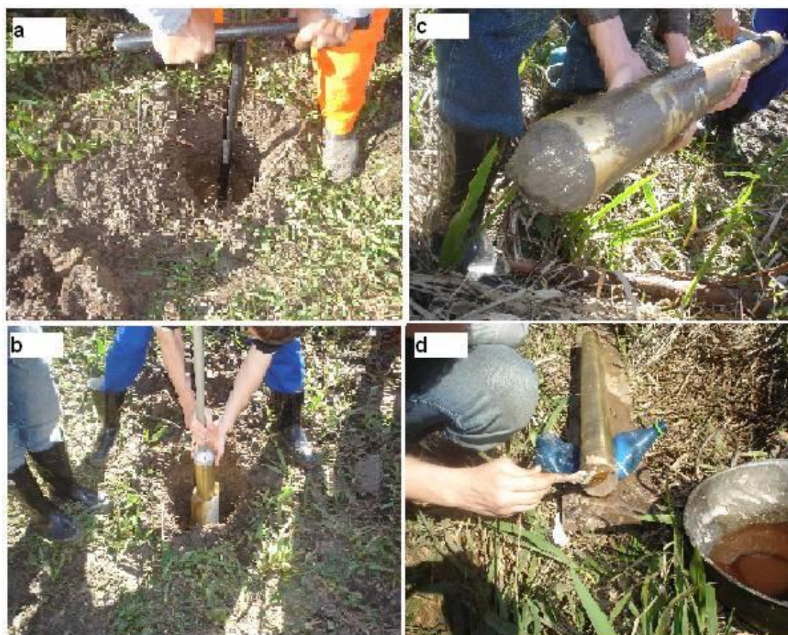
Figura 12 – Execução da retirada de amostras indeformadas.
