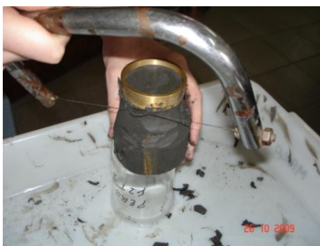
Figura 27: Moldagem dos corpos de prova para ensaios de adensamento.
