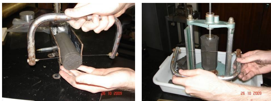
Figura 34. Ajuste da altura do corpo de prova (esquerda) e talhagem no torno (direita).
