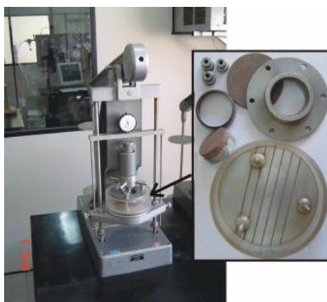
Figura 26: Prensa utilizada para a execução dos ensaios de compressão confinada e detalhe da câmara de compressão confinada (desmontada) (Silveira, 2005).
