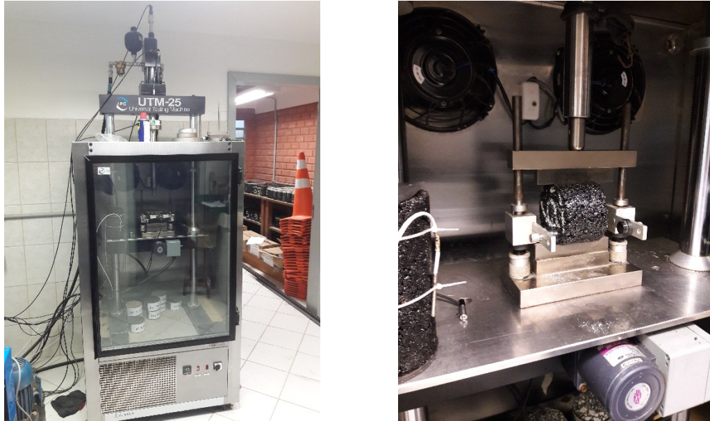
Figura 13 - Ensaio de RT realizado no equipamento UTM-25
