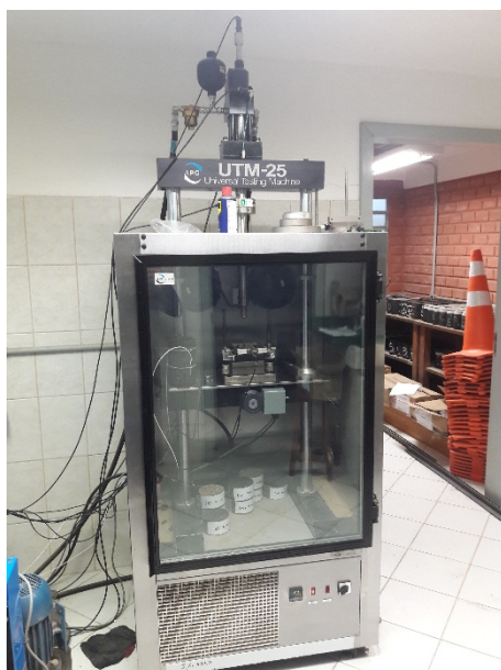
Figura 12 - Ensaio de MR realizado no equipamento UTM-25
