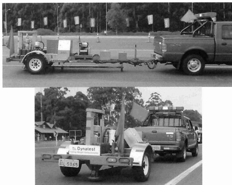
Figura 1 – Equipamento FWD utilizado nos levantamentos (foto catálogo).
