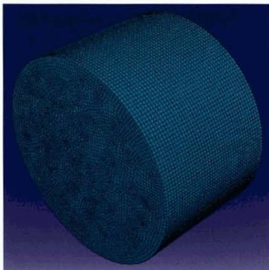
Figura 20 – Corpo-de-prova Marshal com uma malha composta por 158040 elementos.
