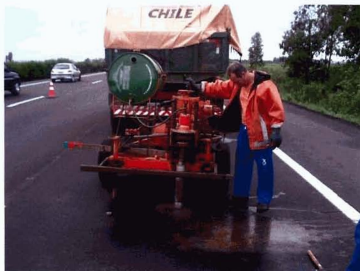
Figura 36 – Extração de corpo-de-prova de pista
