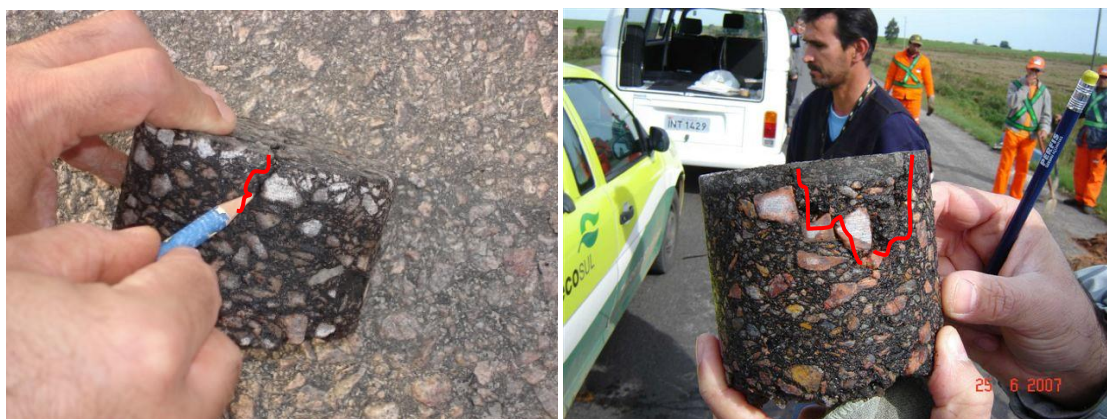
Figura 54: Trincamentos de cima para baixo em amostras extraídas na BR-116/RS, trecho Camaquã-Pelotas, Observa-se segregação de agregados na mistura
