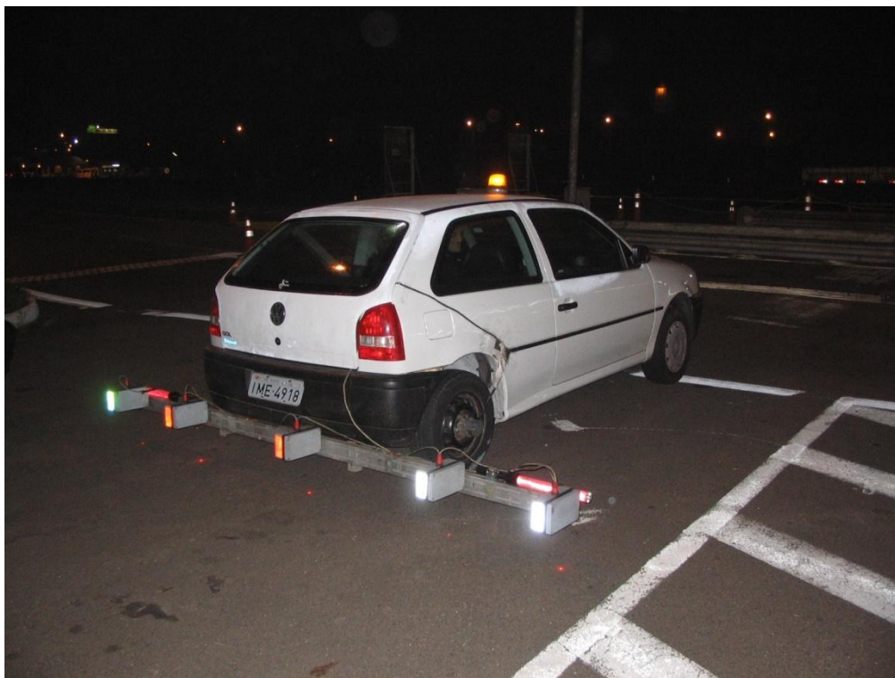
Figura 63: Perfilômetro a laser em levantamento ocorrido na rodovia BR-290/RS
