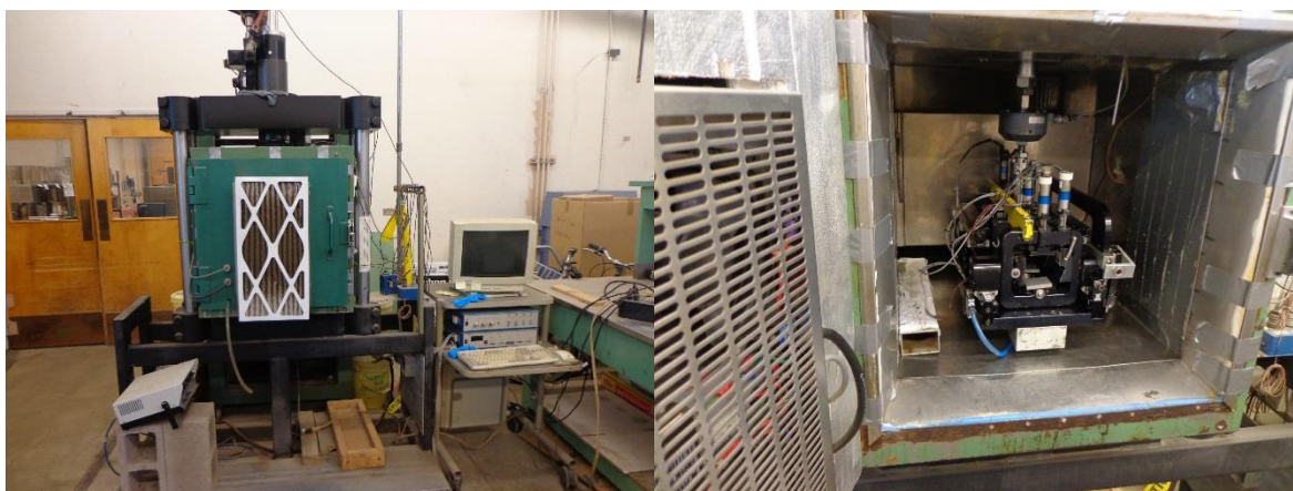
Figura 156: Primeiro equipamento montado para realização de ensaios de fadiga à flexão em quatro pontos elaborado pelo prof. Monismith - UCBerkeley.
