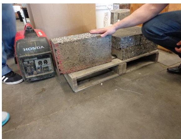
Figura 151: Placas de mistura asfáltica extraídas de campo - UC Berkeley.
