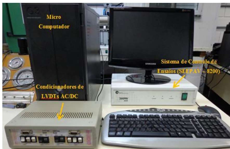
Figura 73: Sistema de aquisição e controle de dados do equipamento de ensaio de fadiga por compressão diametral.
