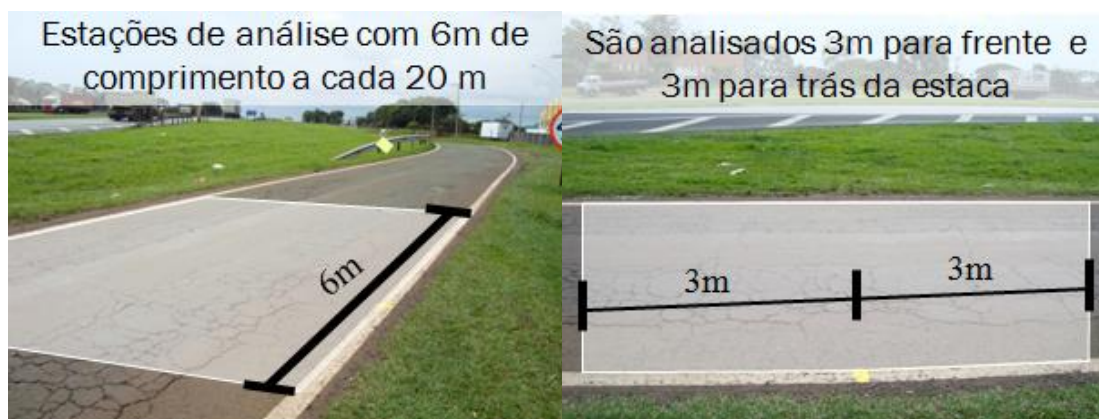
Figura 86: Demarcação no pavimento das superfícies de avaliação.
