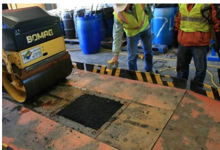
Figura 38: Compactação das placas de misturas asfálticas utilizando rolo compactador, Universidade da Califórnia.
