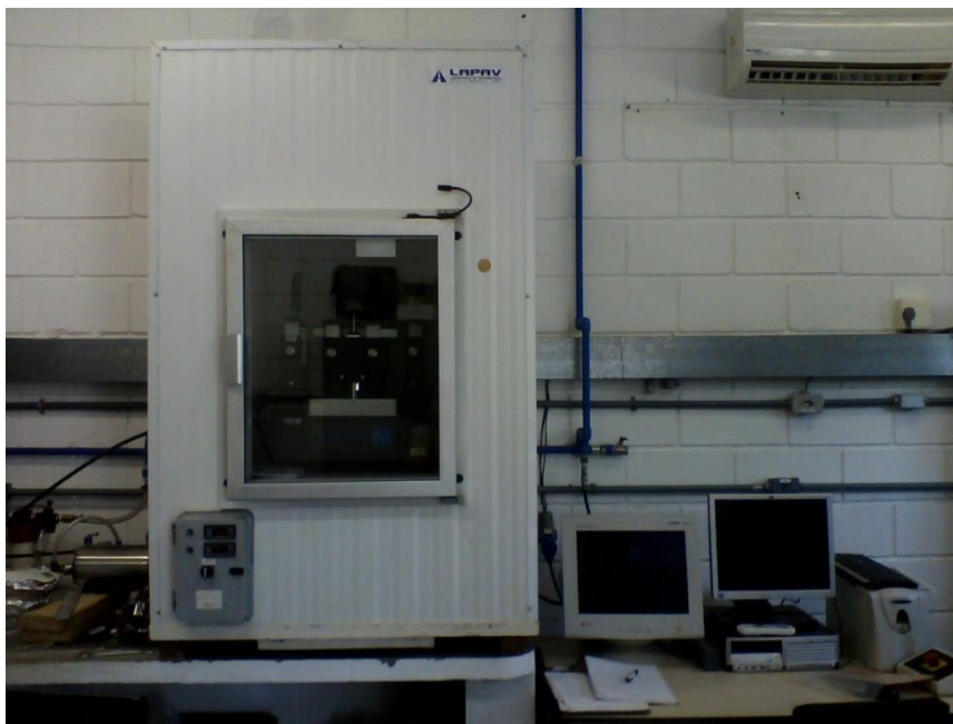
Figura 24: Câmara climática utilizada para realização do ensaio de flexão em viga quatro pontos.
