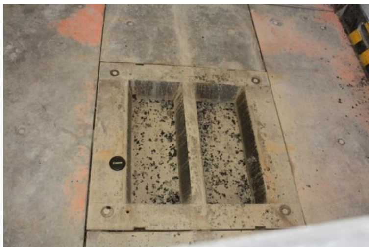
Figura 37: Detalhe do molde empregado pela Universidade da Califórnia para confecção de quatro vigas, sendo obtidas duas amostras por vão.
