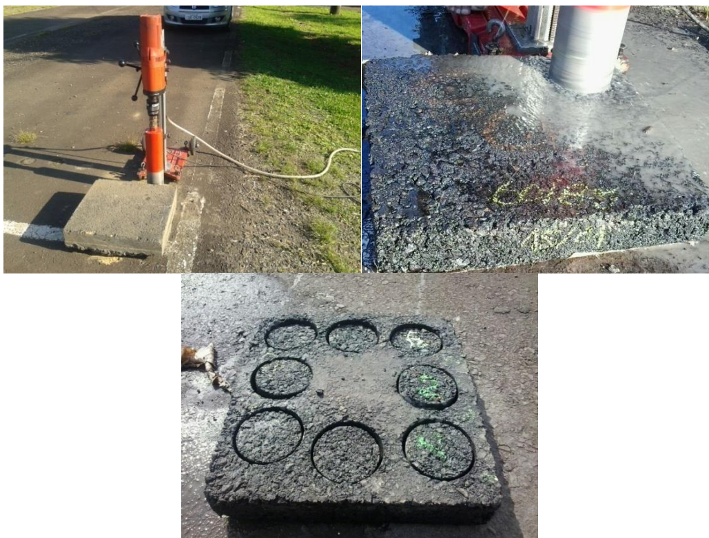
Figura 76: Extração de corpos de prova cilíndricos de placas moldadas na usina de asfalto.
