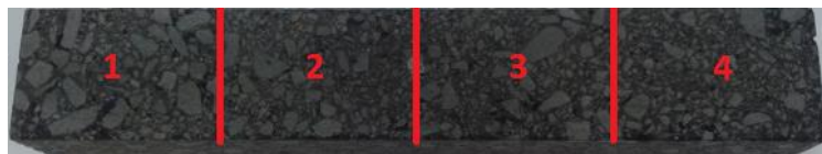
Figura 95: Vigota dividida em quatro partes para ensaio de densidade aparente.
