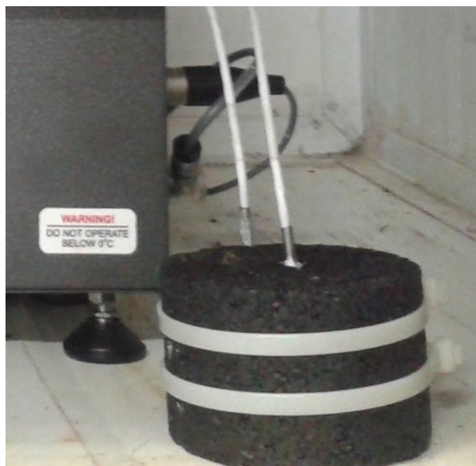
Figura 35: Corpo de prova modelo para a realização das leituras de temperatura interna e de superfície durante a execução do ensaio.
