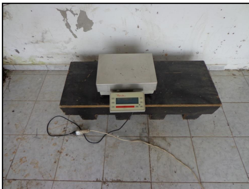
Figura 55: Balança eletrônica utilizada para pesar a mistura asfáltica e, assim, controlar a compactação das placas em campo.
