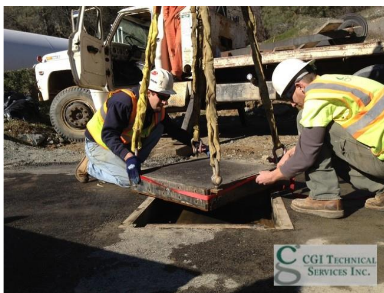
Figura 40: Sistema utilizado para a retirada das placas de misturas asfálticas moldadas em campo, Universidade da Califórnia.
