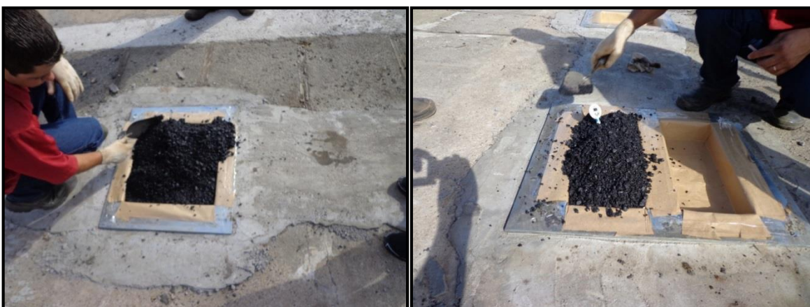
Figura 57: Processo de preenchimento dos moldes metálicos e verificação da temperatura de compactação da mistura asfáltica.
