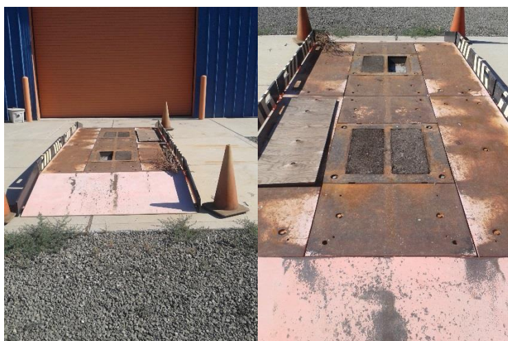
Figura 147: Pista de moldagem de placas de mistura asfáltica - ATIRC/UCDavis.
