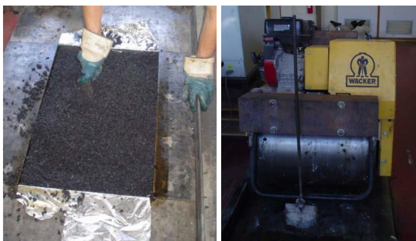
Figura 43: Sistema de moldagem e compactação de vigas utilizado por Fontes (2009).
