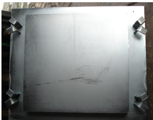
Figura 49: Face inferior do molde metálico (negativo) com engastes que servem para fixá-lo na base de compactação.
