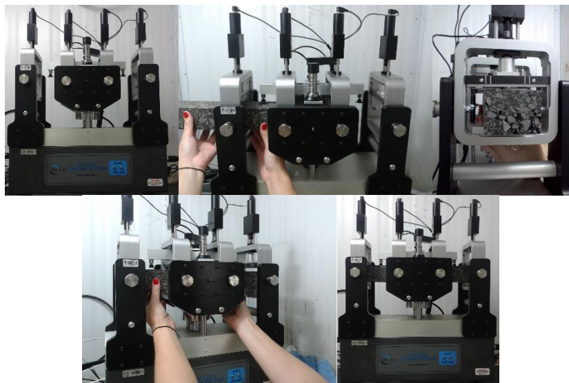
Figura 70: Posicionamento da amostra no equipamento de flexão em quatro pontos.
