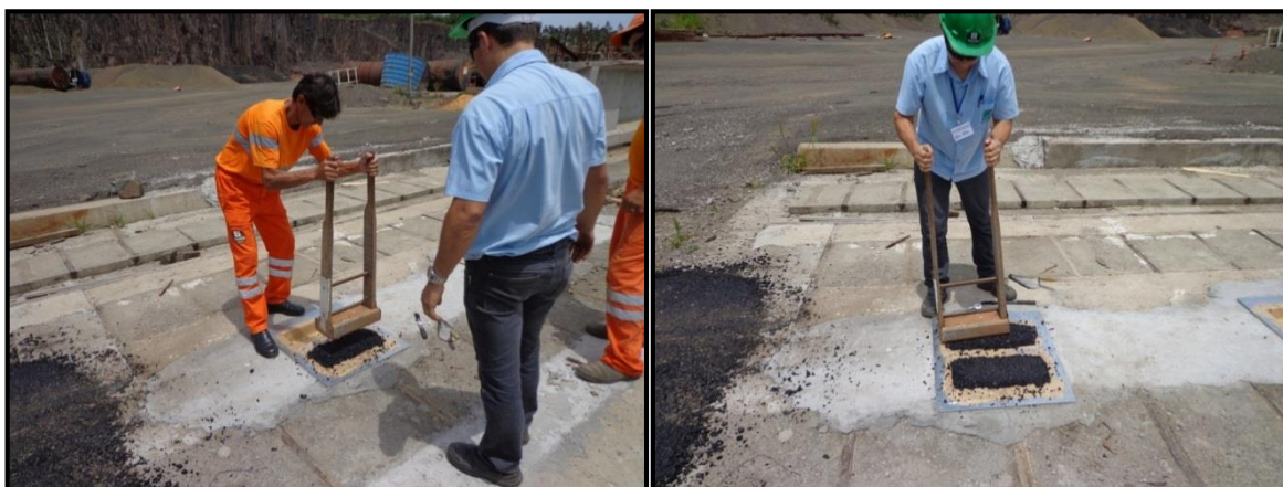
Figura 58: Pré-compactação da mistura asfáltica no interior dos moldes metálicos.
