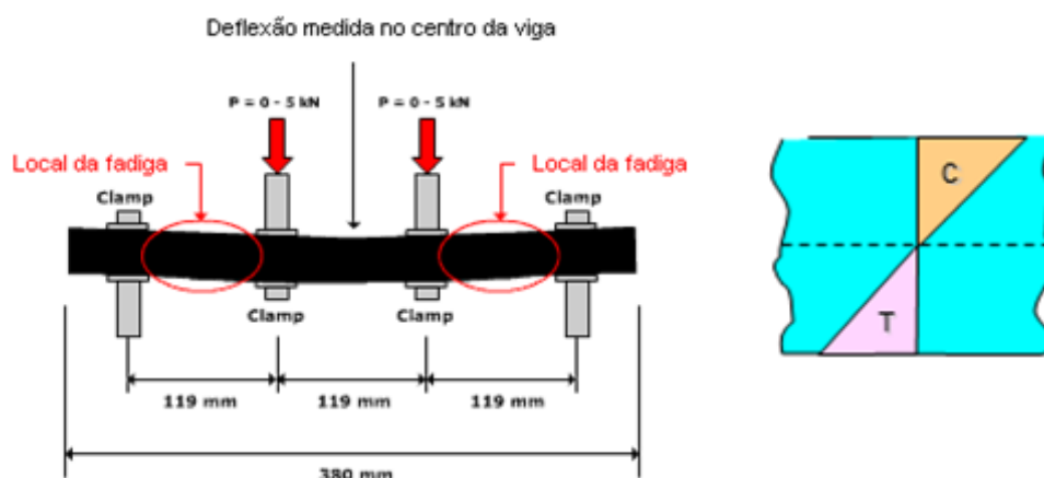
Figura 10: Configuração e distribuição de tensões no ensaio de fadiga à flexão em quatro pontos.
