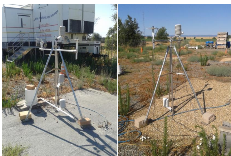
Figura 145: Monitoramento da temperatura e refletividade de diferentes tipos de pavimentos - ATIRC/UCDavis.
