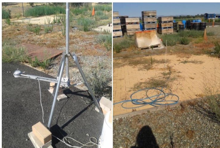
Figura 146: Monitoramento da temperatura e refletividade de diferentes tipos de pavimentos - ATIRC/UCDavis.
