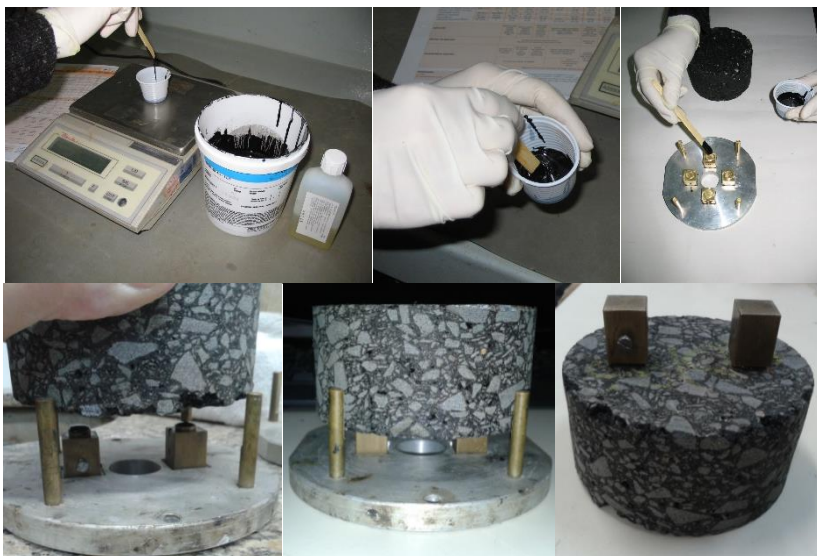
Figura 77: Sequência de montagem das peças de suporte no corpo de prova cilíndrico.
