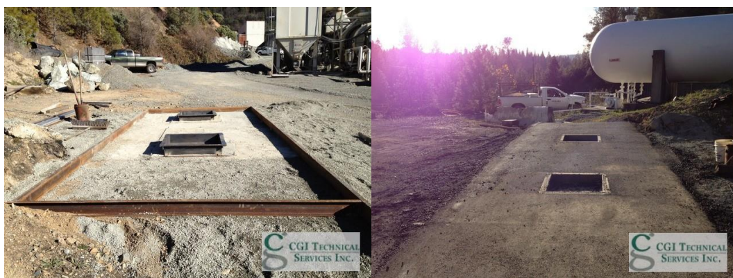
Figura 39: Sistema de moldes empregados pela Universidade da Califórnia para confecção de vigas em campo destinadas a ensaios de fadiga a quatro pontos.
