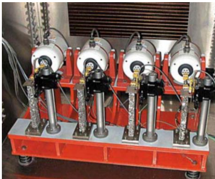
Figura 9: Configuração do ensaio de fadiga à flexão em amostras trapezoidais desenvolvido pelo Laboratório Central de Pavimentos e Rodovias - LCPC em Nantes/França.
