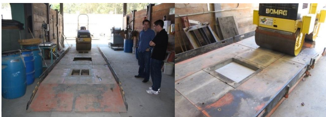
Figura 36: Sistema de moldes empregados pela Universidade da Califórnia para confecção de vigas em laboratório destinadas a ensaios de fadiga a flexão em quatro pontos.
