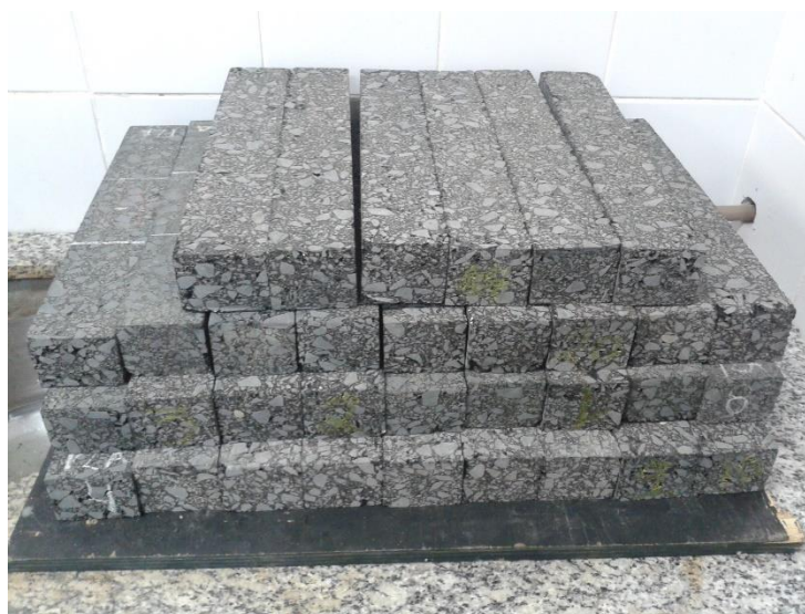
Figura 71: Corpos de prova prismáticos utilizados nesta pesquisa para os ensaios de fadiga à flexão em quatro pontos.
