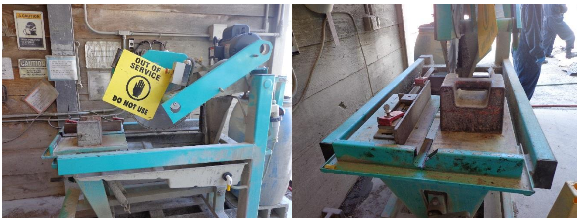
Figura 152: Equipamento utilizado no processo de corte das placas para obtenção das vigotas - UC Berkeley.
