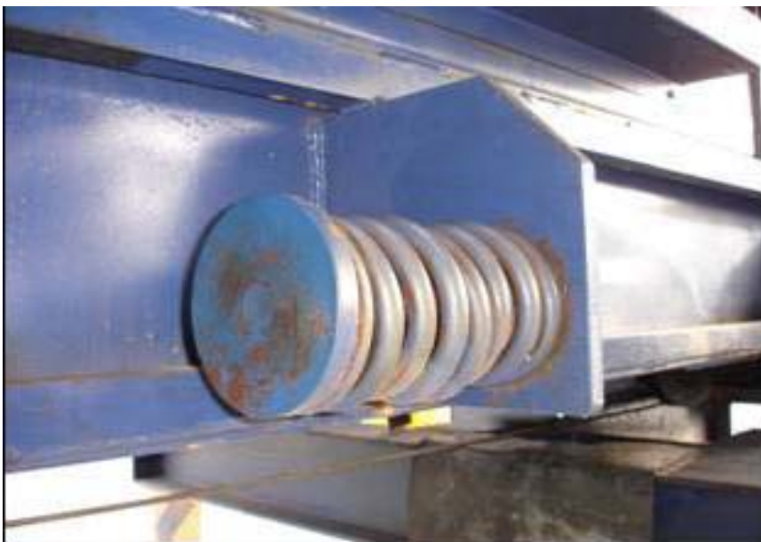
Figura 4.10: Detalhe do elemento de amortecimento do Simulador de Tráfego
