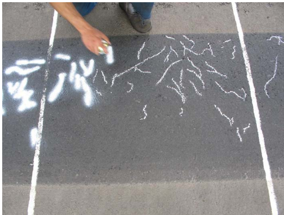
Figura 4.19: Marcação das trincas nos trechos ensaiados pelo Simulador de Tráfego
