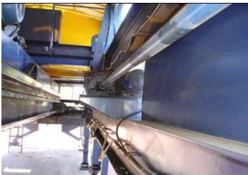
Figura 4.9: Detalhe do elemento responsável pelo deslocamento transversal do Simulador de Tráfego
