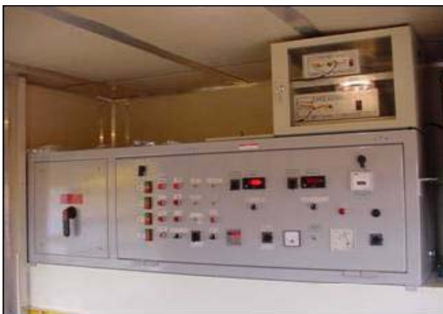
Figura 4.14: Detalhe do painel de controle do Simulador de Tráfego, localizado na cabine traseira do equipamento
