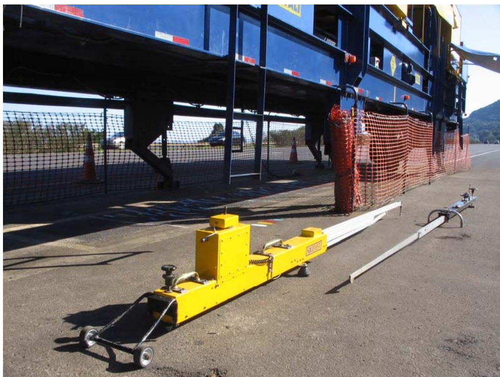
Figura 4.17: Viga Benkelman e Viga Eletrônica no Simulador de Tráfego na rodovia BR-290/RS
