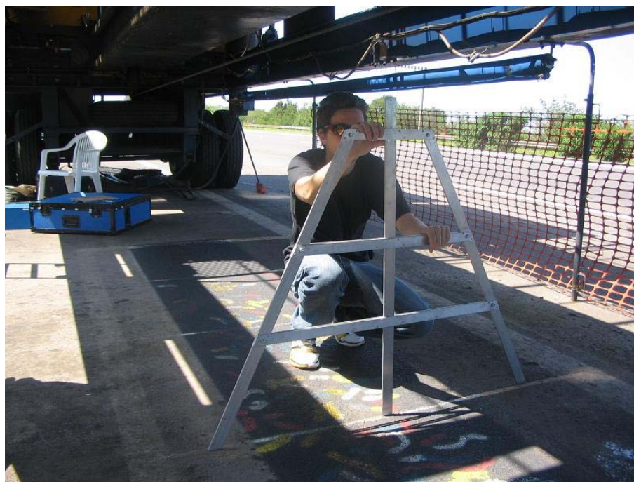
Figura 4.21: Medida do afundamento de trilha de roda com a treliça metálica
