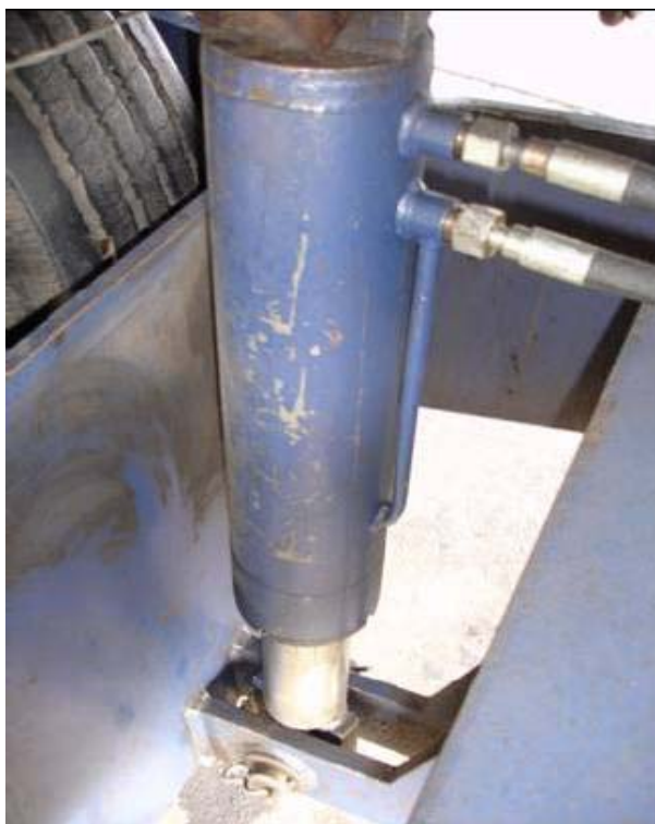
Figura 4.8: Detalhe da unidade hidráulica do Simulador de Tráfego
