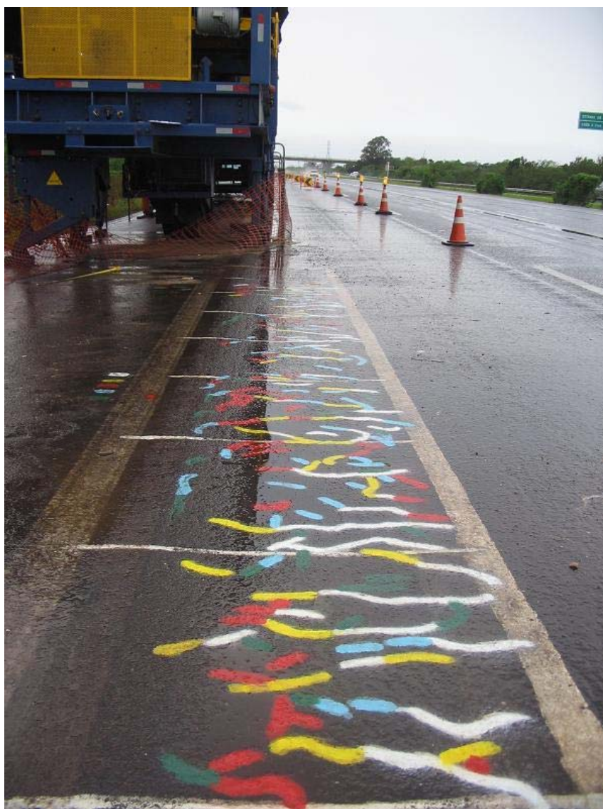
Figura 5.6: Foto da marcação das trincas no pavimento do "TRECHO SIMULADO 1"
