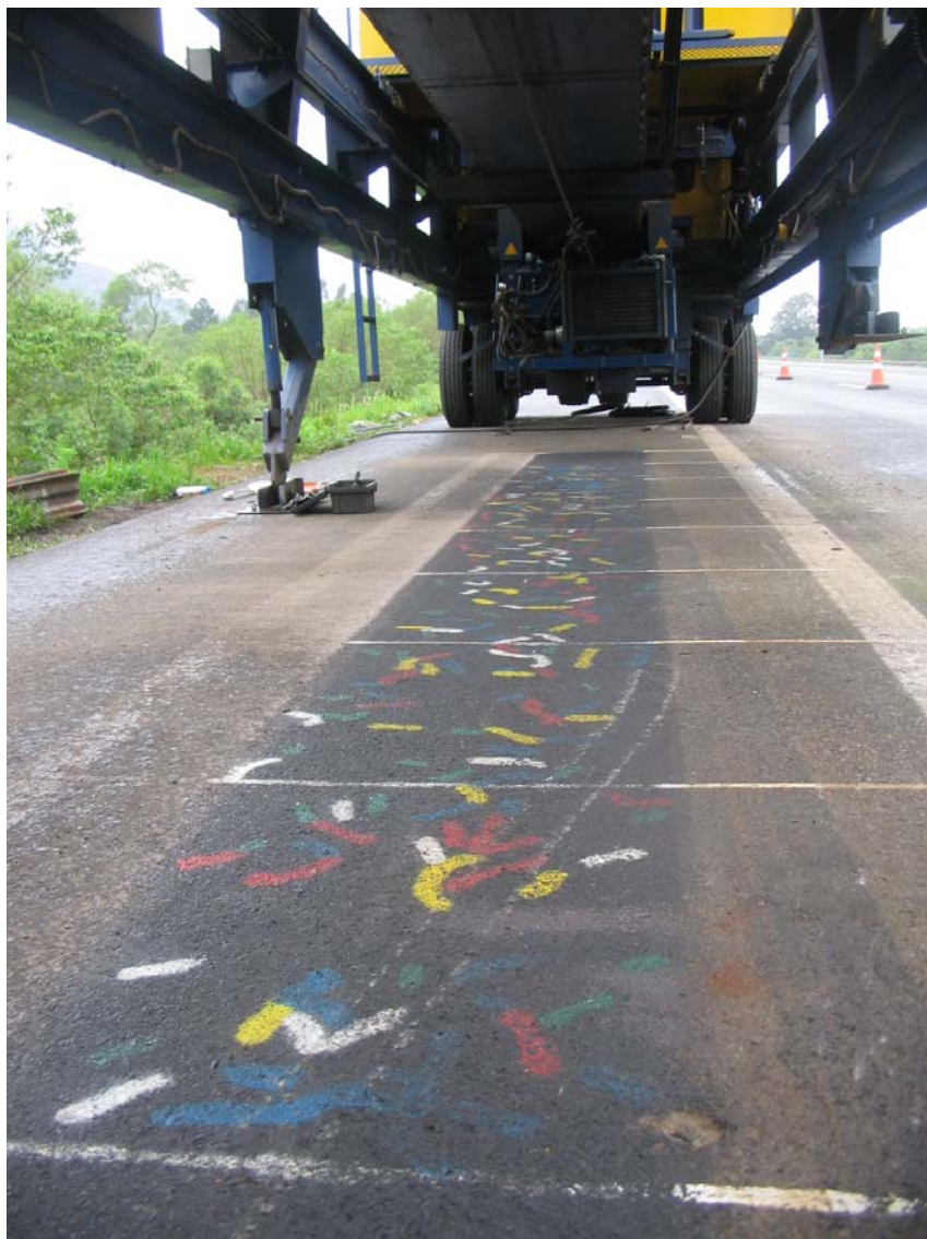
Figura 5.15: Foto da marcação das trincas no pavimento do "TRECHO SIMULADO 2"
