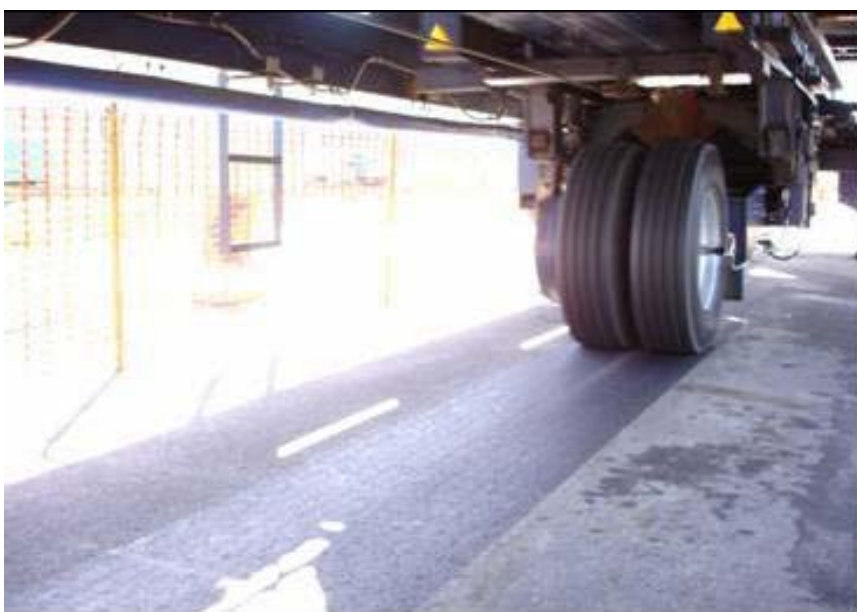
Figura 4.13: Detalhe do sistema de rodado do Simulador de Tráfego
