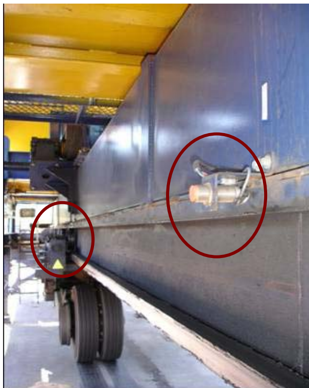
Figura 4.12: Detalhe dos sensores indutivos do Simulador de Tráfego
