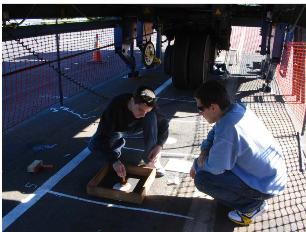
Figura 4.25: Ensaio de “Mancha de Areia”
