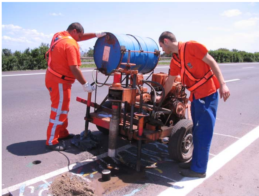
Figura 4.27: Extração de corpos-de-prova no trecho ensaiado pelo Simulador de Tráfego
