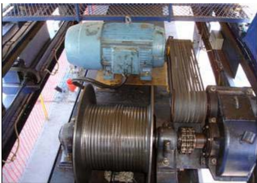
Figura 4.11: Detalhe do sistema de acionamento do Simulador de Tráfego
