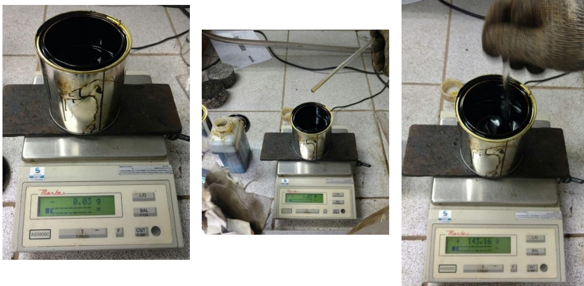
Figura 25: Procedimento de adição do aditivo surfactante.
