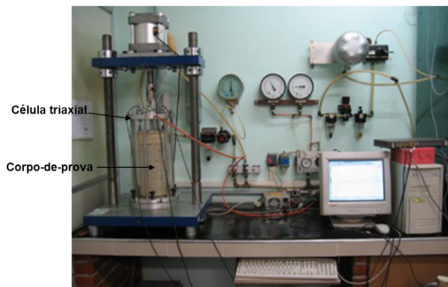
Figura 3: Arranjo laboratorial de ensaio triaxial de cargas repetidas para a determinação dos módulos de resiliência de solos e materiais granulares
