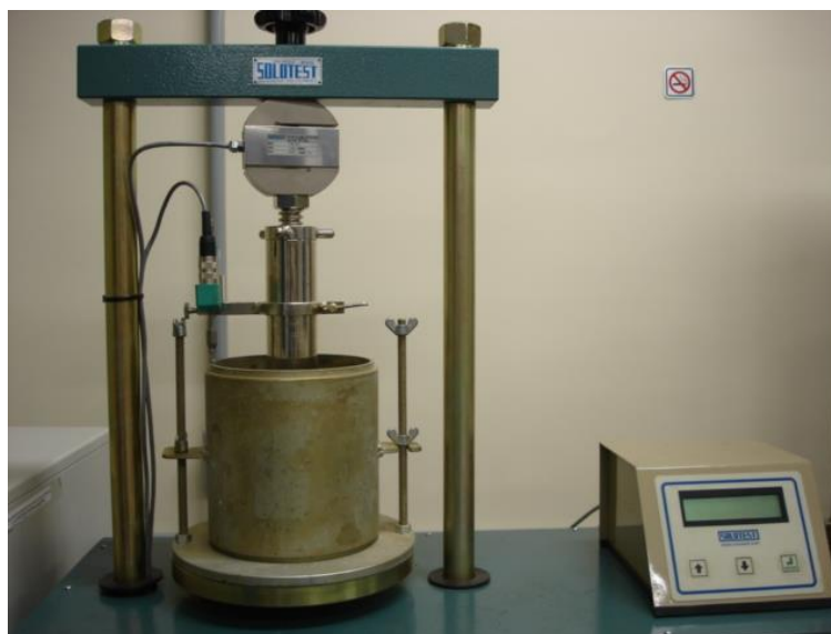
FIGURA 1: EQUIPAMENTO PARA ENSAIO CBR AUTOMATIZADO
