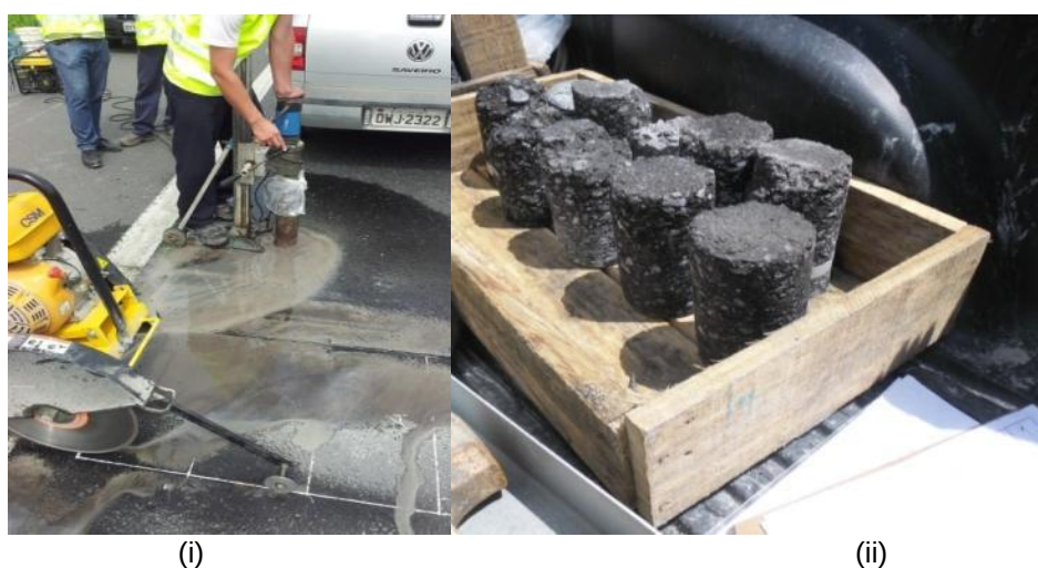
Figura 5: Extração por sonda rotativa: (i) nivelamento e broqueamento, e (ii) aspecto dos corpos de prova extraídos
