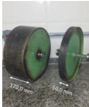
Figura 96 – Rolos lisos para compactação da mistura e simulação da deformação permanente
