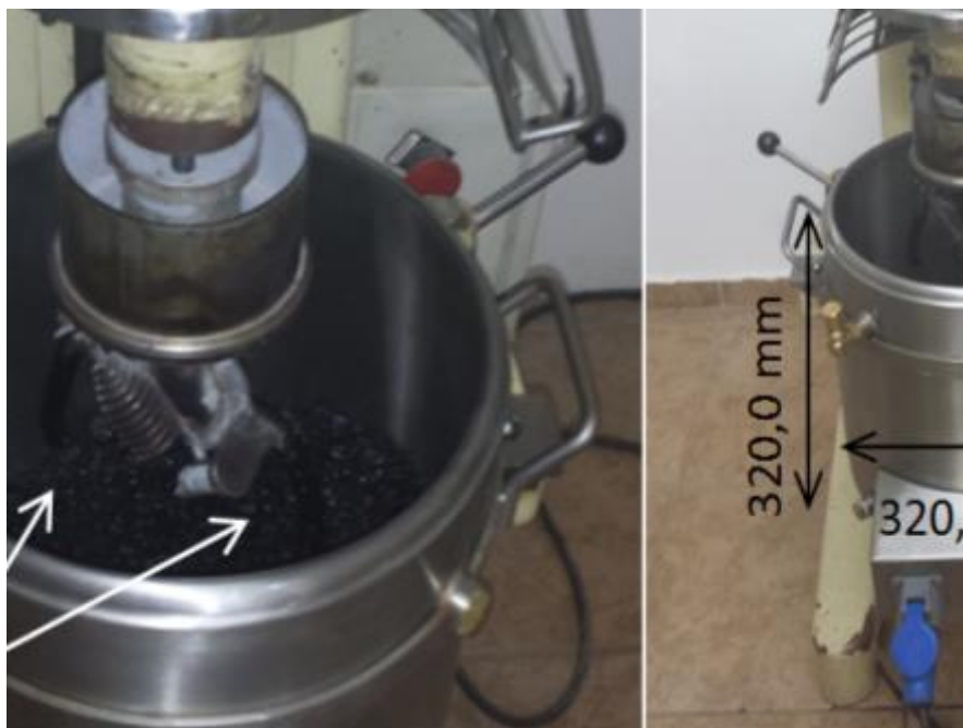
Figura 71 – Detalhe da misturadora e usinagem da mistura
