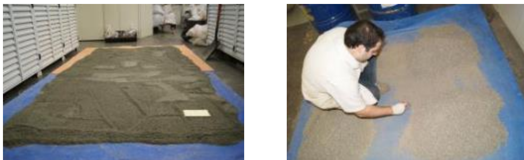
Figura 25 – Preparação do pó de pedra
