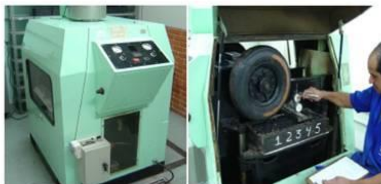
Figura 13 – Simulador de tráfego tipo LCPC: (i) vista geral, e (ii) medição dos afundamentos em trilha de roda de mistura asfáltica durante teste
