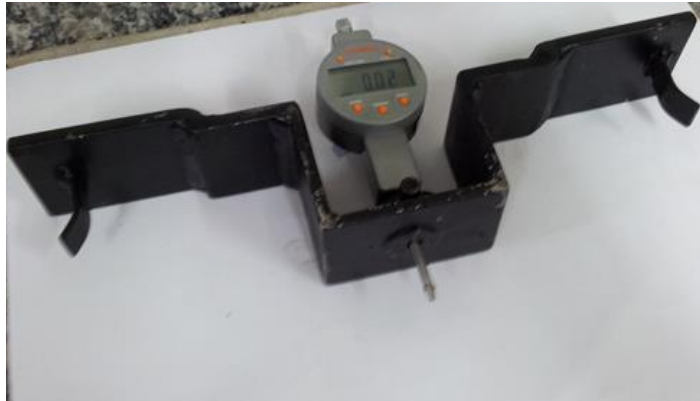
Figura 99 – Detalhe do gabarito utilizado em ensaio para medida da deformação acumulada
