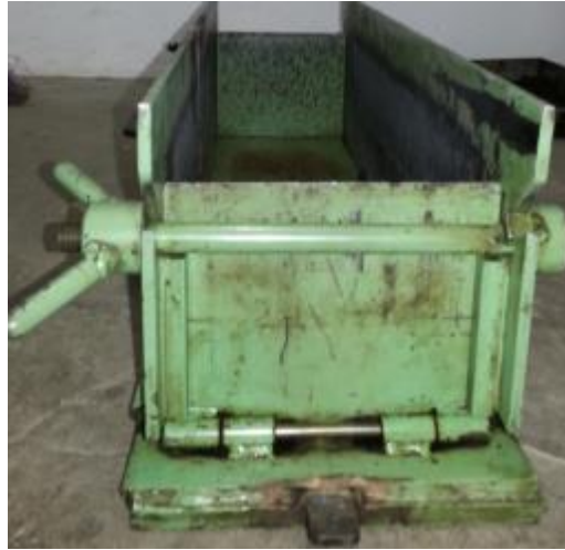
Figura 84 – Encaixe de desmonte de paredes do molde
