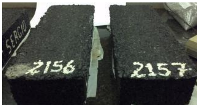
Figura 54 – Par de placas com teor de 4,6%
