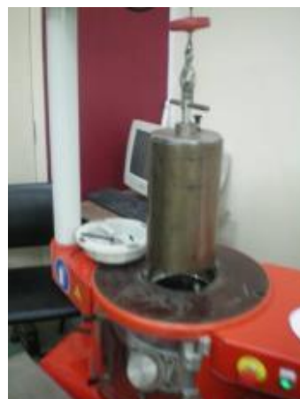
Figura 5 – (i) vista geral do Compactador PCG (giratório francês) instalado no LTP-EPUSP e (ii) detalhe do tamanho do cilindro metálico para a compactação das misturas asfálticas com 150mm de diâmetro
