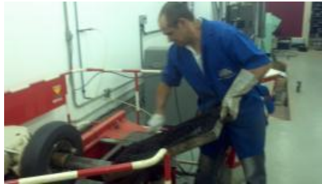
Figura 52 – Colocação da mistura no compactador
