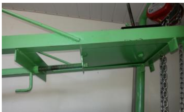
Figura 82 – Detalhe de ajuste do braço de alavanca
