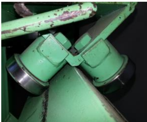
Figura 89 – Rodas em ambos os lados do trilho
