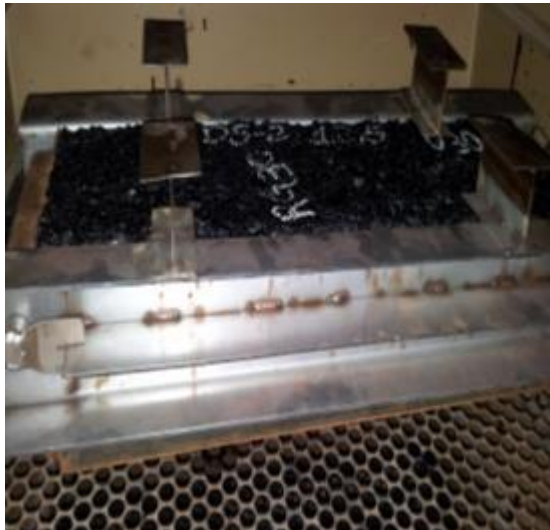
Figura 97 – Detalhe da mistura em condicionamento e da curva para definição do tempo de estabilização da placa a 60°C em estufa
