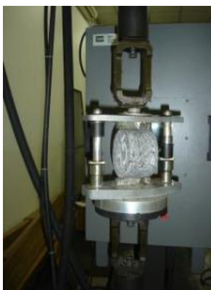
Figura 43 – Detalhe do corpo de prova durante o ensaio de RT
