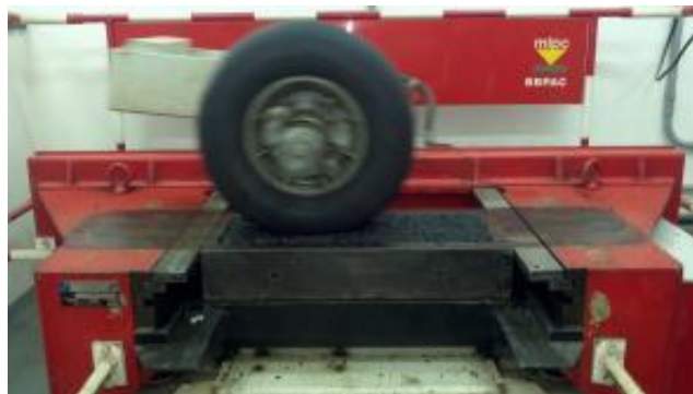
Figura 53 – Detalhe da mistura durante a compactação
