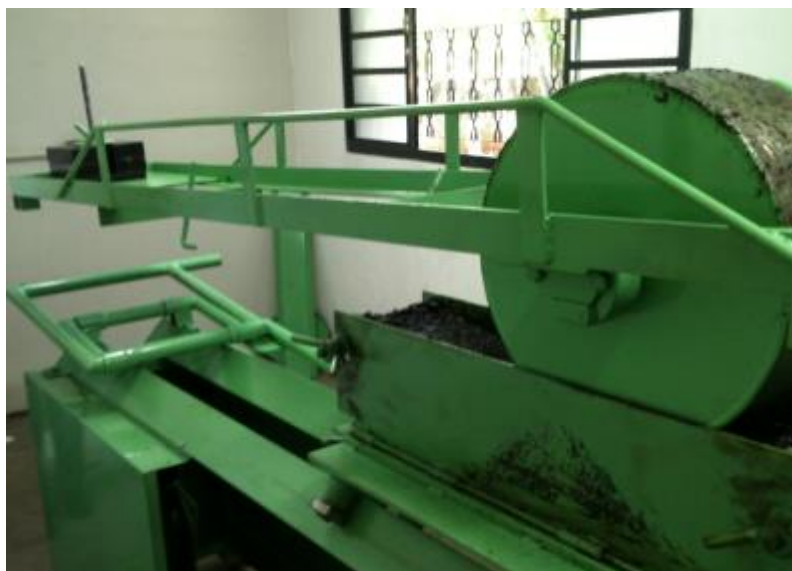
Figura 76 – Equipamento reestruturado para compactação por rolagem
