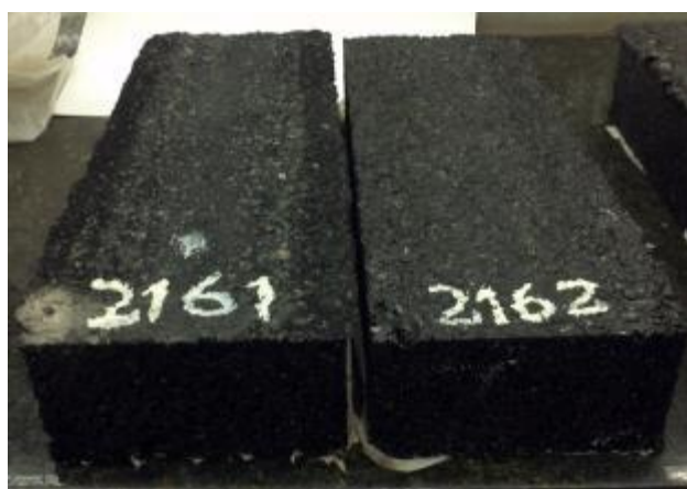
Figura 55 – Par de placas no teor de 5,8%
