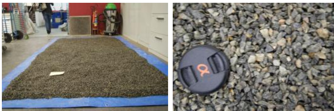
Figura 24 – Preparação do pedrisco
