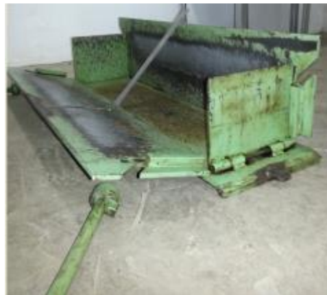
Figura 85 – Parede lateral do molde aberta
