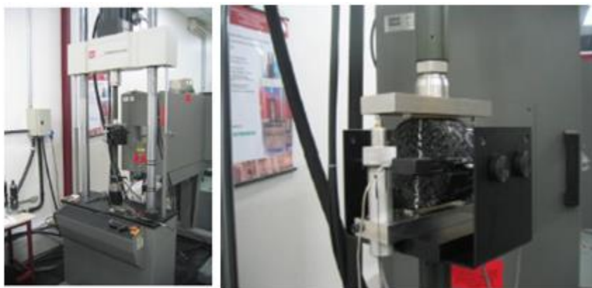
Figura 16 – Ensaio de módulo de resiliência e detalhe de corpo-de-prova durante o ensaio
