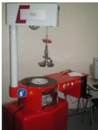
Figura 5 – (i) vista geral do Compactador PCG (giratório francês) instalado no LTP-EPUSP e (ii) detalhe do tamanho do cilindro metálico para a compactação das misturas asfálticas com 150mm de diâmetro
