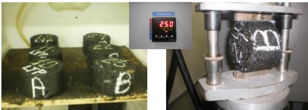
Figura 116 – Etapas do ensaio de resistência à tração por compressão diametral
