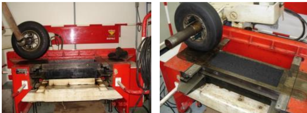
Figura 9 – Compactador tipo LCPC instalado no LTP-EPUSP
