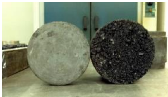
Figura 3 – Base do soquete de seção plena (à esquerda) e base circular do corpo de prova de mistura asfáltica compactada com 100mm de diâmetro (à direita)
