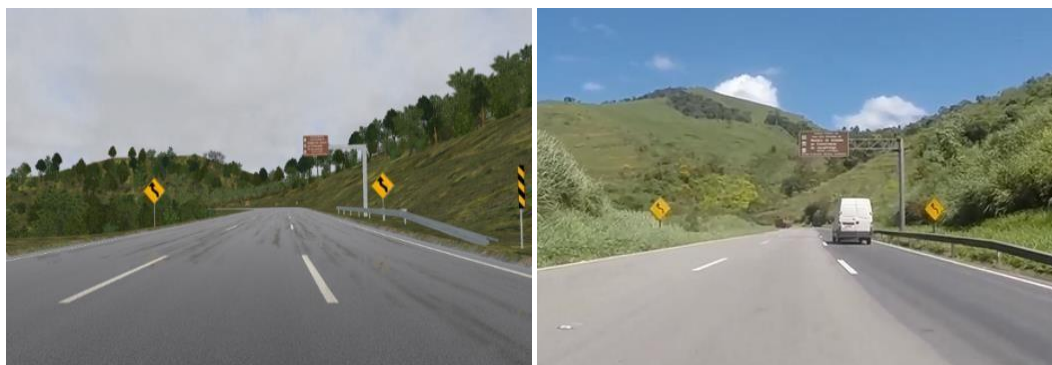
Figura 1. Visualização da sinalização vertical para testes em simulador de direção. Comparação do cenário virtual (esquerda) e o cenário real (direita)
