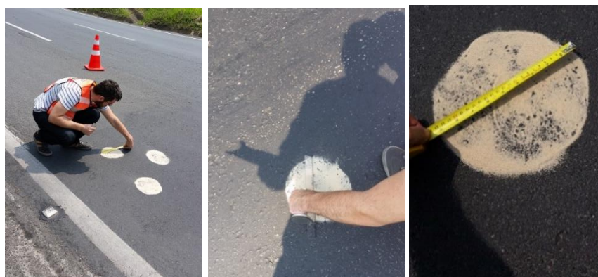
Figura 134. Ensaio do cone de areia nas curvas críticas do trecho de estudo
