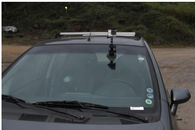
Figura 22. Filmadora acoplada ao veículo para execução de filmagem do trecho
