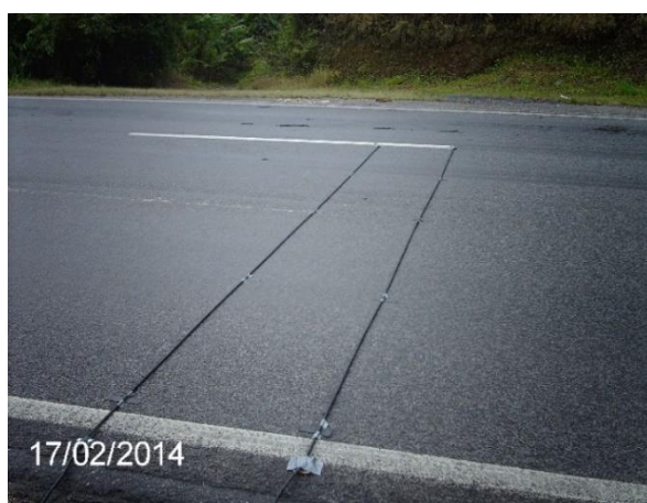
Figura 7 - Mangueiras fixadas no pavimento e equipe instalando o equipamento
