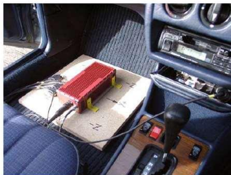
Figura 5. Sensor inercial acoplado ao veículo
