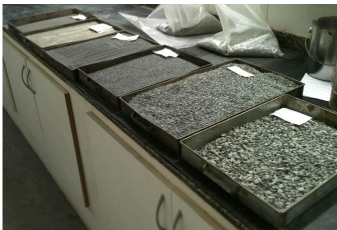
Figura 19. Ilustração do fracionamento dos agregados peneira a peneira para composição da granulometria do SAMI feita no CDT
