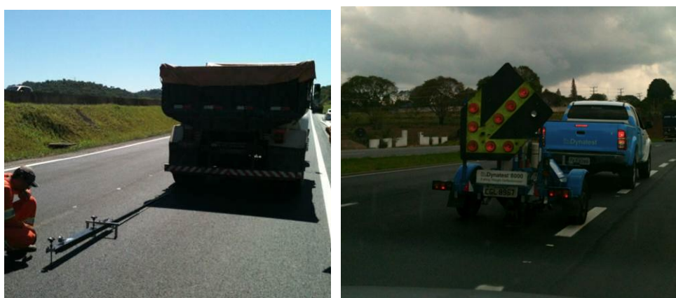
Figura 49. Equipamentos de medidas de deflexão: (a) viga Benkelman e (b) FWD
