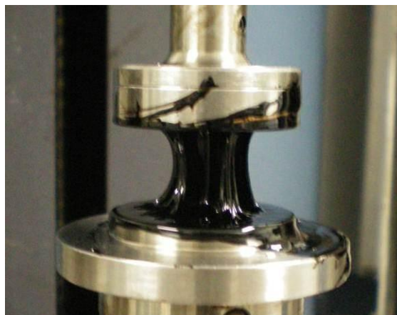
Figura 70. Ilustração da amostra de HiMA após o ensaio a 88°C
