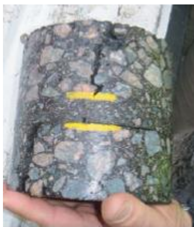
Figura 15. Corpo de prova da estrutura do pavimento estudado por BENNERT et al. (2009) e ilustração da camada intermediária anti-reflexão de trincas ainda íntegra.
