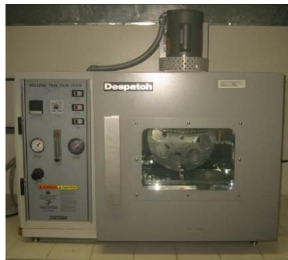
Figura 63. Estufa de Filme Fino Rotativo – RTFOT (simulação do envelhecimento de curto prazo)
