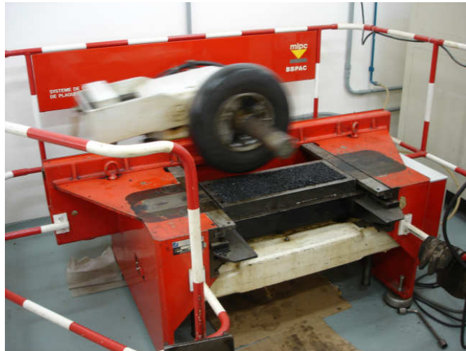
Figura 20. Moldagem de uma placa na mesa compactadora francesa
