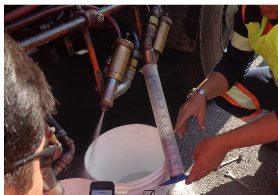
Figura 56 – Calibração das pistolas de aspersão de microesferas
