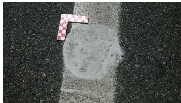
Figura 63 – Ensaio de mancha de areia na pintura de sinalização
