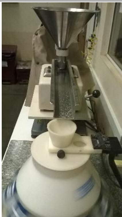
Figura 38 - Amostra de microesfera de vidro na calha vibratório do quarteador rotativo.
