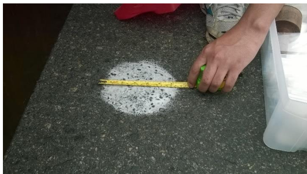
Figura 62 – Ensaio de mancha de areia sendo executado
