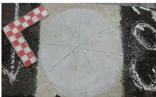
Figura 101 – Ensaio para determinação da macrotextura.
