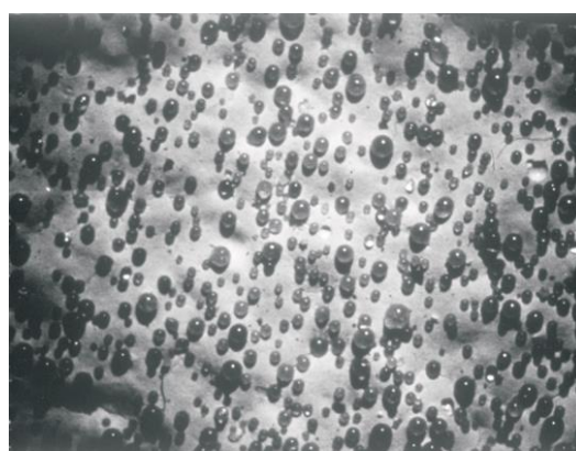
Figura 23 – Esferas de vidro com ancoramento deficiente - VDOT (2012)
