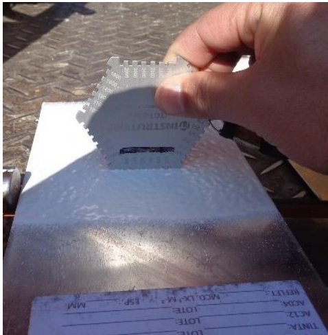
Figura 57 – Verificação da espessura da película de tinta
