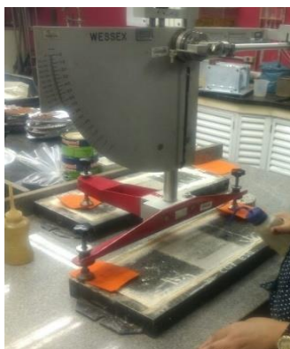
Figura 103 - Ensaio para determinação da microtextura.
