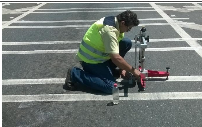
Figura 68 – (a) imagem do equipamento com o braço munido de sapata com borracha e (b) Levantamento de Microtextura nas faixas experimentais da pesquisa
