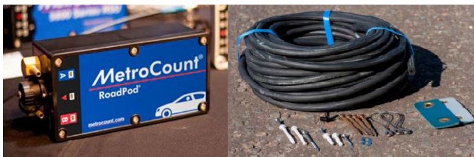
Figura 34 - Equipamento para contagem e classificação dos veículos e acessórios necessários para instalação e operação
