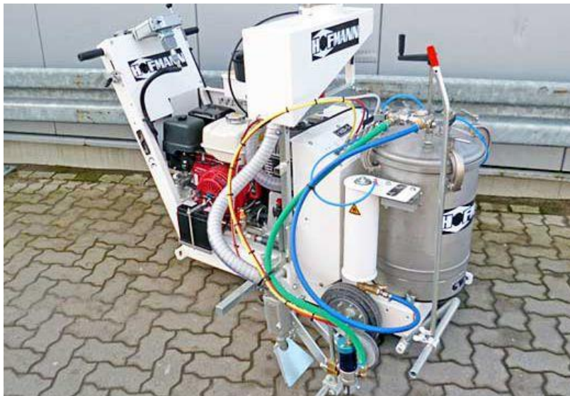
Figura 13 - Equipamento portátil para pintura de sinalização viária, modelo H9-1, marca Hofmann FONTE: Hofmann.
