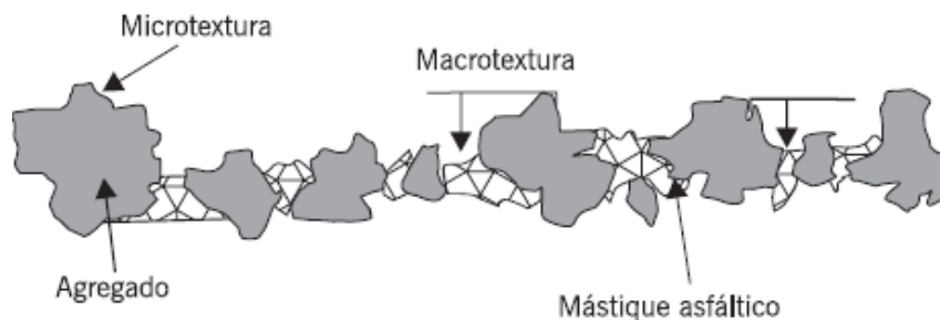
Figura 75 – Micro e macrotextura na superfície de um revestimento asfáltico
