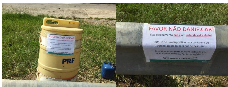
Figura 43 - Avisos Instalados nas proximidades dos sensores
