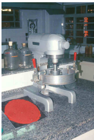
Figura 7.3 – Equipamento de ensaio para abrasão por via úmida
