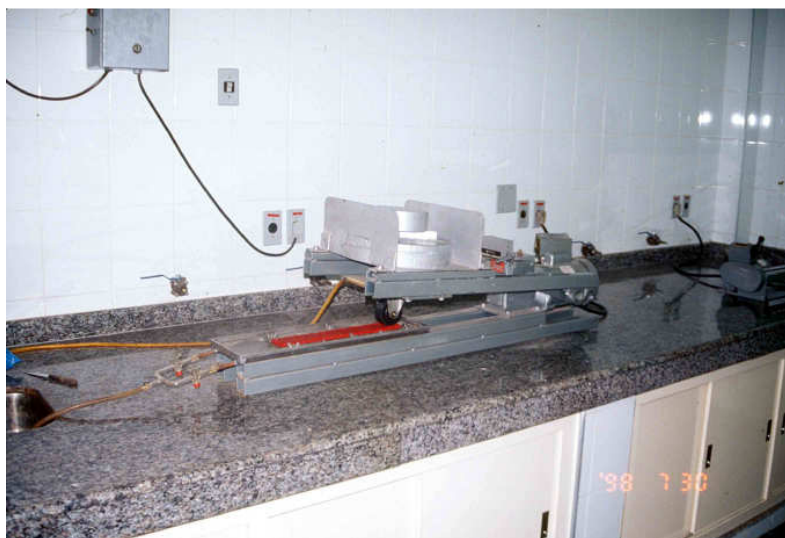
Figura 7.4 – Ensaio de excesso de asfalto por LWT e adesão de areia
