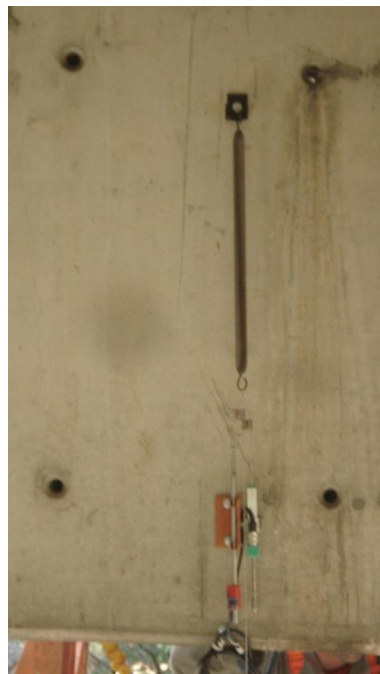
Figura D.50 – Mola e medidores de deslocamento empregados no meio de vão.
