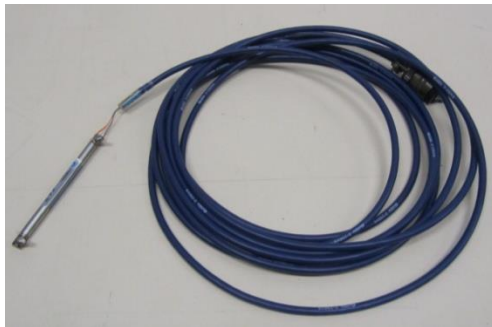
Figura D.4 – Sensor de abertura de fissuras – corda vibrante.
