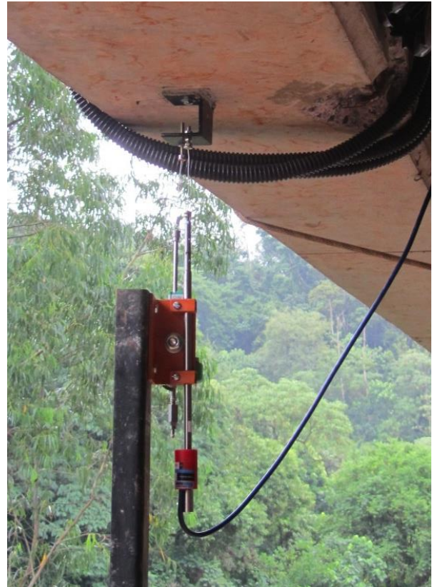
Figura D.48 – Transdutores de deslocamentos para medições no meio de vão.
