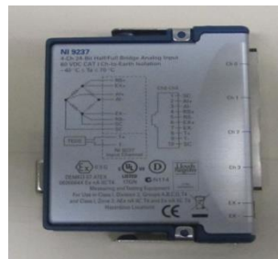
(c) Módulo ponte completa
