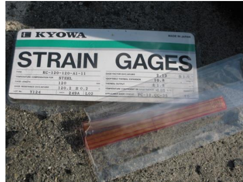
(d) Escolha do extensômetro
