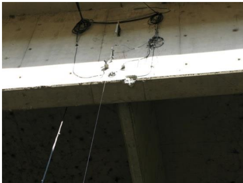
(a) Deslocamento vertical meio do vão
