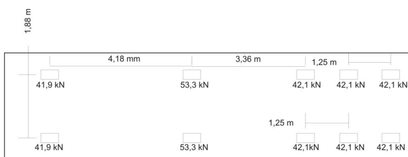
Figura B.13 – Veículo de prova usado no monitoramento com tráfego controlado.
