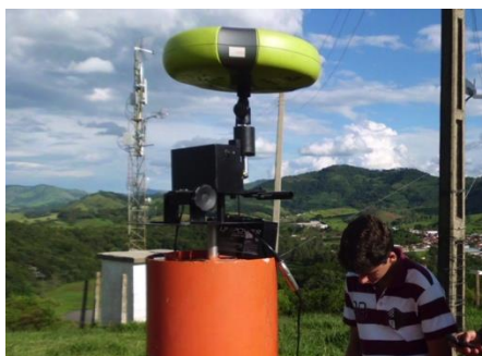
Figura G.6 – Antena GPS sobre o Oscilador Eletromecânico no Pilar Geodésico.
