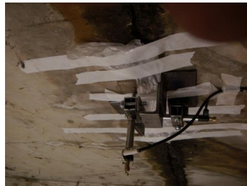
(d) Deslocamento horizontal e vertical na laje
