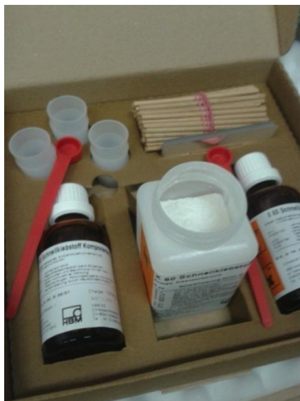
Figura D.32 – Cola à base de metil metacrilato X60.
