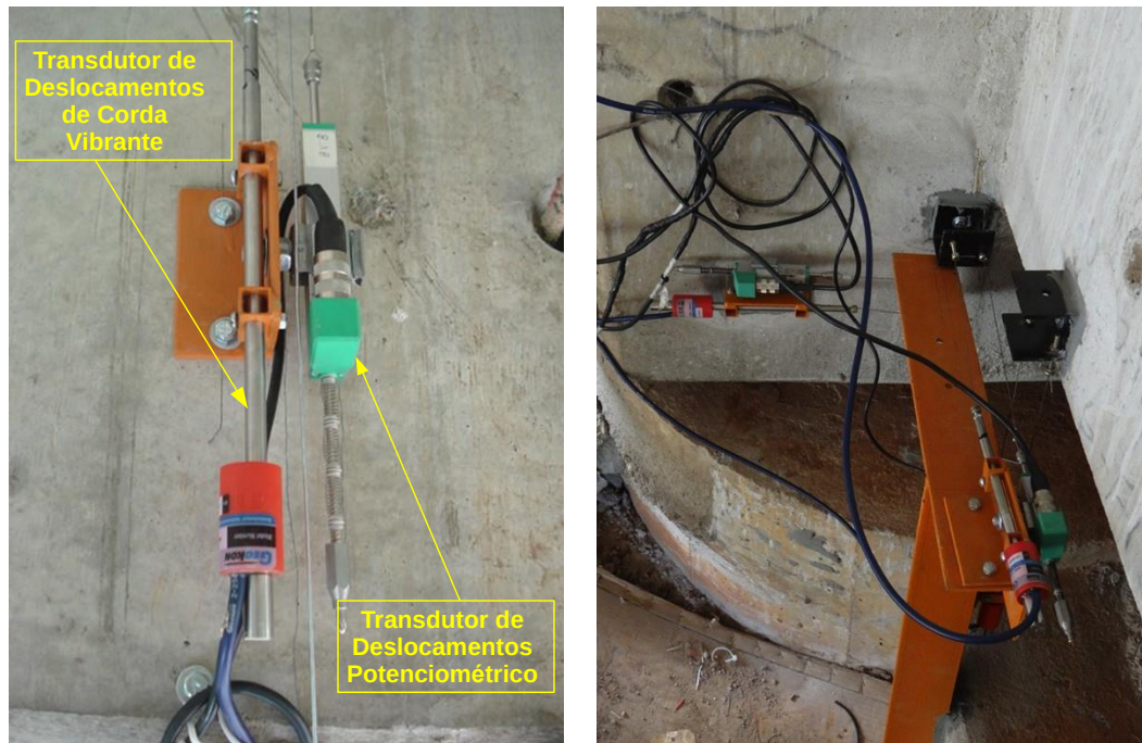
Figura 3 – Transdutores de deslocamento instalados no meio de vão e nos apoios da ponte.
