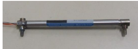
Figura D.4 – Sensor de abertura de fissuras – corda vibrante.
