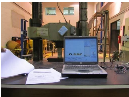
Figura A.15 – Ensaio para determinação do módulo de elasticidade do concreto.
