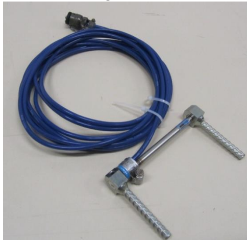
Figura D.3 – Sensor de deformação do concreto – corda vibrante.
