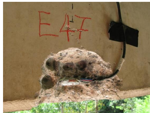
(h) Extensômetro instalado na armadura
