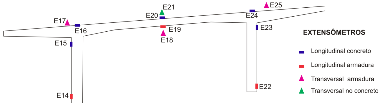
Figura B.5 – Disposição dos extensômetros elétricos na seção S2.
