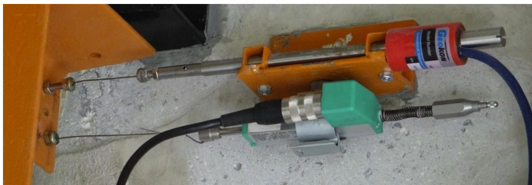
Figura D.46 – Detalhe mostrando o uso de transdutores diferentes para medir o deslocamento em um mesmo ponto.
