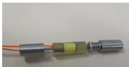
Figura D.2 – Sensor de deformação da armadura – corda vibrante.
