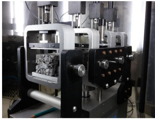
Figura 64. Equipamento para flexão da vigota em 4 pontos
