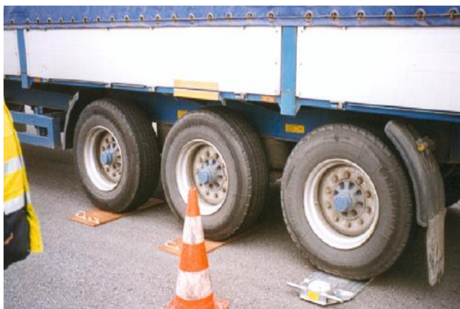
Figura 2. Pesagem estática com balança por eixo (Jacob And Beaumelle, 2010)
