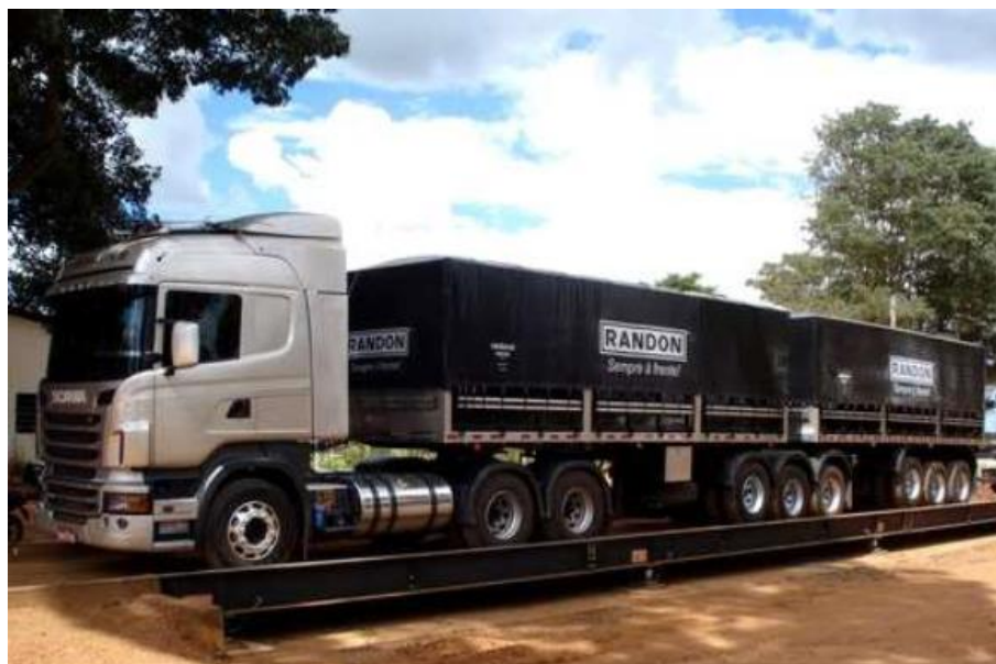
Figura 1. Pesagem com balança estática (ANTT, 2014)
