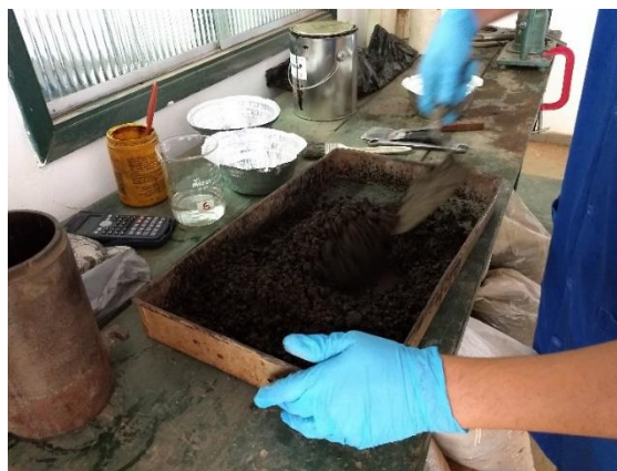
Figura 91. RAP + emulsão (Fase I) sendo misturado antes da compactação
