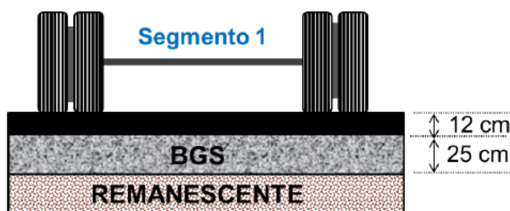
Figura 188. Seção esquemática do trecho experimental (segmento 1 da Fase I)
