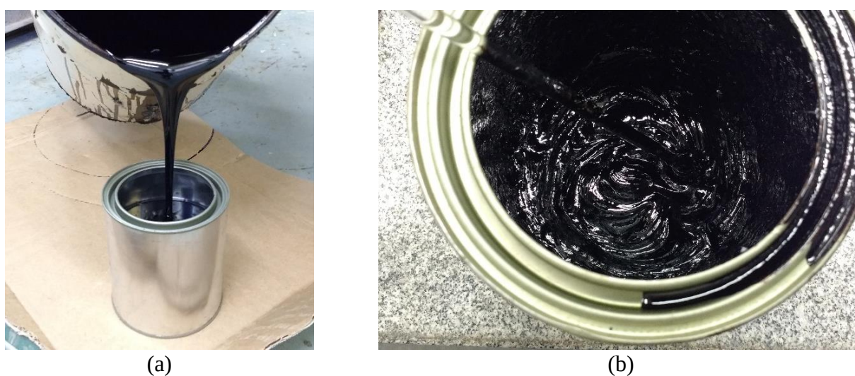
Figura 80. Emulsão asfáltica: (a) transferência da emulsão asfáltica para recipiente metálico e (b) resíduo da emulsão após evaporação a 130^\circ\text{C}
