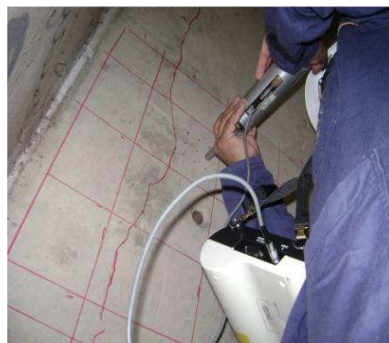
(a) (b) Figura 19 – Ensaio de esclerometria realizados na TR20, Zona 1, próximo a V1; (a) localização dos ensaios, (b) equipamento utilizado no ensaio.
