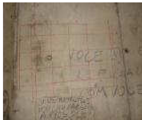
Figura 18 – Ensaios de pacometria realizados na TR20, Zona 1, próximo a V1; (a) Diagrama do resultado, (b) Desenho do posicionamento das armaduras.
