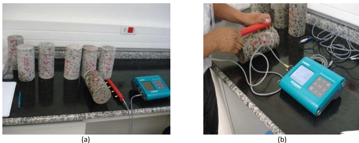
Figura 25 - Realização de ensaios de resistividade elétrica nos testemunhos extraídos da ponte do rio Jaguari
