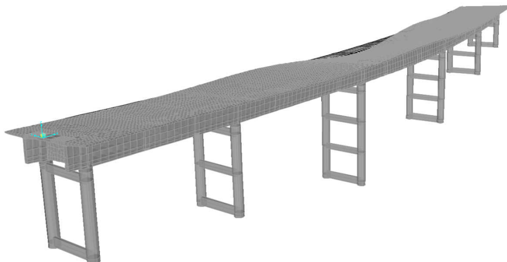
Figura 18 - Vista da deformada e da indeformada da estrutura para o modo de vibração 5 ( f_n = 4,6195\text{Hz} )
