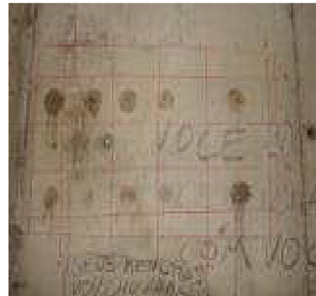
(a) (b) Figura 22 – Ensaio de ultrassom realizado na TR20, Zona 1, próximo a V1; (a) diagrama de localização, (b) pontos de localização do ensaio.
