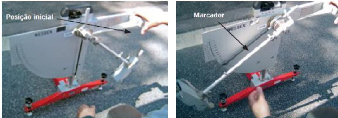
Figura 145 – Ensaio de microtextura (pêndulo britânico)
