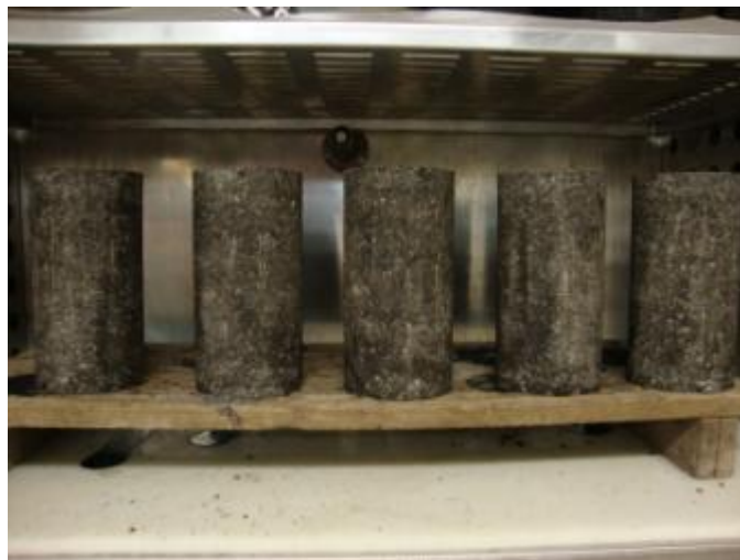
Figura 115 – Aspectos das misturas com 1% de cimento e sem emulsão
