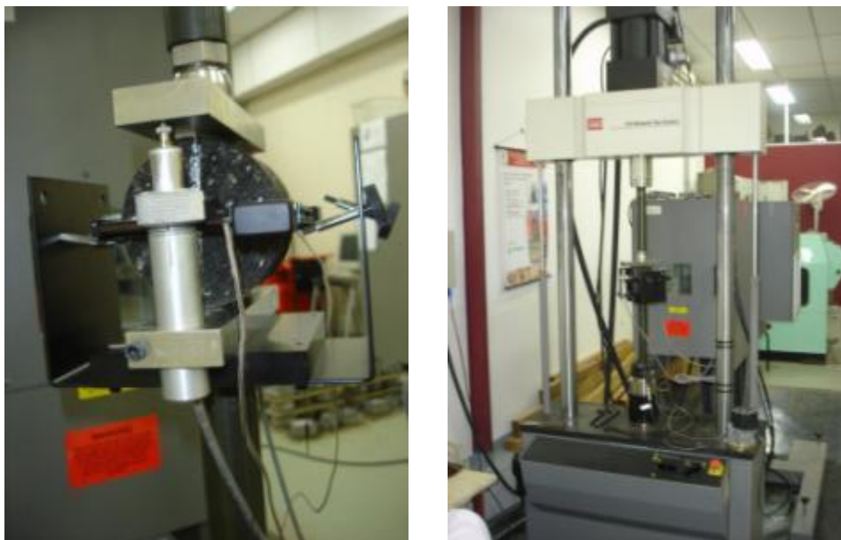
Figura 75 – Instrumentação para ensaio de MR
