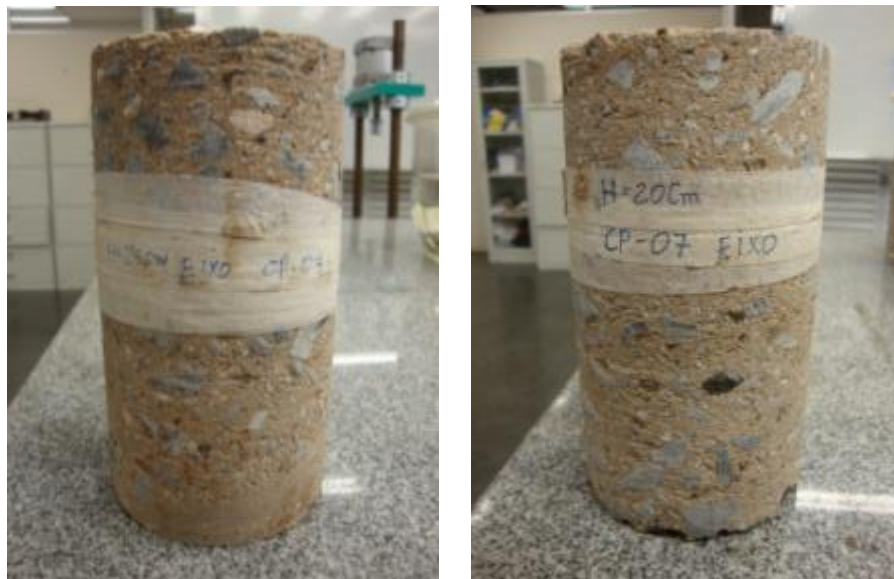
Figura 166 – CPs extraídos de pista para ensaio de MR
