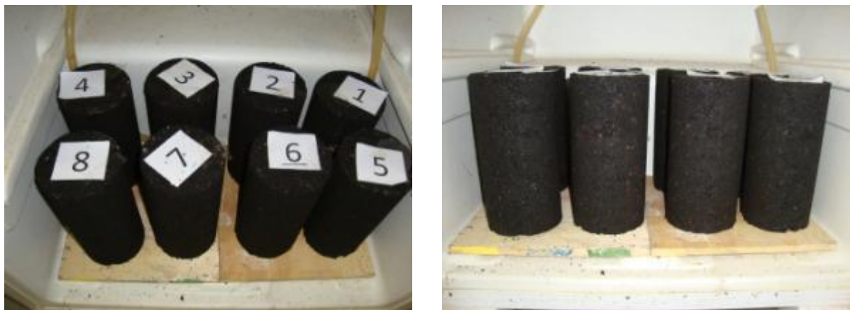
Figura 121 – CPs moldados em laboratório sendo submetidos ao processo de cura a temperatura controlada (25°C)
