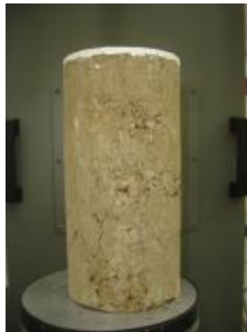
Figura 31 – CP rompido após ensaio de RCS
