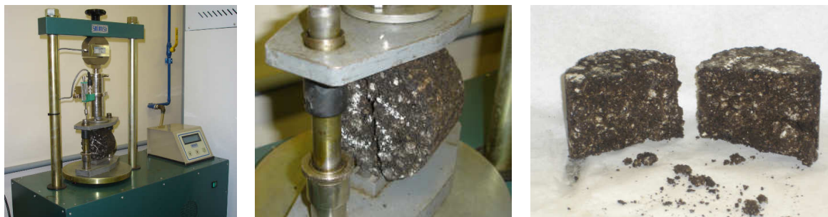
Figura 6 – Ensaio de resistência à tração por compressão diametral
