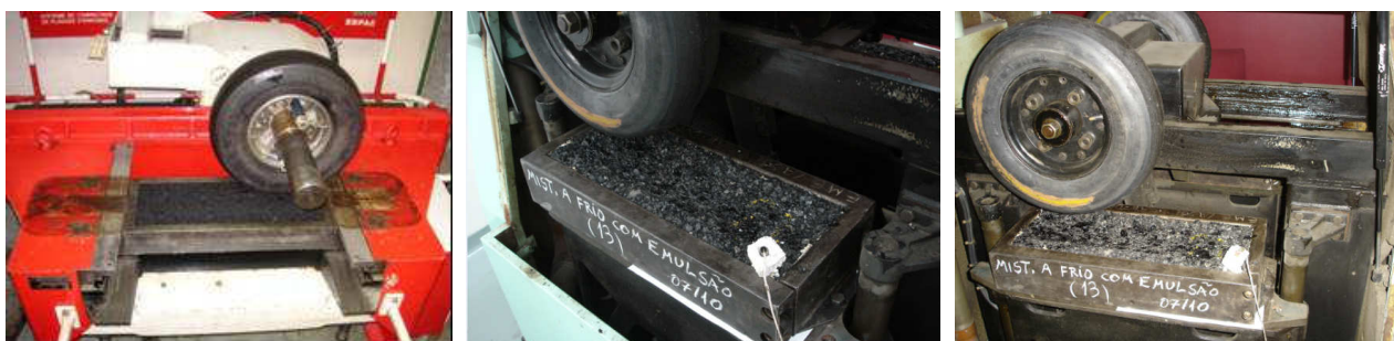
Figura 9 – Mesa compactadora e Simulador de trafego LPC
