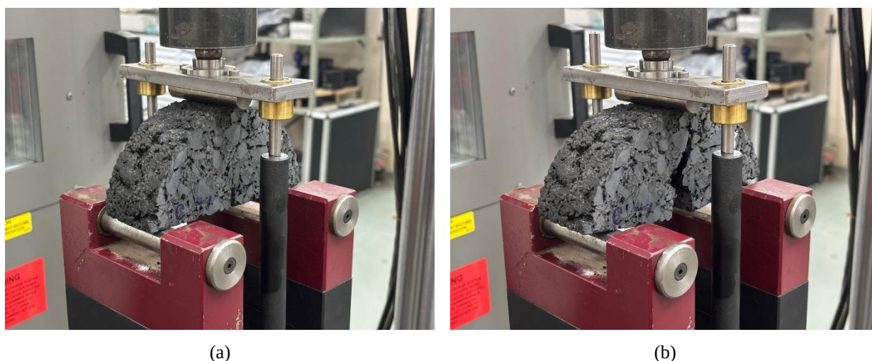
Figura 62 – Realização do ensaio de SCB: (a) amostra íntegra e (b) amostra fraturada
