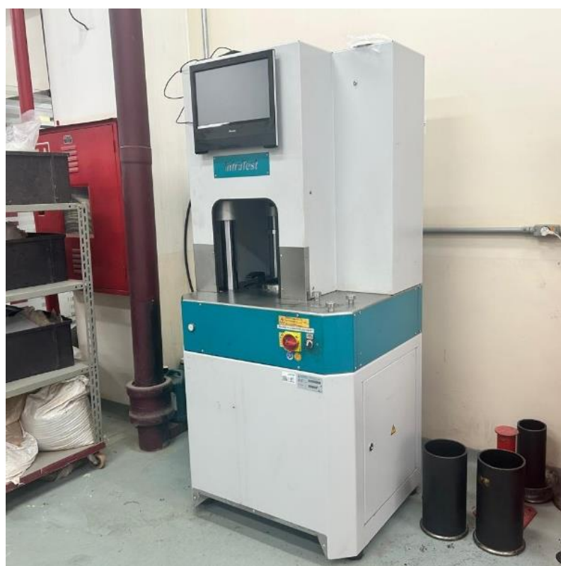
Figura 17 – Compactador Giratório Superpave iT 2018 da InfraTest instalado no LTP-EPUSP
