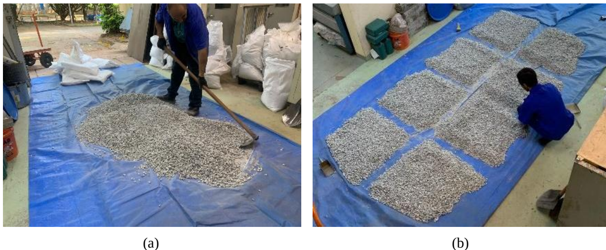
Figura 31 – Redução de amostras em laboratório: (a) homogeneização e (b) quarteamento
