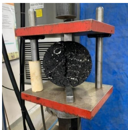
Figura 51 – Ruptura do corpo de prova durante o ensaio de resistência a tração por compressão diametral em alta temperatura
