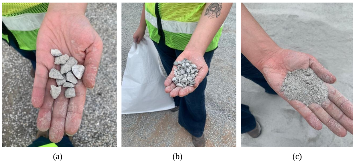
Figura 28 – Agregados A: (a) Brita 1, (b) Pedrisco e (c) Pó de pedra
