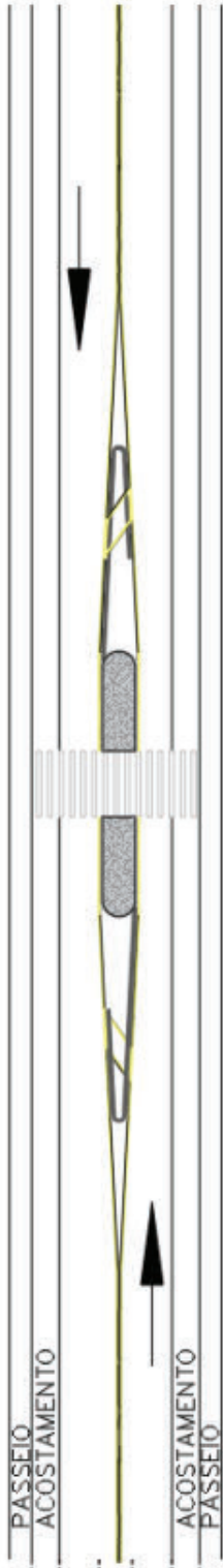
Figura 5 – Croqui Básico Travessias em Nível com Ilha de Proteção
