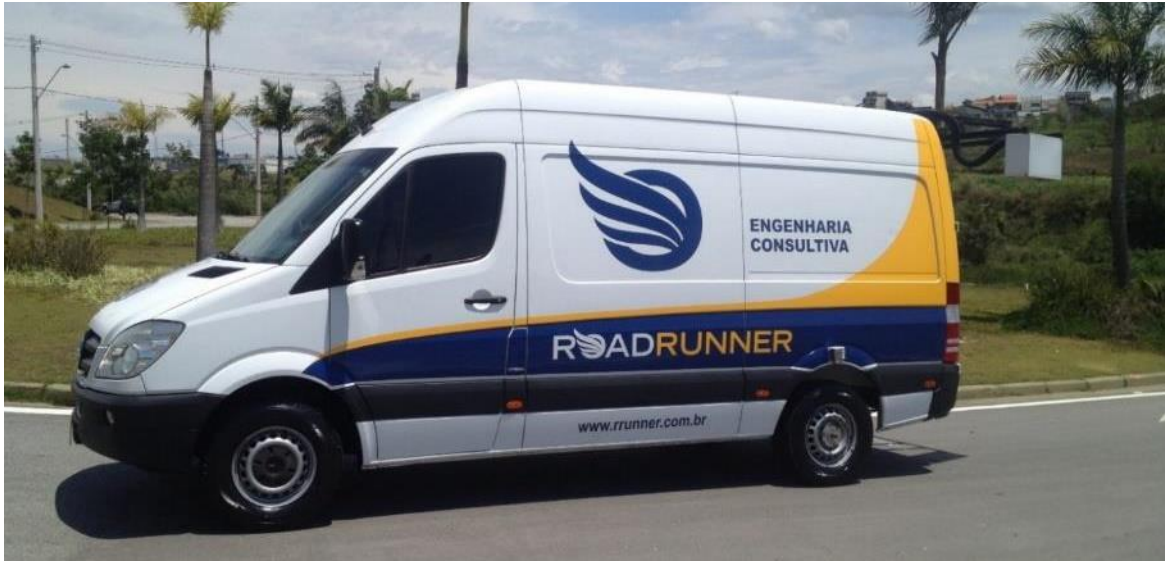
Figura 2: Veículo do Pavement Scanner em operação no Brasil.
