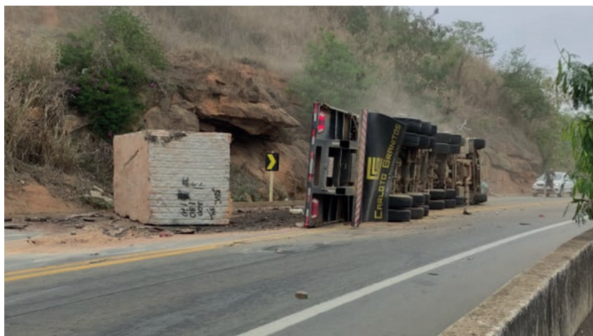
Figura 2 – Caminhão tombado por excesso de peso (Fonte: https://www.agazeta.com.br/es/transito/carreta-carregada-com-pedra-de-granito-tomba-na-br-259-em-colatina-1021 - consulta em 20/12/2021)
