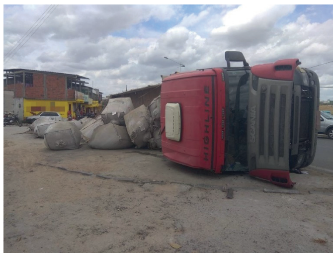
Figura 1 - Tombamento de caminhão com excesso de peso (Fonte: https://g1.globo.com/pb/paraiba/noticia/carreta-tomba-por-excesso-de-peso-em-campina-grande.ghtml - consulta em 20/12/2021)
