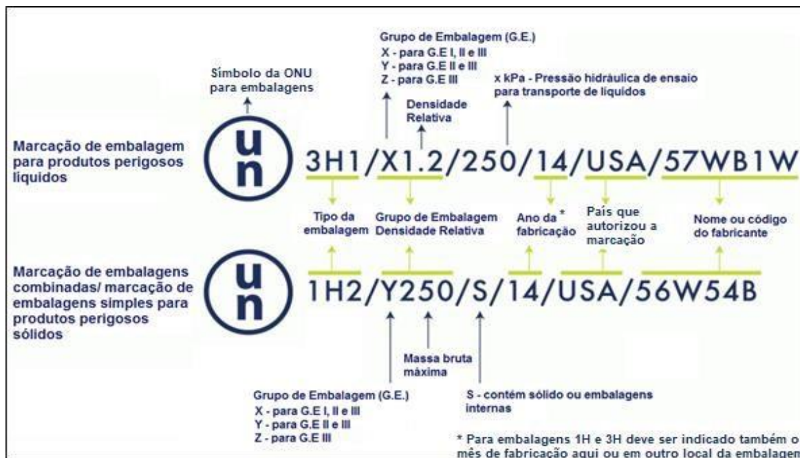
FIGURA 19 - Exemplo do significado das informações constantes na marcação ONU das embalagens
