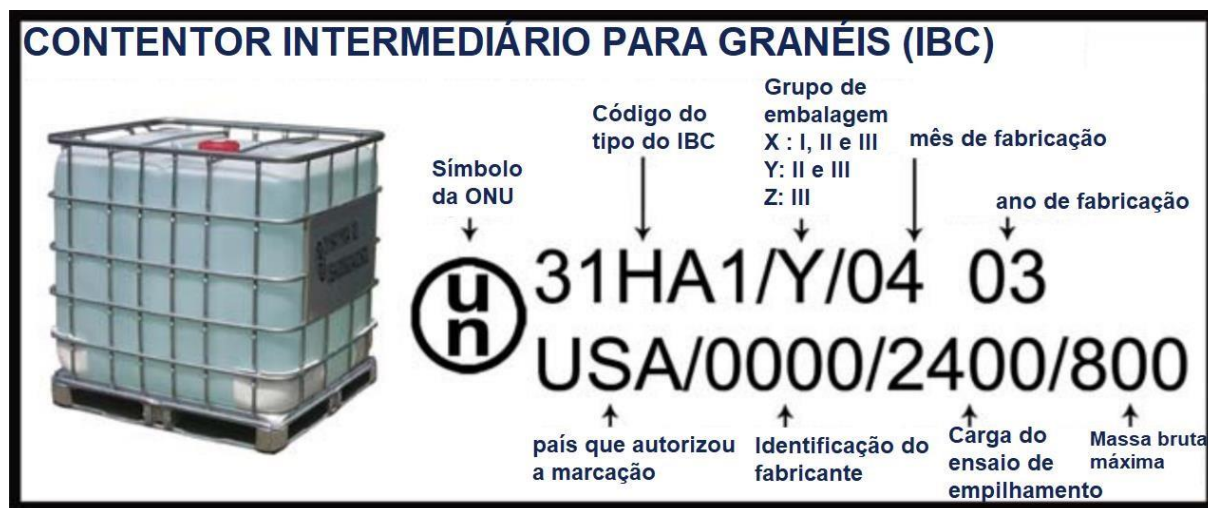
FIGURA 20 - Exemplo do significado das informações constantes na marcação ONU para IBCs
