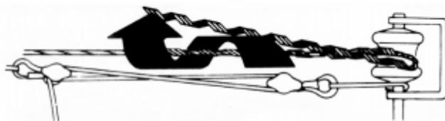
Figura 105: Instalação de alça pré-formada
