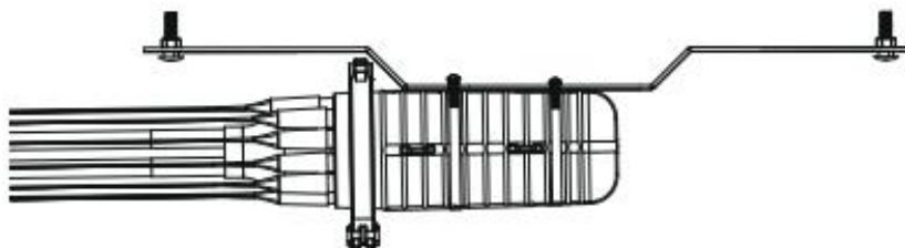
Figura 47: Fixação em caixa de passagem subterrânea através das presilhas da própria caixa de emenda
