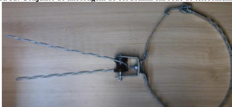
Figura 32: Conjunto de ancoragem de cordoalha em rede de telecomunicação
