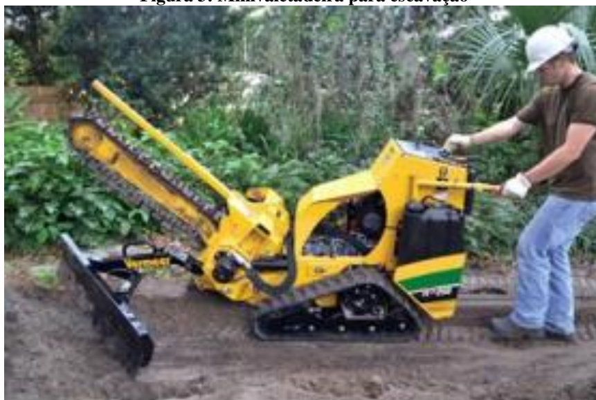
Figura 3: Minivaletadeira para escavação
