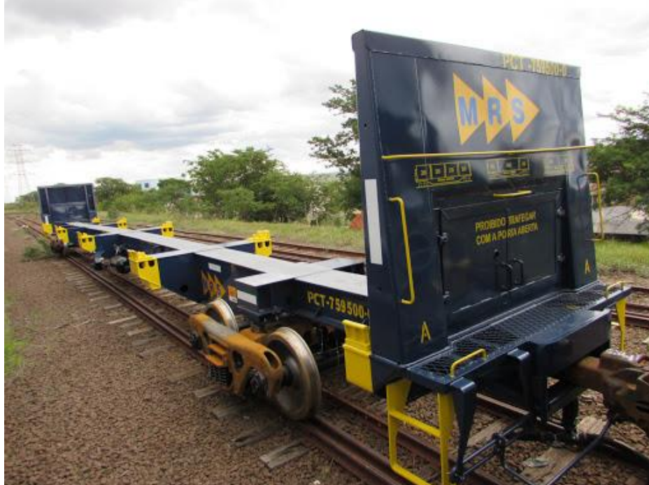
Figura 73: Vagão plataforma para transporte de contêineres, PCT, capacidade 98,5 t - Bitola Larga
