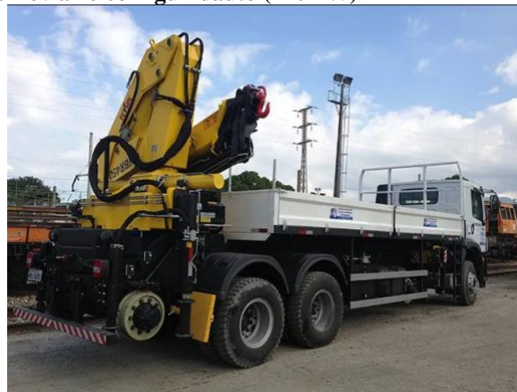
Figura 67: Caminhão de linha rodoferroviário com guindauto (110 kW)
