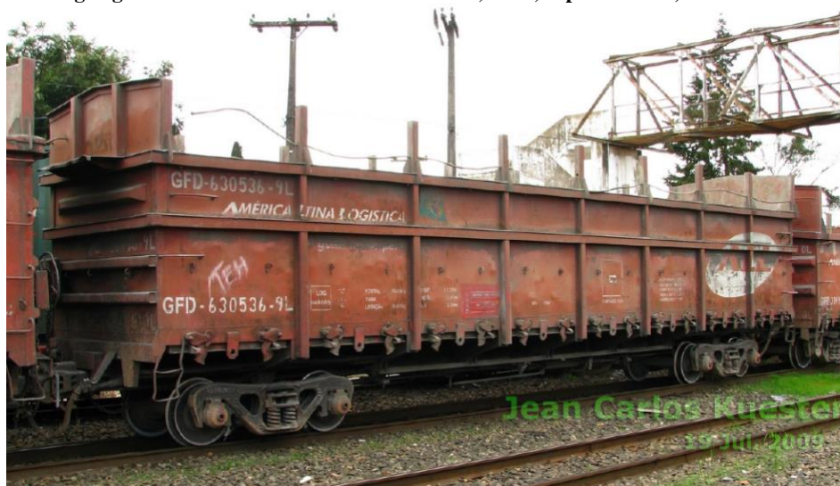
Figura 76: Vagão gôndola com bordas fixas e fundo móvel, GFD, capacidade 60,5 t / 60 m 3 - Bitola Métrica
