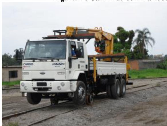
Figura 11: Caminhão de linha rodoferroviário com guindauto (110 kW)
