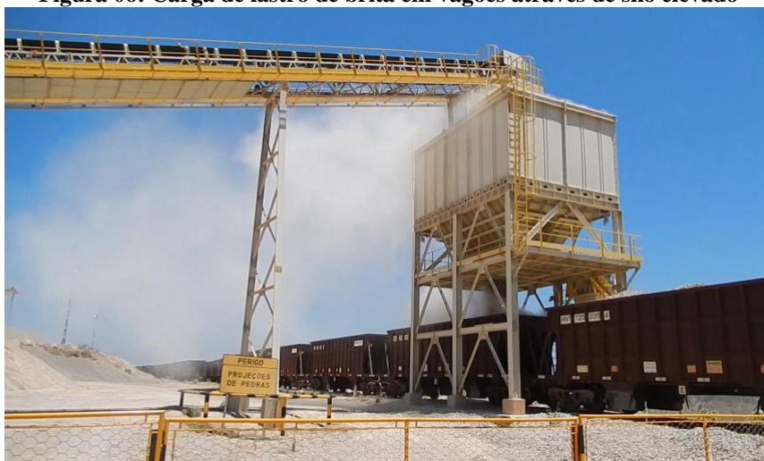
Figura 06: Carga de lastro de brita em vagões através de silo elevado
