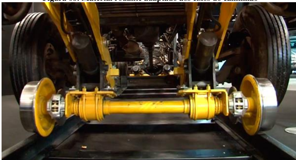
Figura 68: Material rodante adaptado aos eixos do caminhão
