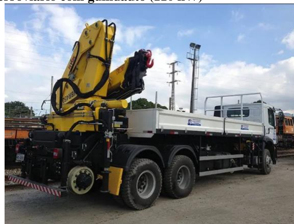
Figura 11: Caminhão de linha rodoferroviário com guindauto (110 kW)
