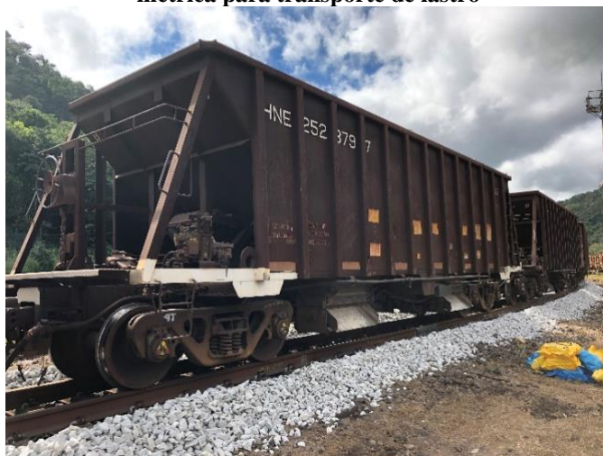
Figura 55: Vagão hopper aberto com descarga automática HNE com capacidade de 77 t / 45 m 3 - bitola métrica para transporte de lastro
