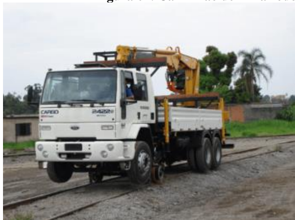
Figura 67: Caminhão de linha rodoferroviário com guindauto (110 kW)
