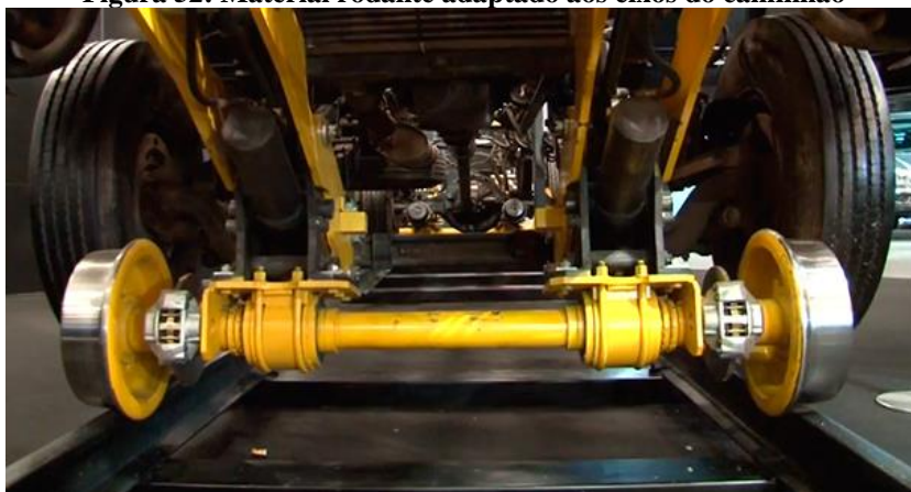
Figura 52: Material rodante adaptado aos eixos do caminhão
