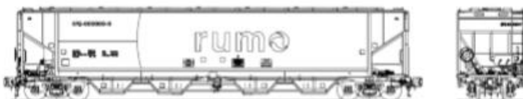
Figura 80: Vagão hopper fechado dotado de escotilha e tremonha, com descarga rápida, HPE, capacidade 77,5 t / 100 m 3 - Bitola Métrica
