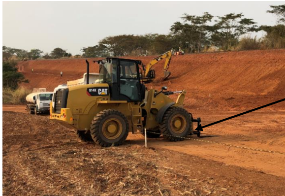
Figura 36: Carregadeira de pneus com uso de implemento de garfo para o transporte de paletes e cargas diversas em canteiro de obra ferroviária
