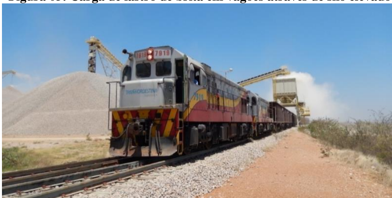
Figura 05: Carga de lastro de brita em vagões através de silo elevado
