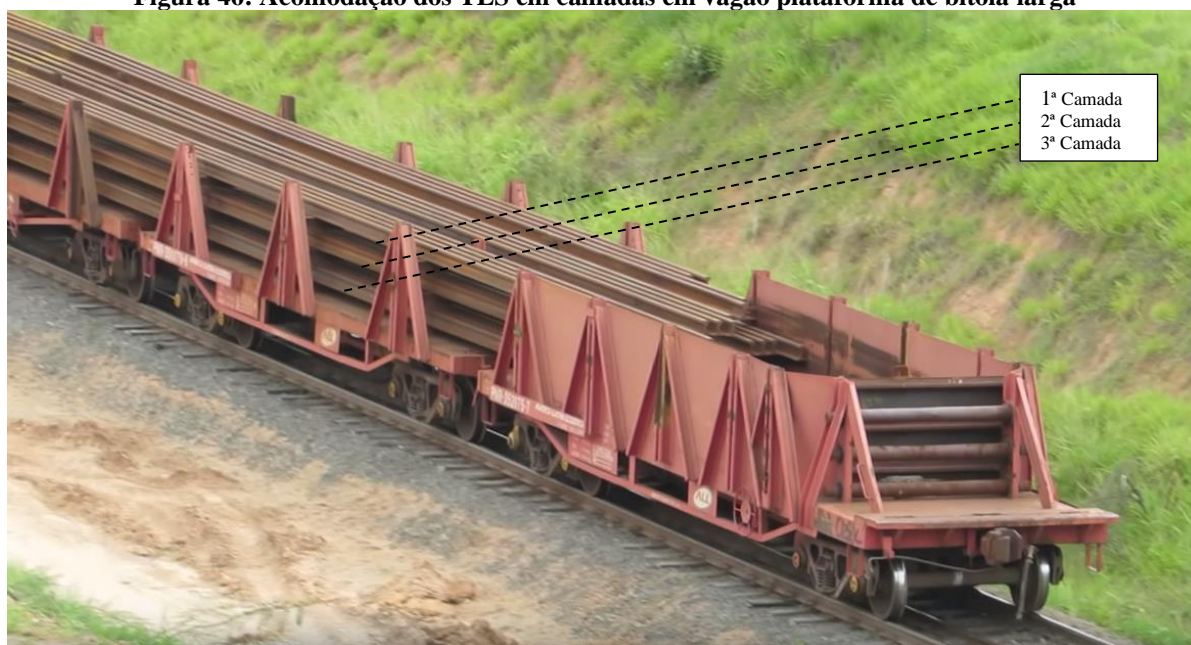
Figura 46: Acomodação dos TLS em camadas em vagão plataforma de bitola larga
