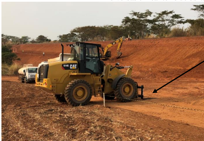
Figura 26: Carregadeira de pneus com uso de implemento de garfo para o transporte de paletes e cargas diversas em canteiro de obra ferroviária
