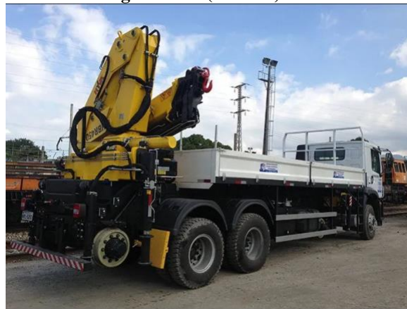
Figura 51: Caminhão de linha rodoferroviário com guindauto (110 kW)
