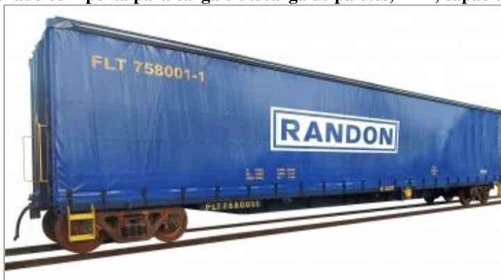
Figura 69: Vagão fechado com porta para carga e descarga de paletes, FLT, capacidade 99 t - bitola larga
