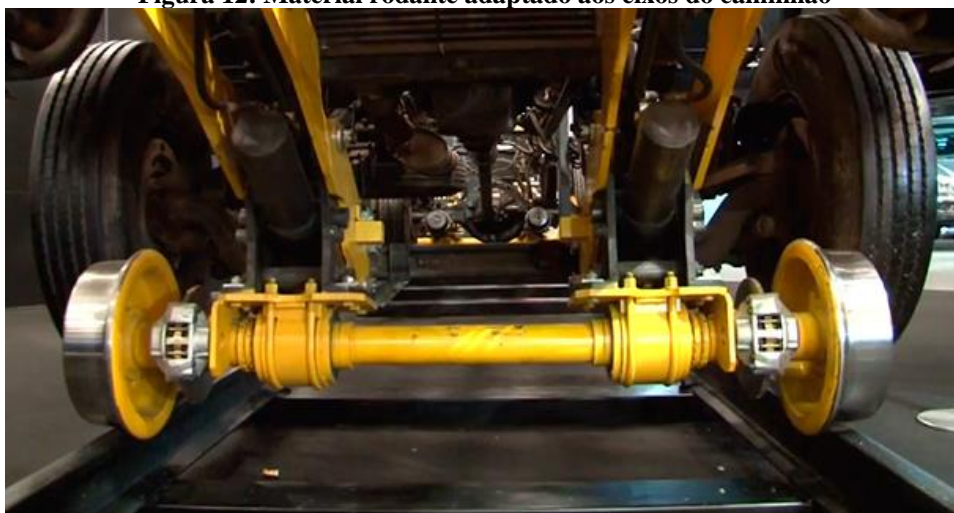
Figura 12: Material rodante adaptado aos eixos do caminhão
