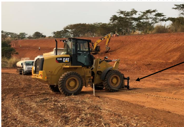
Figura 20: Carregadeira de pneus com uso de implemento de garfo para o transporte de paletes e cargas diversas em canteiro de obra ferroviária
