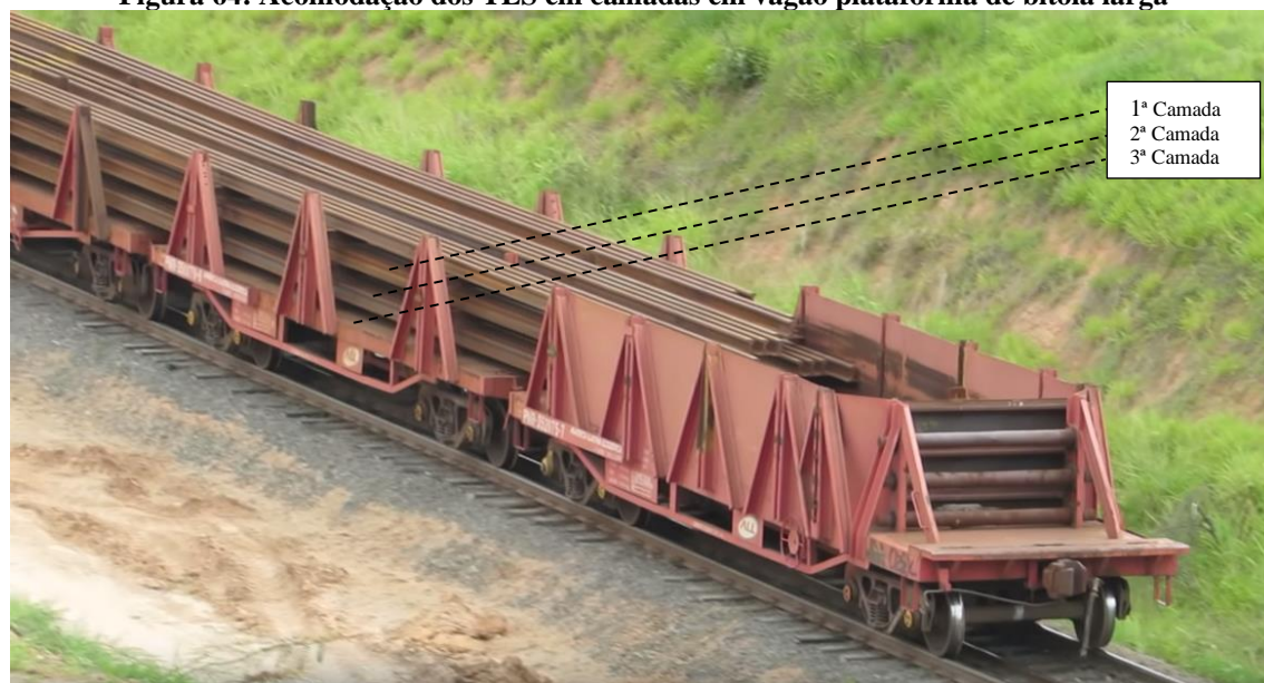
Figura 64: Acomodação dos TLS em camadas em vagão plataforma de bitola larga
