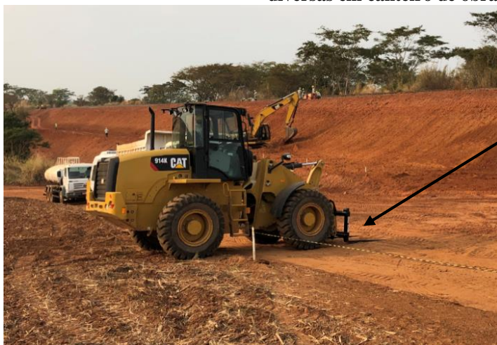
Figura 29: Carregadeira de pneus com uso de implemento de garfo para o transporte de paletes e cargas diversas em canteiro de obra ferroviária
