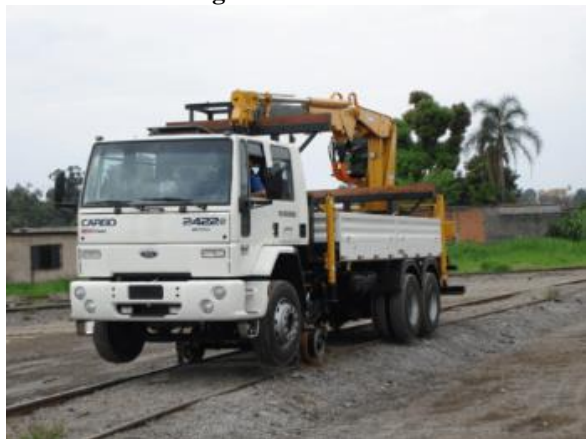
Figura 51: Caminhão de linha rodoferroviário com guindauto (110 kW)
