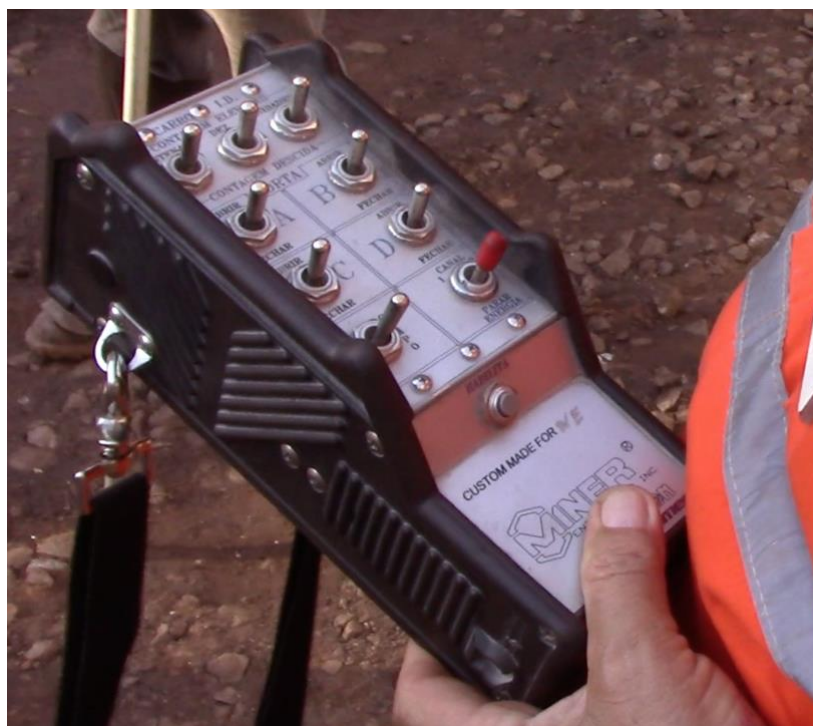
Figura 16: Controle remoto de abertura automática das tremonhas dos vagões
