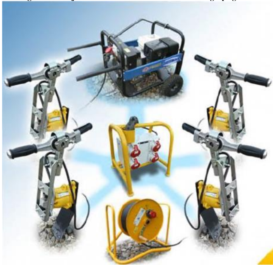
Figura 76: Conjunto de socaria manual com vibrador e grupo gerador
