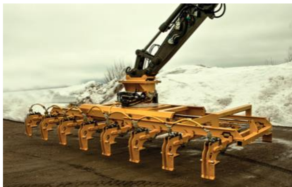
Figura 33: Implemento sleeper layer para a escavadeira
