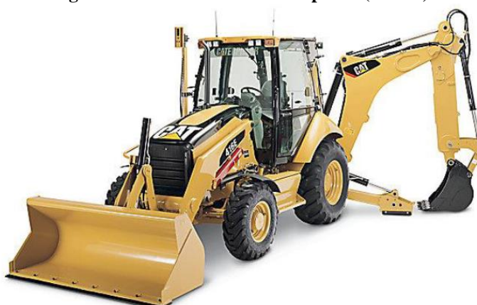
Figura 60: Retroescavadeira de pneus (58 kW)
