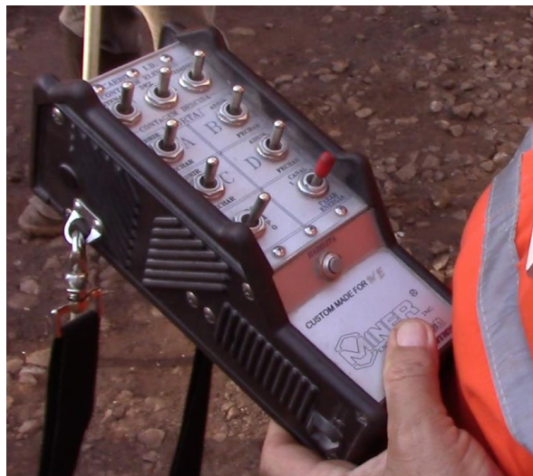
Figura 14: Controle remoto de abertura automática das tremonhas dos vagões
