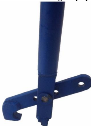
Figura 49: Extrator e insersor de grampo pandrol (maritaca)
