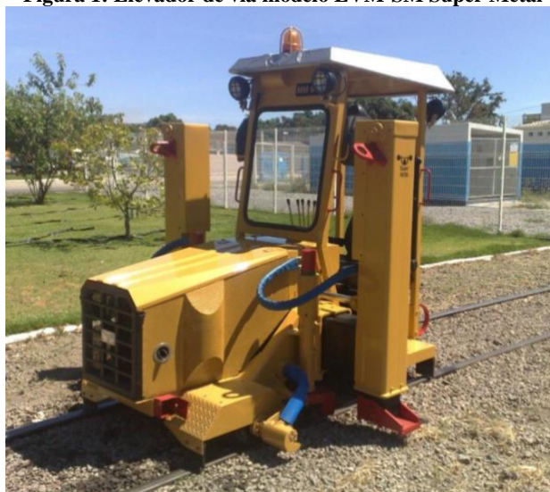
Figura 1: Elevador de via modelo EVM-SM Super Metal
