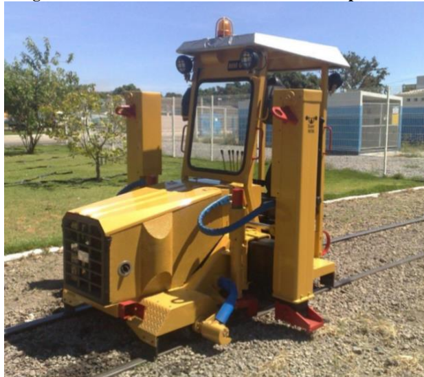
Figura 3: Elevador de via modelo EVM-SM Super Metal
