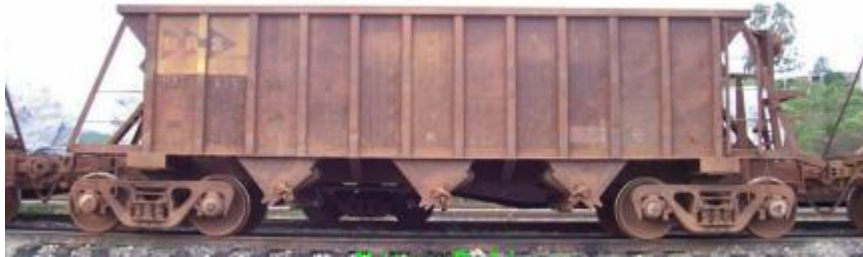
Figura 76: Vagão hopper aberto com descarga manual, HAT, capacidade de 103 t / 90 m 3 - Bitola Larga
