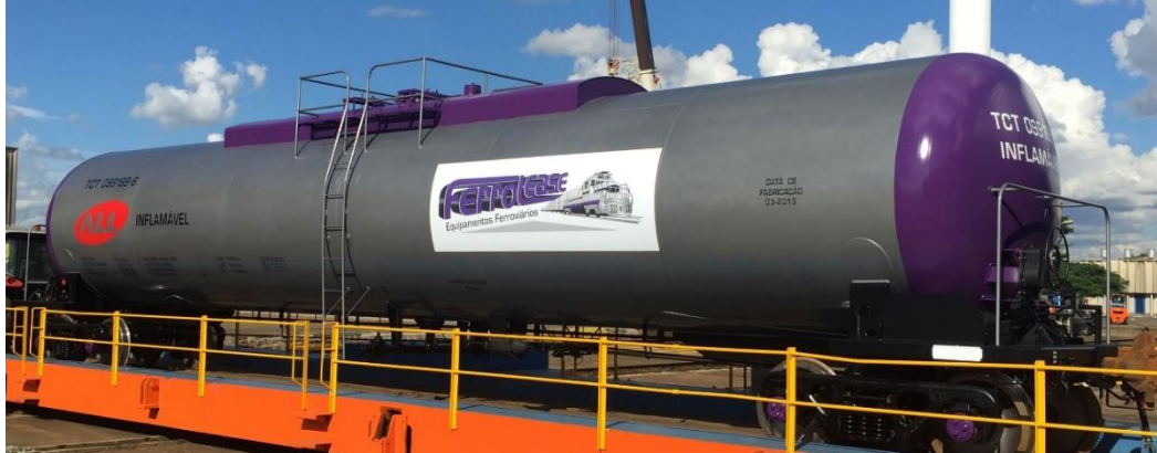
Figura 89: Vagão tanque para transporte de combustíveis, TCT, capacidade 87,5 t / 103 m 3 - Bitola Larga
