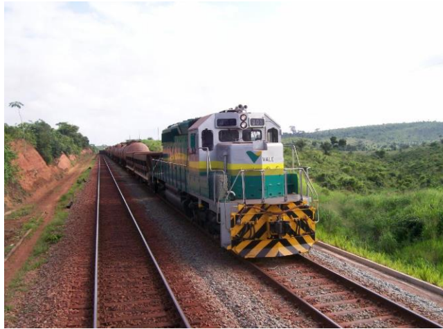
Figura 23: Locomotiva diesel-elétrica AC (3206 kW / 4300 HP) – bitola métrica
