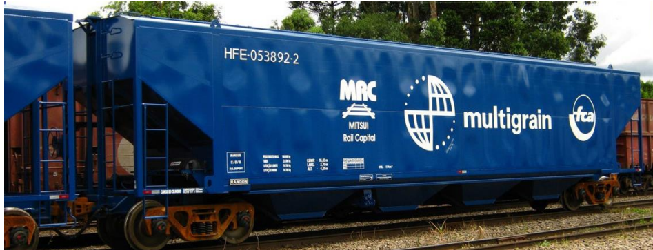
Figura 77: Vagão hopper fechado dotado de escotilha e tremonha, com descarga rápida, HFE, capacidade 77 t / 107 m 3 - Bitola Métrica
