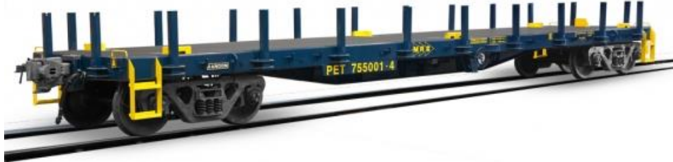
Figura 85: Vagão plataforma para transporte de contêineres, PDT, capacidade 95 t – Bitola Larga
