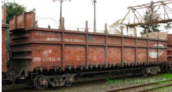
Figura 70: Vagão gôndola com bordas fixas e fundo móvel, GFD, capacidade de 60,5 t / 60 m 3 - Bitola Métrica
