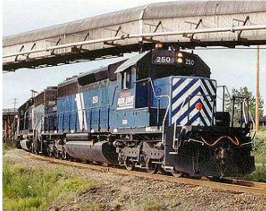
Figura 26: Locomotiva diesel-elétrica CC (2237 kW / 3000 HP) – bitola métrica
