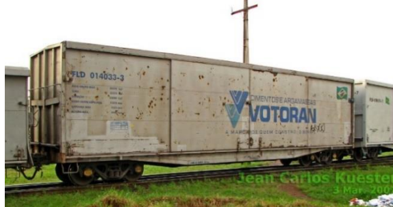
Figura 66: Vagão fechado com porta para carga e descarga de paletes, FLD, capacidade 64 t – Bitola Métrica
