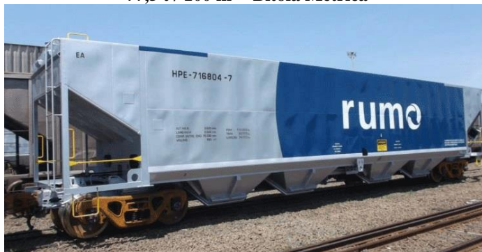
Figura 79: Vagão hopper fechado dotado de escotilha e tremonha, com descarga rápida, HPE, capacidade 77,5 t / 100 m 3 - Bitola Métrica
