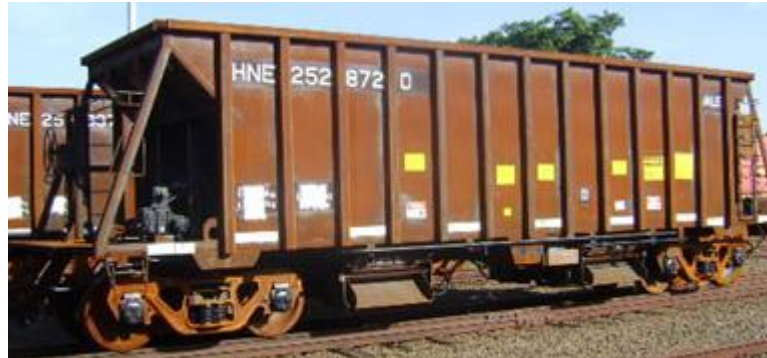
Figura 73: Vagão hopper aberto com descarga automática, HNE, capacidade de 77 t / 45 m 3 - Bitola Métrica
