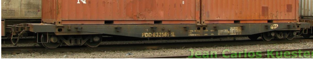
Figura 83: Vagão plataforma para transporte de contêineres, PDD, capacidade 64 t – Bitola Métrica
