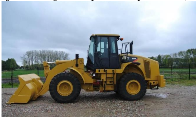
Figura 7: Carregadeira de pneus com capacidade de 3,4 m 3
