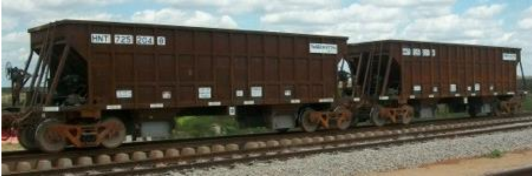
Figura 74: Vagão hopper aberto com descarga automática, HNT, capacidade de 103 t / 63 m 3 - Bitola Larga
