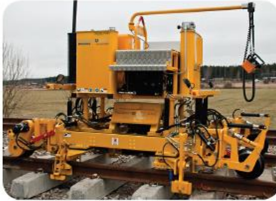
Figura 29: Máquina de aplicação e extração de grampo elástico tipo deenik
