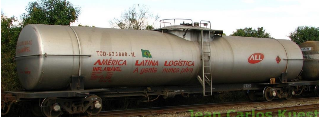
Figura 88: Vagão tanque para transporte de combustíveis, TCD, capacidade 55 t / 66 m 3 - Bitola Métrica
