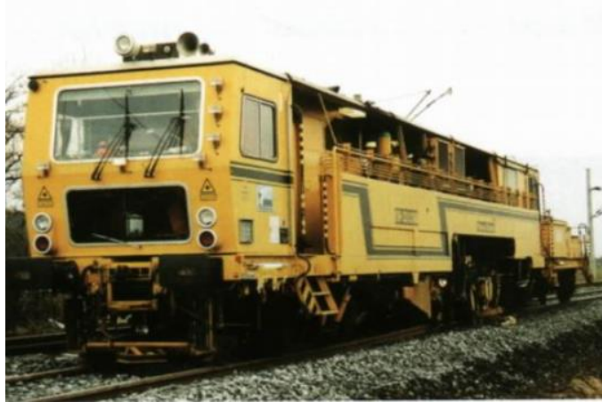
Figura 60: Socadora automática de linha (253 kW)
