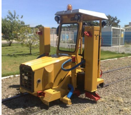
Figura 39: Máquina elevadora de via
