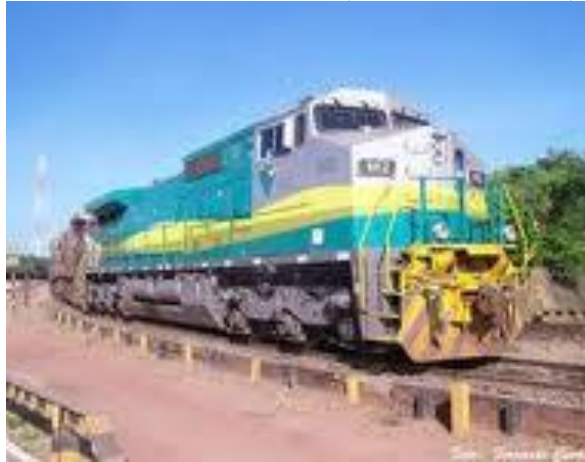
Figura 25: Locomotiva diesel-elétrica CC (3281 kW / 4400 HP) – bitola larga
