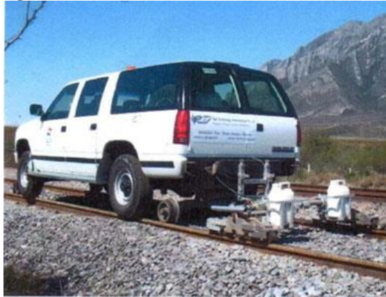
Figura 94: Veículo Rodoferroviário com ultrassom
