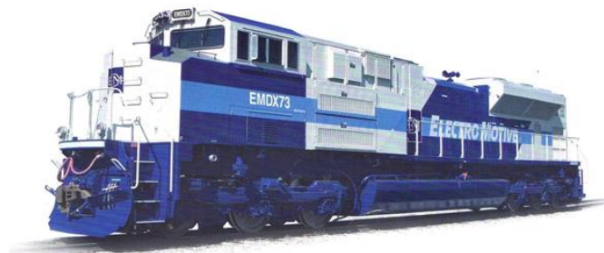
Figura 21: Locomotiva diesel-elétrica AC (3243 kW / 4350 HP) – bitola larga
