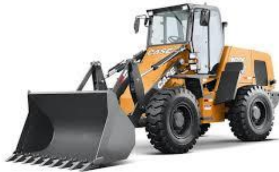
Figura 6: Carregadeira de pneus com capacidade de 1,72 m 3
