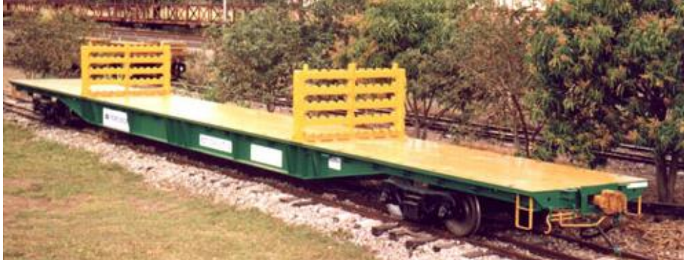
Figura 84: Vagão plataforma para transporte de contêineres, PDT, capacidade 95 t – Bitola Larga
