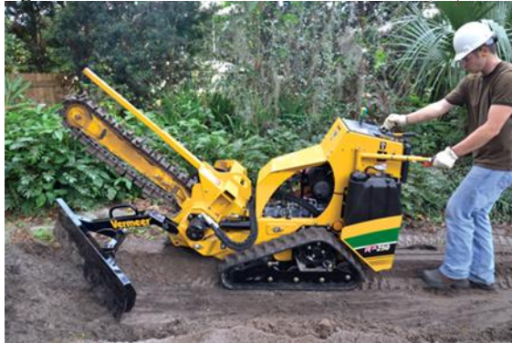
Figura 49: Minivaletadeira sobre esteira (18,6 kW)
