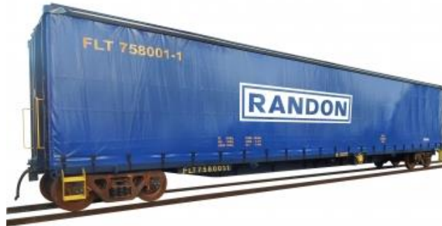
Figura 67: Vagão fechado com porta para carga e descarga de paletes, FLT, capacidade 99 t – Bitola Larga
