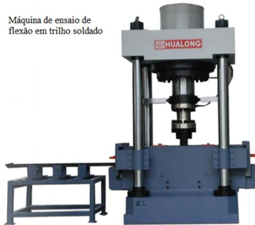
Figura 32: Máquina de ensaio de flexão estática em trilho
