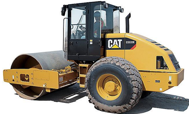
Figura 58: Rolo compactador liso autopropelido vibratório
