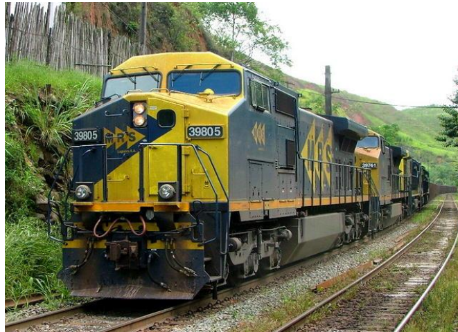
Figura 22: Locomotiva diesel-elétrica AC (3266 kW /4380 HP) – bitola larga
