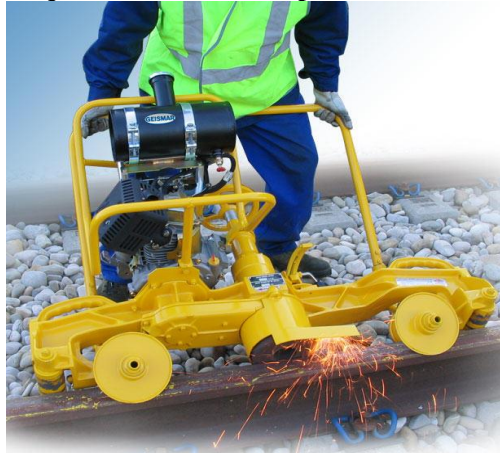
Figura 33: Máquina de esmerilhar topo e lateral de boleto (5,2 kW)
