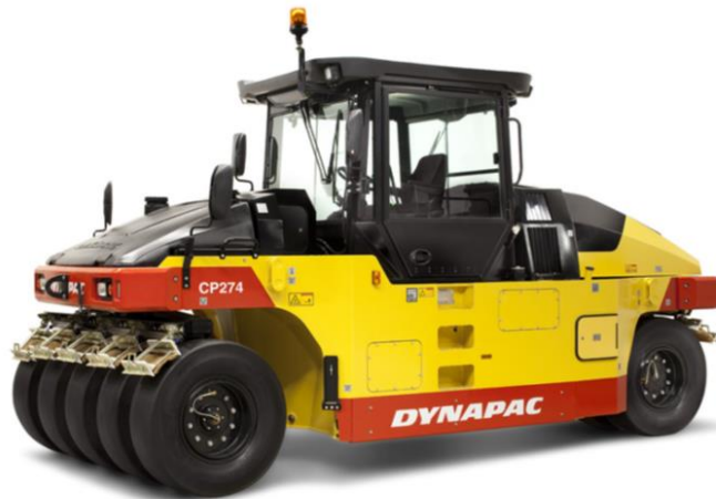
Figura 57: Rolo compactador de pneus autopropelido
