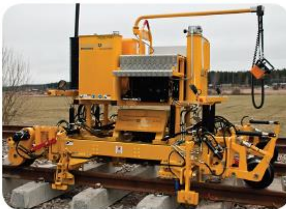
Figura 31: Máquina de aplicação e extração de grampo elástico tipo pandrol
