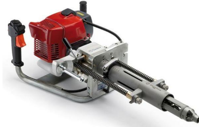
Figura 35: Máquina de furar dormente portátil (1,5 kW)
