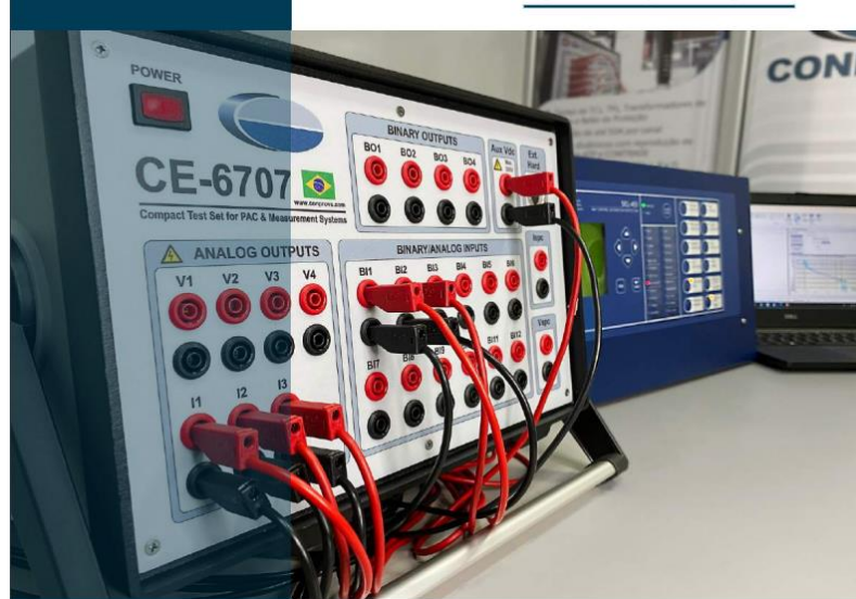
Figura 27: Mala de teste compacta para proteção, automação e controle
