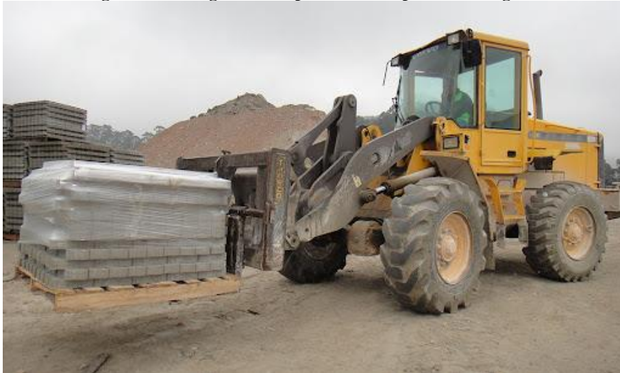
Figura 8: Carregadeira de pneus com implemento de garfo
