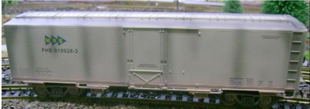
Figura 69: Vagão fechado dotado de escotilha e tremonha, FHS, capacidade 72,8 t / 103 m 3 - Bitola Larga
