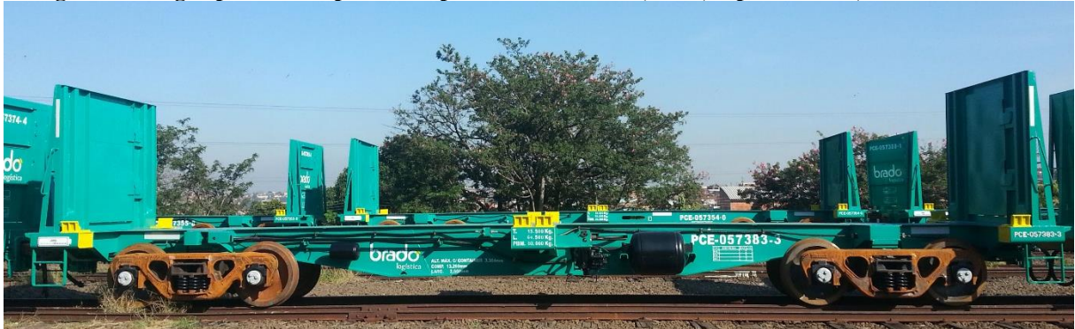
Figura 81: Vagão plataforma para transporte de contêineres, PCE, capacidade 81,5 – Bitola Métrica
