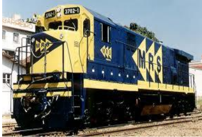
Figura 24: Locomotiva diesel-elétrica CC (2237 kW) – bitola larga
