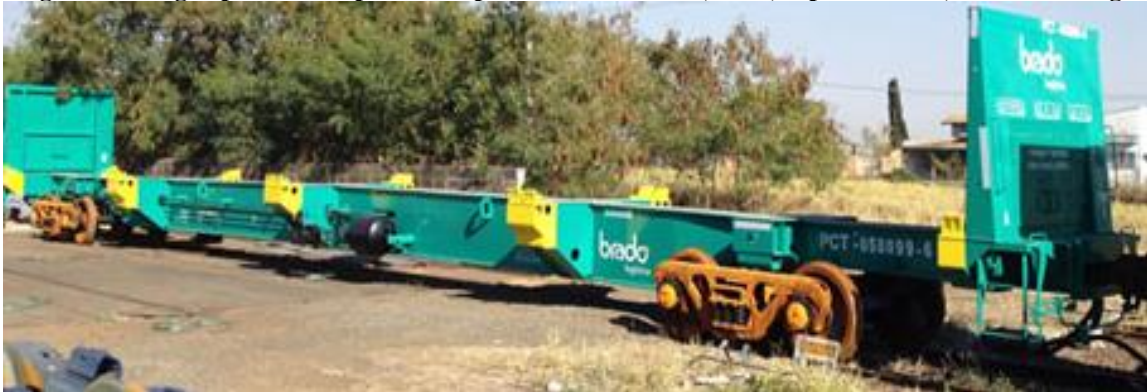
Figura 82: Vagão plataforma para transporte de contêineres, PCT, capacidade 98,5 – Bitola Larga
