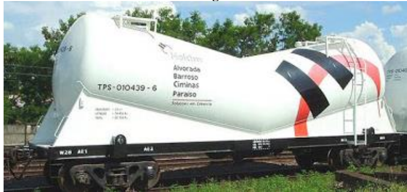
Figura 91: Vagão tanque para transporte de produtos pulverulentos, TPS, capacidade 75 t / 65 m 3 - Bitola Larga
