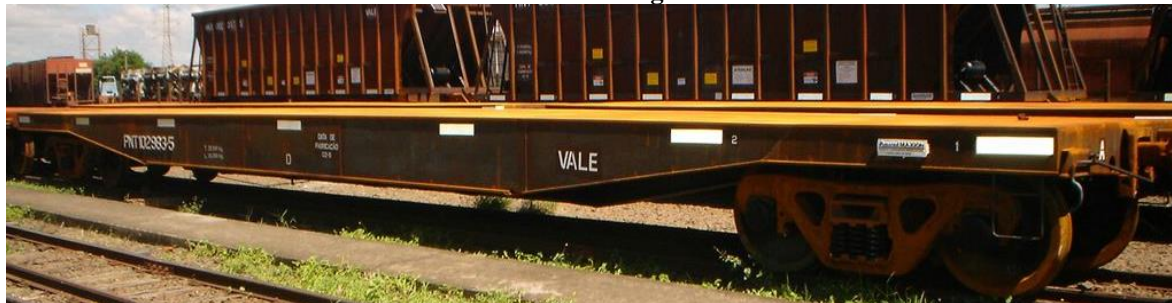
Figura 87: Vagão plataforma para transporte de materiais de via permanente, PNT, capacidade 98 t – Bitola Larga
