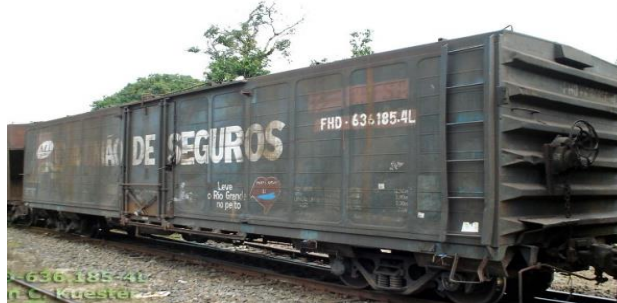
Figura 68: Vagão fechado dotado de escotilha e tremonha, FHD, capacidade 59 t / 73 m 3 - Bitola Métrica
