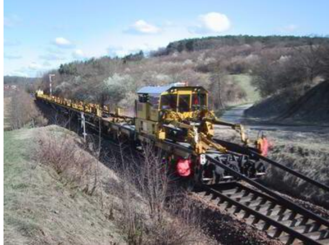
Figura 13: Equipamento auxiliar para carga e descarga de TLS
