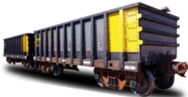
Figura 72: Vagão gôndola para descarga em car dumper, GDT, capacidade de 110 t / 45 m 3 - Bitola Larga
