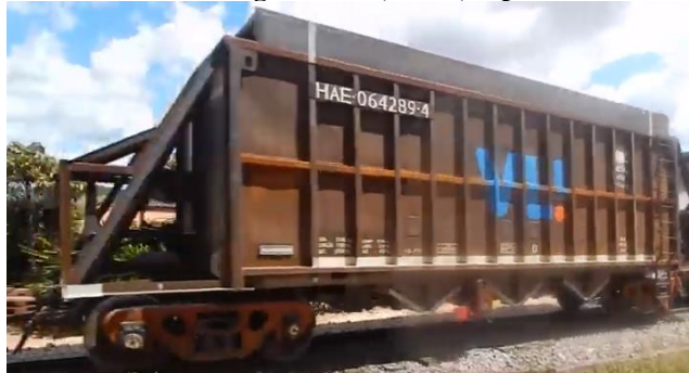
Figura 75: Vagão hopper aberto com descarga manual, HAE, capacidade de 77 t / 45 m 3 - Bitola Métrica
