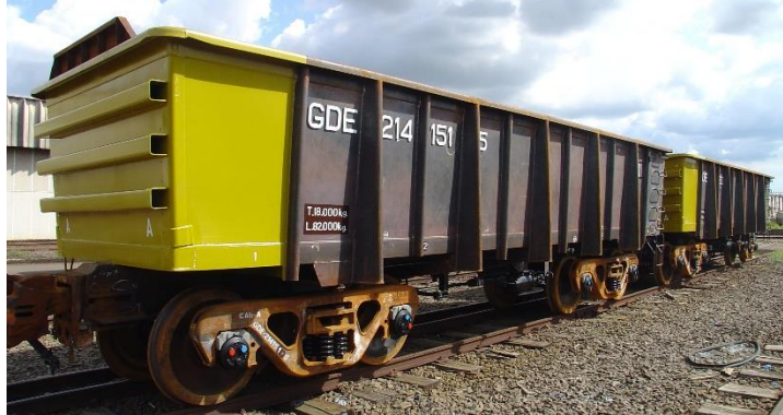
Figura 71: Vagão gôndola para descarga em car dumper, GDE, capacidade 93,5 t / 28 m 3 - Bitola Métrica
