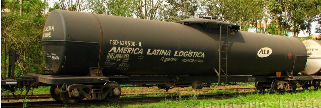
Figura 90: Vagão tanque para transporte de produtos com aquecimento para descarga, TSD, capacidade 55,3 t / 60 m 3 - Bitola Métrica
