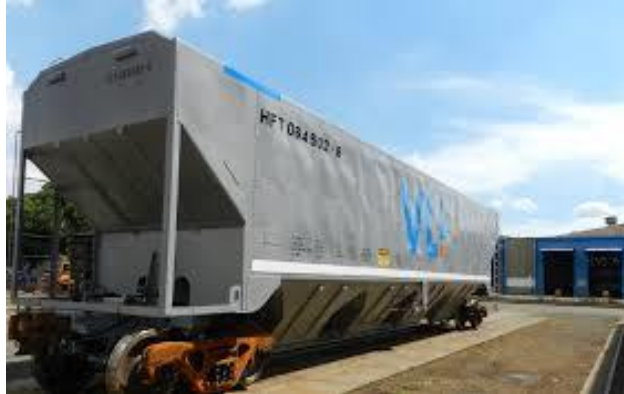
Figura 78: Vagão hopper fechado dotado de escotilha e tremonha, com descarga rápida, HFT, capacidade 90 t / 149 m 3 - Bitola Larga
