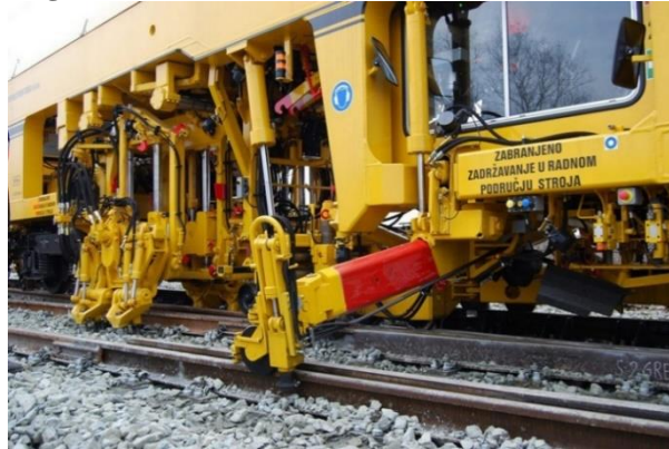
Figura 59: Socadora automática de chave (370 kW)
