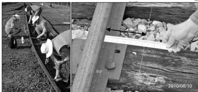
Figura 20 - Desalinhamento de curva em 10 metros
