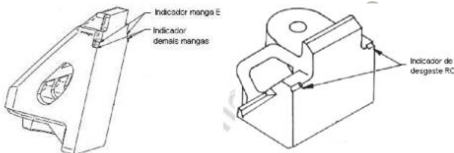
Figura 26 - Indicativa de desgaste da cunha Barber e Ride Control para condição de rejeito
