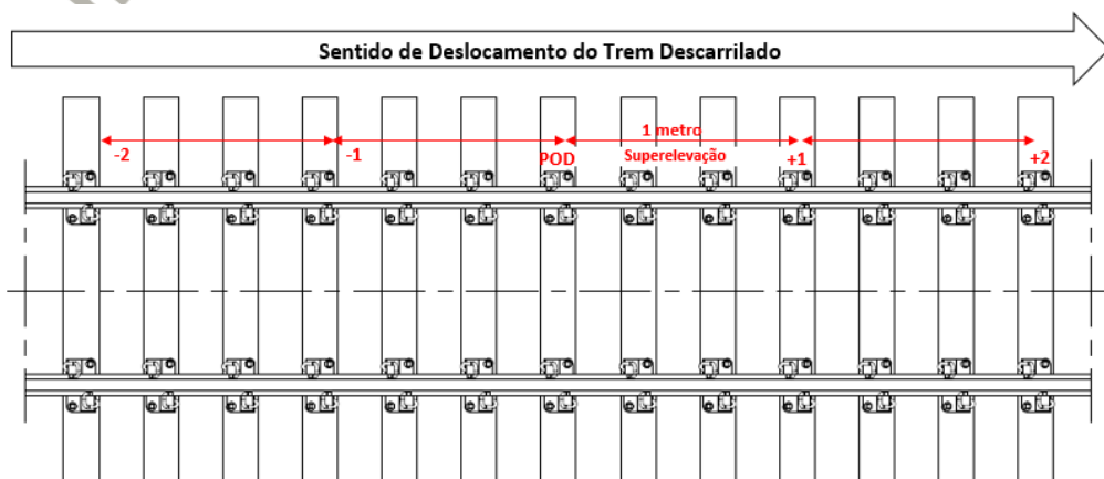
Figura 31 – Medidas de superelevação
