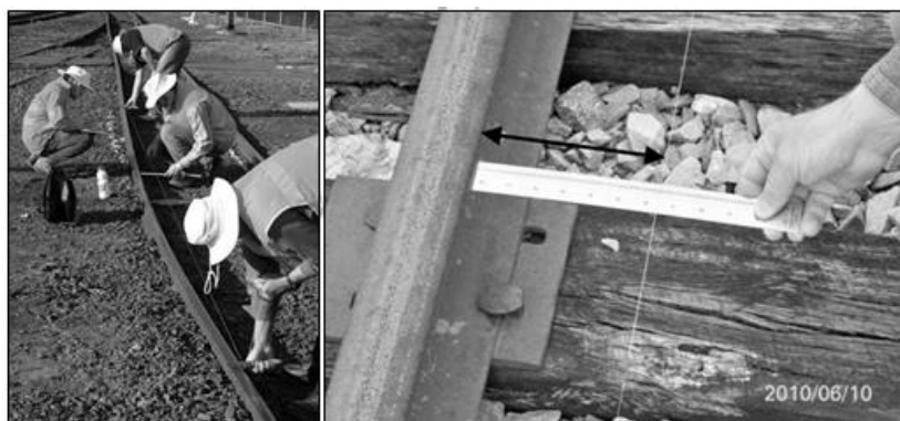
Figura 25 – Desalinhamento de curva em 10 metros
