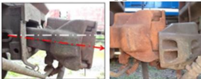
Figura 27 – Engates desnivelados e com diferença de alturas
