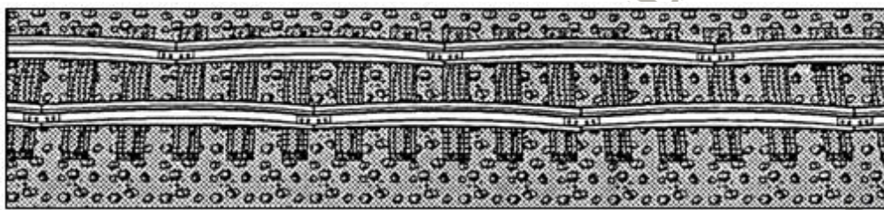
Figura 32 – Desnivelamento periódico ou sequencial na superelevação
