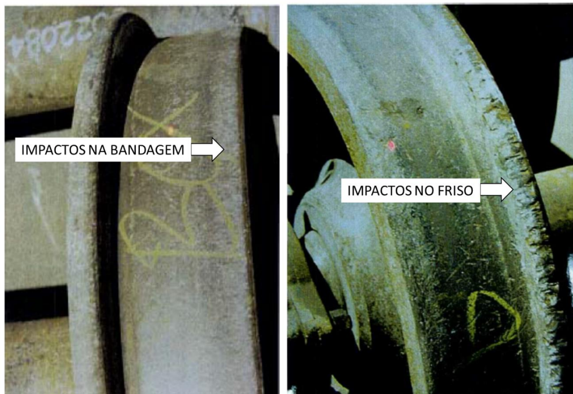
Figura 10 - Fotos de marcações de rodas acidentadas
