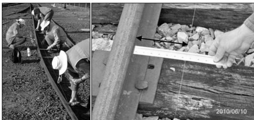
Figura 34 – Desalinhamento de curva em 20 metros
