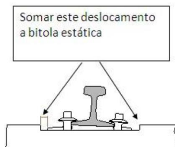
Figura 35 - Exemplo de deslocamento dinâmico da bitola
