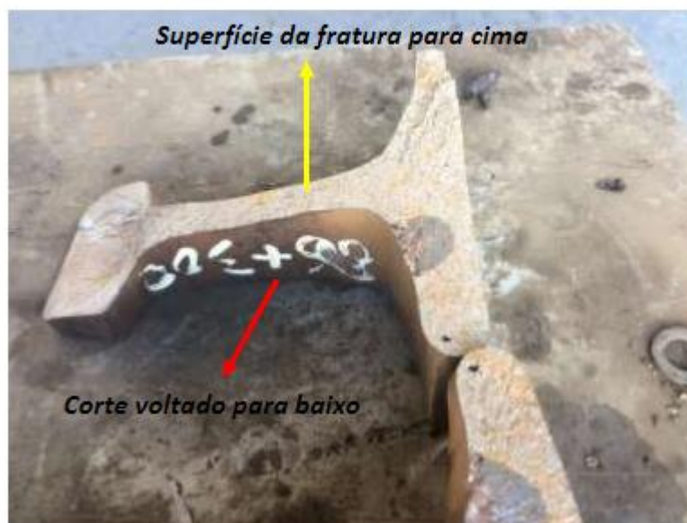
Figura 40 – Posicionamento da amostra fraturada
