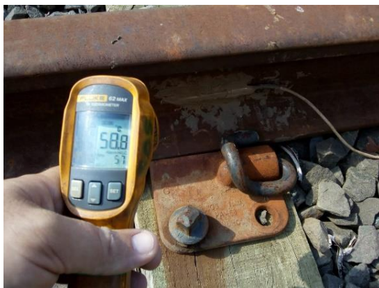
Figura 62 – Aferição do termômetro de via
