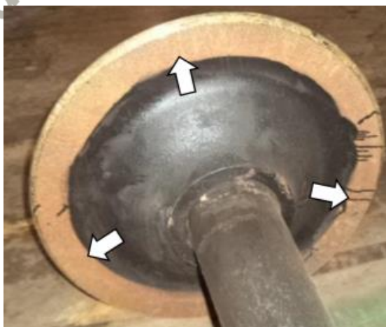
Figura 17 - Três medições equidistantes no rodeiro
