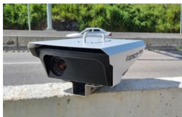
Figura 4: VDX - Aparelho que permite a detecção e leitura das placas
