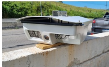
Figura 4: VDX - Aparelho que permite a detecção e leitura das placas
