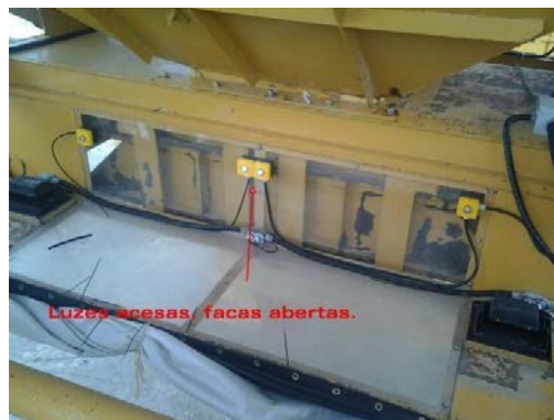
Figuras 6 e 7 - Luzes indicativas colocadas no interior da moega, vistas pelas câmeras
