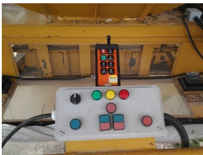
Figura 1 - Painel antigo e novo controle integrados
