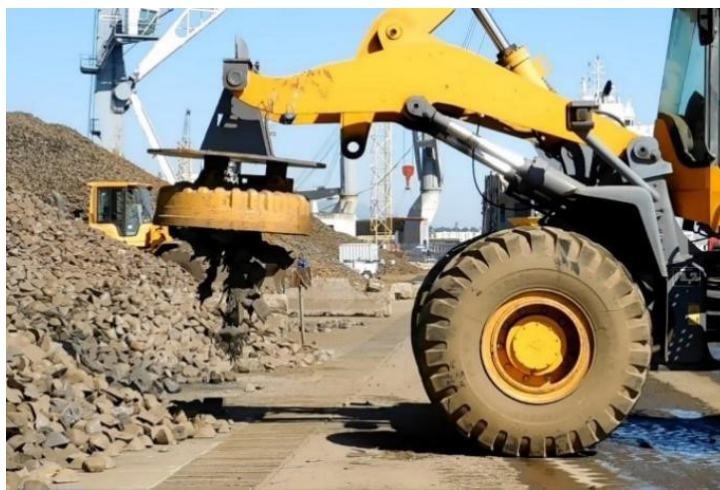
Foto 4 - Recolhimento magnético de pedras e cascalhos de ferro.
