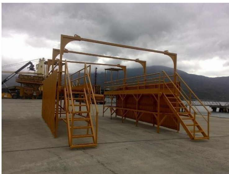
Figura 19 - Passarela de enlonar caminhões após reforma.
