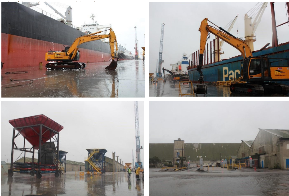
Figura 42: Equipamentos do Porto Novo: pá-escavadeira, escavadeira com grab, tremonhas, balança
