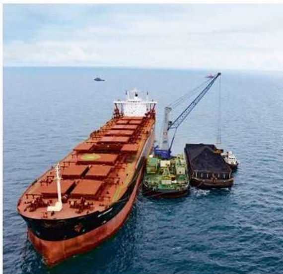
Figura 1 — Transbordo flutuante direto típico [Typical direct floating transshipment]
