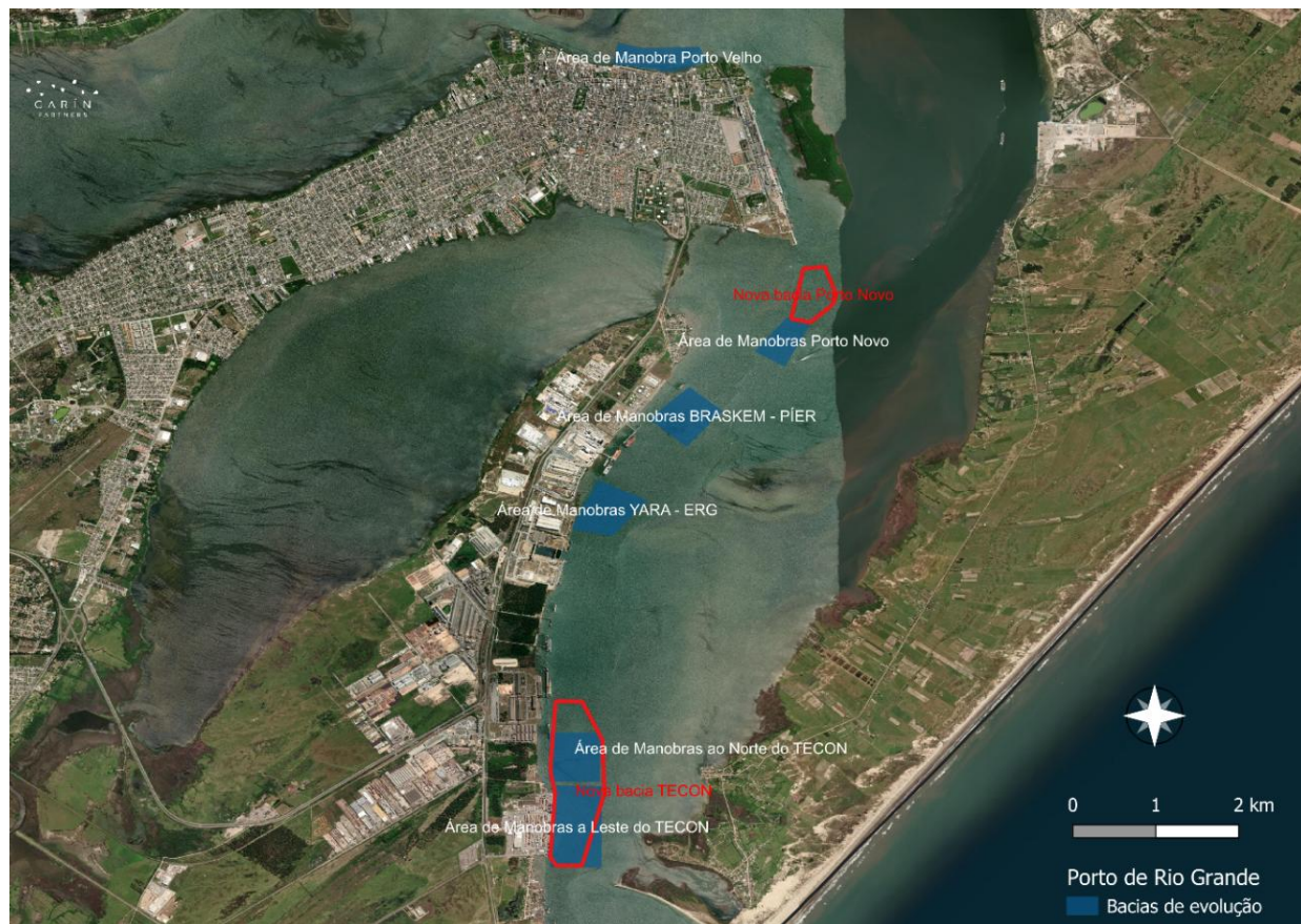
Figura 4 – Nova geometria para as bacias de manobra do Porto Novo e Tecon. Fonte: Norma nº 23, de 30 de maio de 2023 – Portos RS
