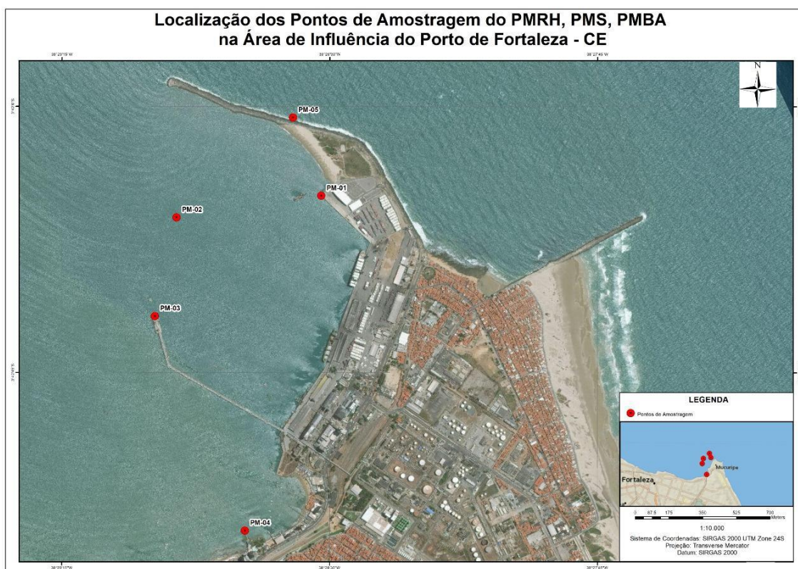
Figura 14 – Pontos de monitoramento de água já executados pelo Porto de Fortaleza
